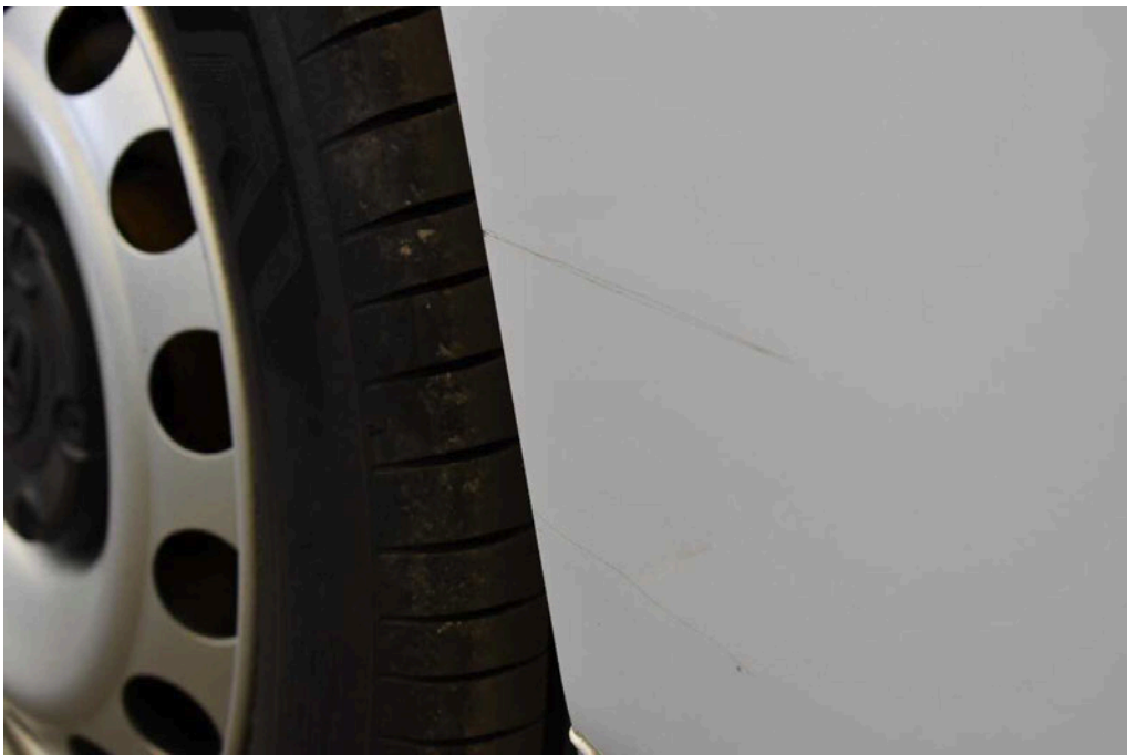
Bild 24 rechte Seite Seitenwand hinten rechts Kratzer/Dellen
