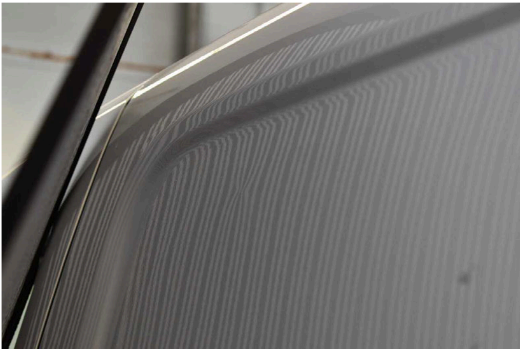
Bild 18 linke Seite Seitenwand links 1 Delle > 20 mm und 1 Beule > 20 mm
