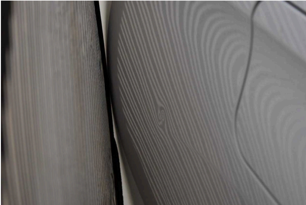
Bild 17 linke Seite Seitenwand links 1 Delle > 20 mm und 1 Beule > 20 mm
