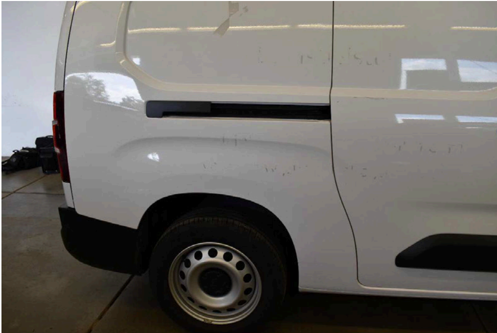
Bild 21 rechte Seite Seitenwand hinten rechts Kratzer/Dellen
