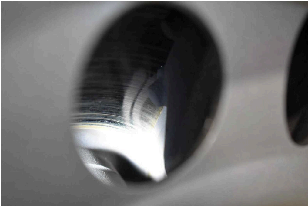
Bild 33 Vorderachse Bremsscheiben+Bremssklötze verschlissen
