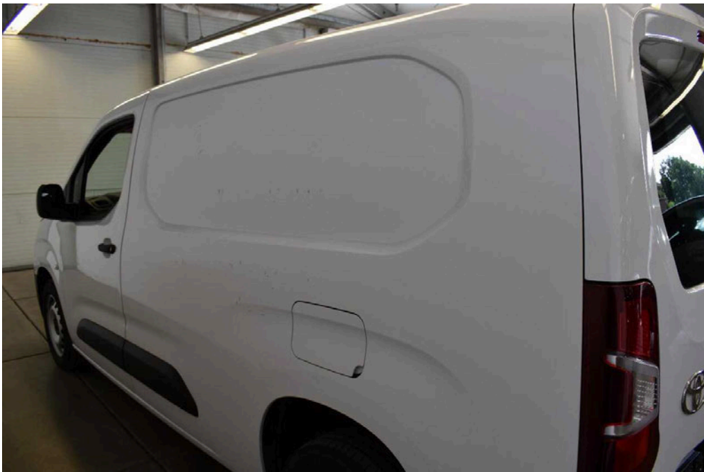
Bild 16 linke Seite Seitenwand links 1 Delle > 20 mm und 1 Beule > 20 mm
