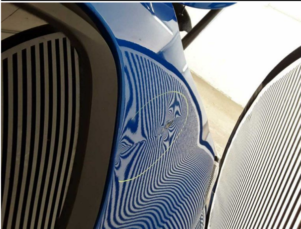
Beschädigung #10: Seitenwand links: Seitenwand - Delle / Lackschaden - erneuern
