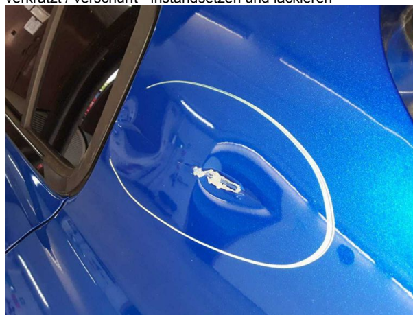
Beschädigung #10: Seitenwand links: Seitenwand - Delle / Lackschaden - erneuern
