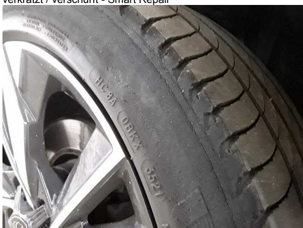
Beschädigung #7: Rad/Reifen: Reifen vorn - porös / rissig - erneuern
