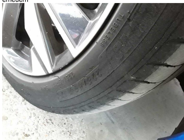
Beschädigung #7: Rad/Reifen: Reifen vorn - porös / rissig - erneuern
