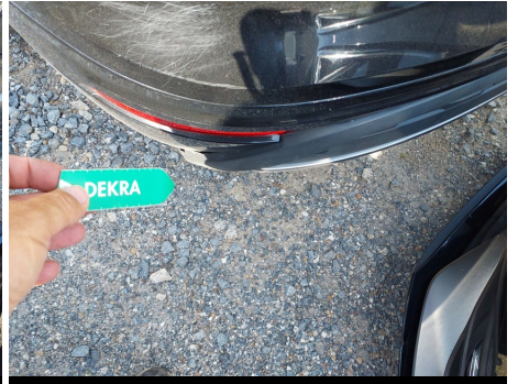
Spoiler / Trasero / Abolladura
