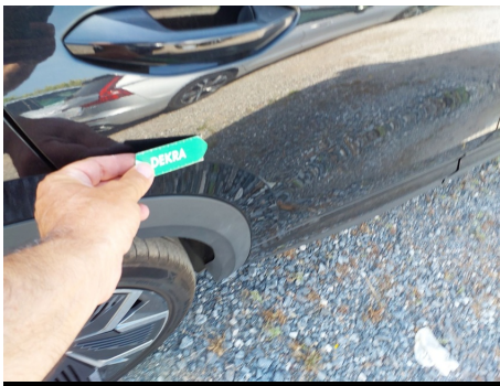
Puerta / Trasero Derecho / Abolladura
