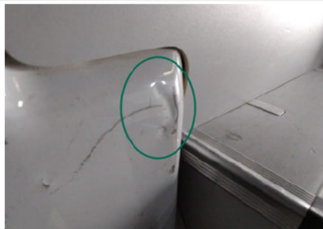
Säule / Innenraum Rechts / Delle
