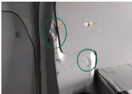
Säule / Innenraum Rechts / Delle
