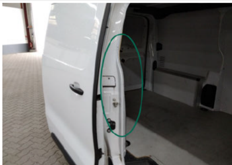
Dichtung Türeinstieg / Rechts / Fehlt
