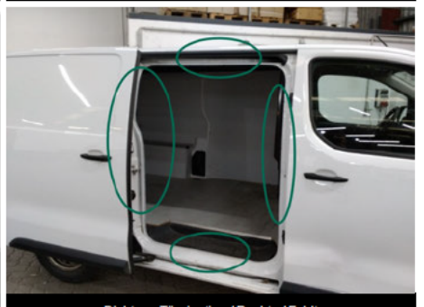
Dichtung Türeinstieg / Rechts / Fehlt
