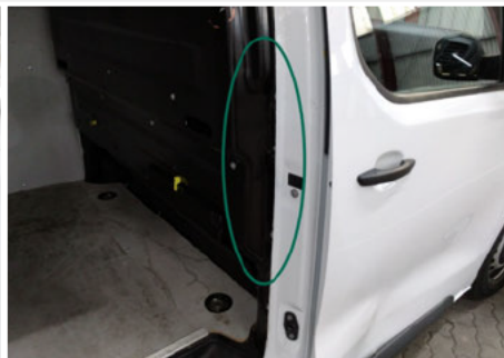
Dichtung Türeinstieg / Rechts / Fehlt
