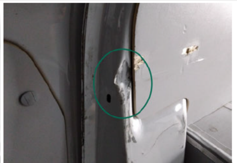
Säule / Innenraum Rechts / Delle
