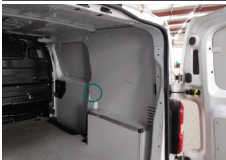
Innenverkleidung Laderaum / Rechts / Gebrochen
