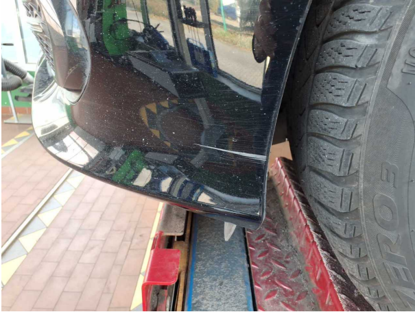
Beschädigung #6: Stossfänger vorn: Stossfänger vorn (inkl. Zierleisten, Kühlergrill und Parksensoren erneuern) - Delle /
