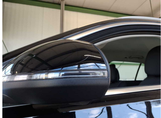
Beschädigung #1: Außenspiegel links: Abdeckkappe - verkratzt / verschürft - Smart Repair
