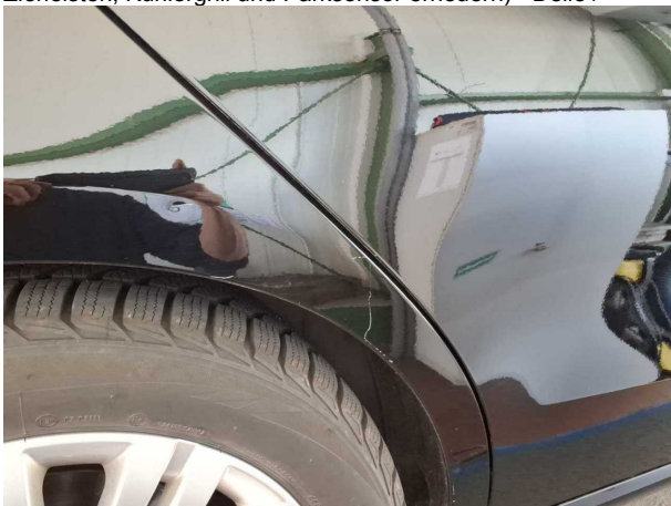
Beschädigung #7: Seitenwand rechts: Seitenwand - Delle / Lackschaden - instandsetzen und lackieren
