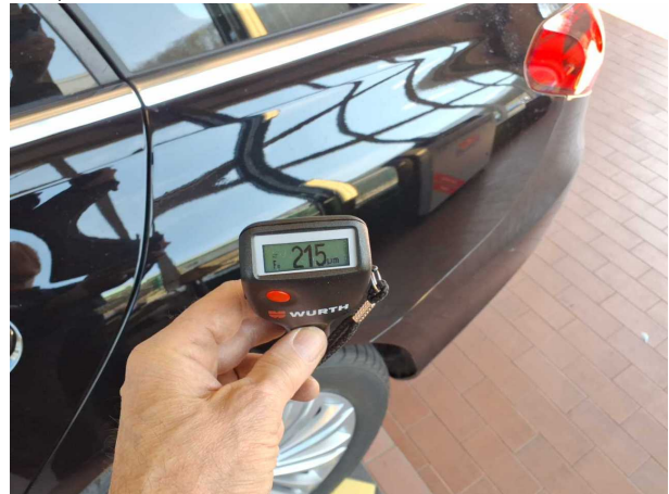
Nachlackierung 1: Kotflügel links, Seitenwand links, Tür hint... links, Tür vorne links
