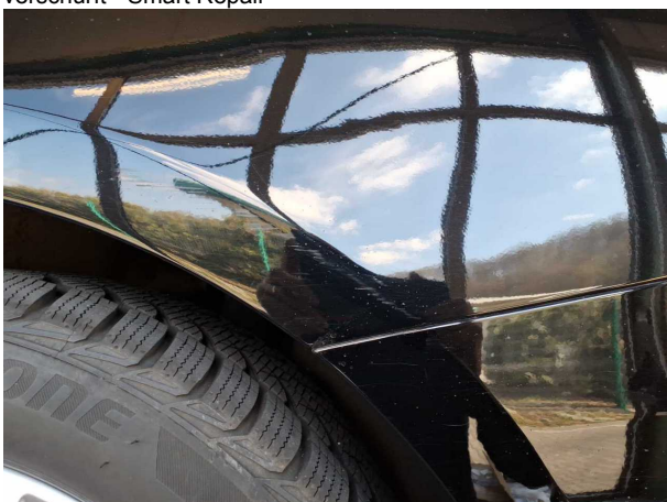
Beschädigung #2: Seitenwand links: Seitenwand - verkratzt / verschürft - Smart Repair
