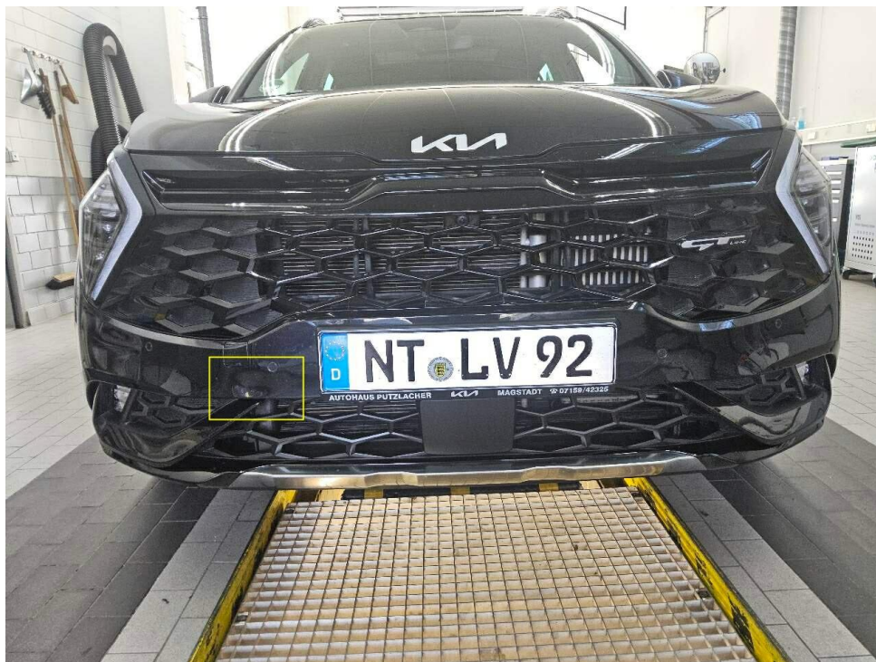
Bild 6 : Stoßfänger vorne, eingedellt, instandsetzen und lackieren mit Lackaufbau
