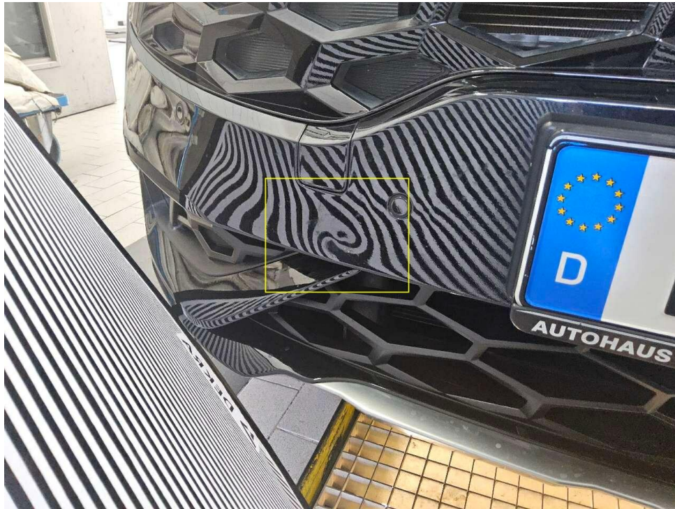
Bild 7 : Stoßfänger vorne, eingedellt, instandsetzen und lackieren mit Lackaufbau
