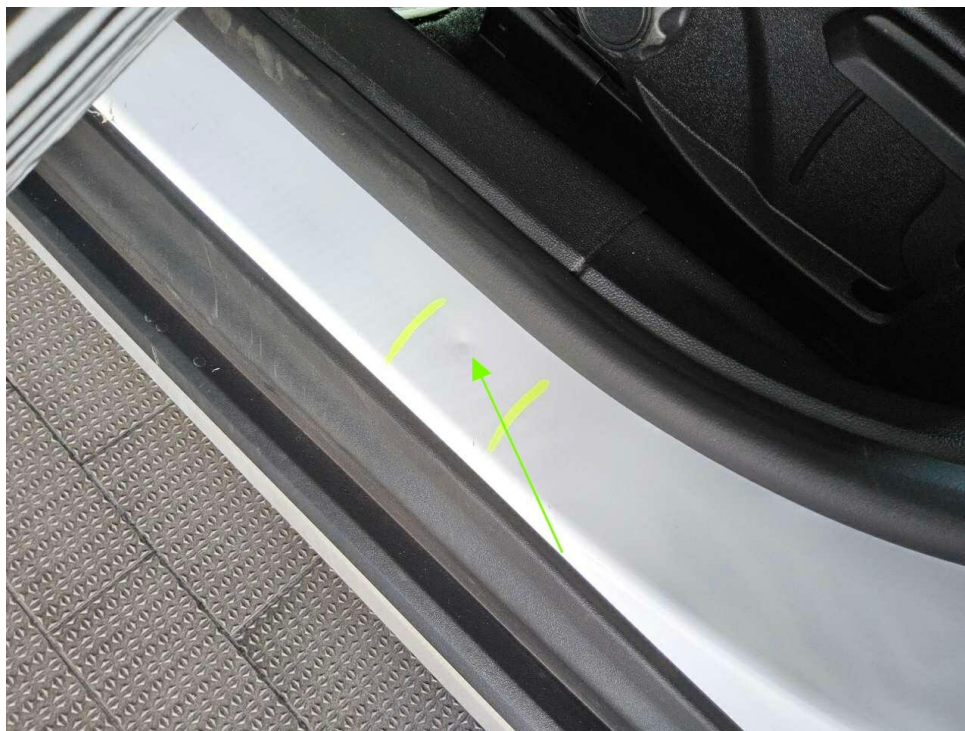
Bild 14 : Tür vorne links Einstieg, eingedellt, smart repair
