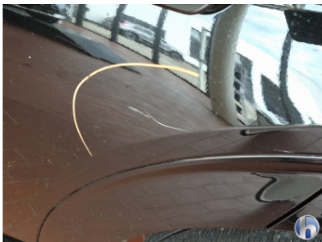
5. Tür Hinten - Links Beschädigt - Instandsetzen und Lackieren
