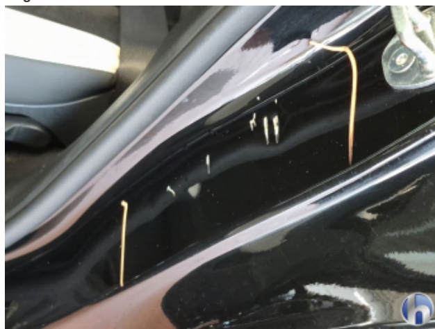
4. Türeinstieg Hinten - Links Beschädigt - Smart Repair
