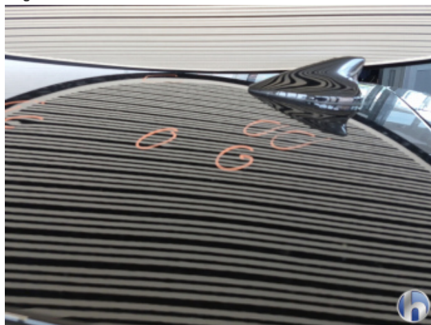
3. Dach Hagelschaden - Siehe Kalkulation
