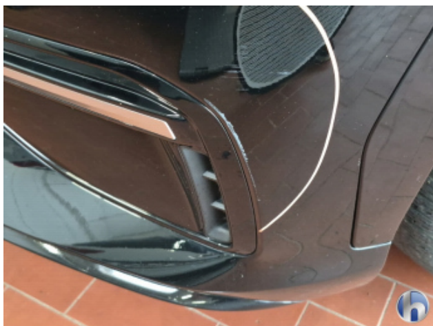
7. Stoßfänger Vorne Abschürfung - Smart Repair
