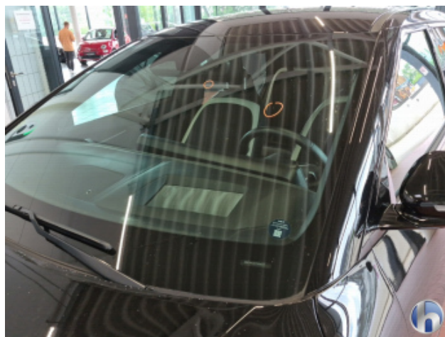
9. Windschutzscheibe Steinschlag - Smart Repair
