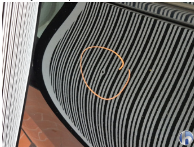
5. Tür Hinten - Links Beschädigt - Instandsetzen und Lackieren
