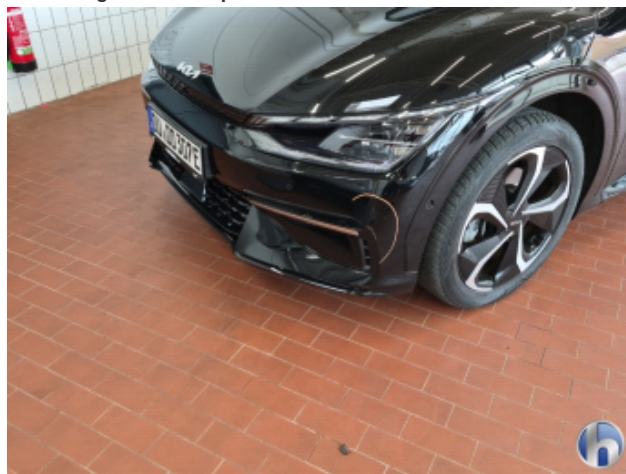
7. Stoßfänger Vorne Abschürfung - Smart Repair
