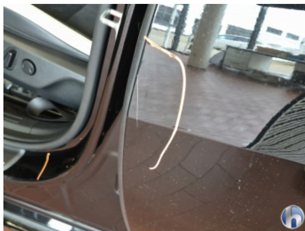
5. Tür Hinten - Links Beschädigt - Instandsetzen und Lackieren
