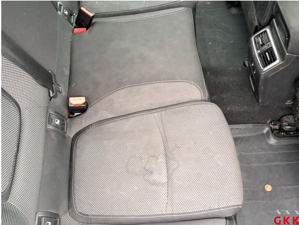
Bild 21. Sitzbank hinten, Bezug Sitzkissen -Stoff-, verschmutzt, reinigen
