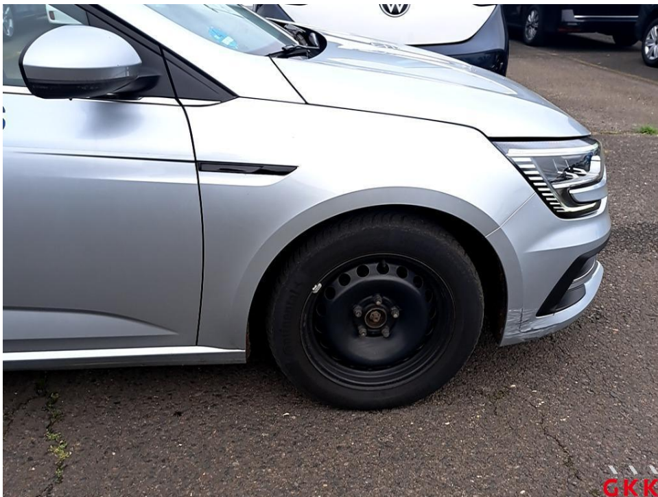
Bild 26. Kotflügel vorne rechts, beschädigt, ersetzen
