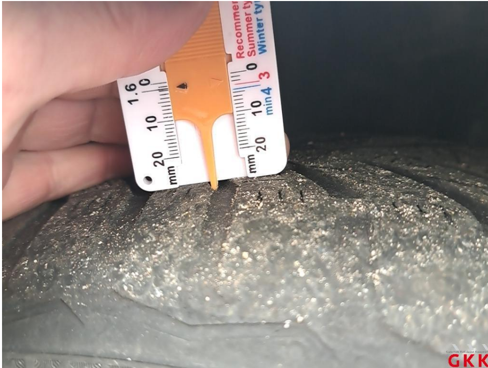
Bild 13. Reifen, vorn links und rechts, Untermaß, ersetzen
