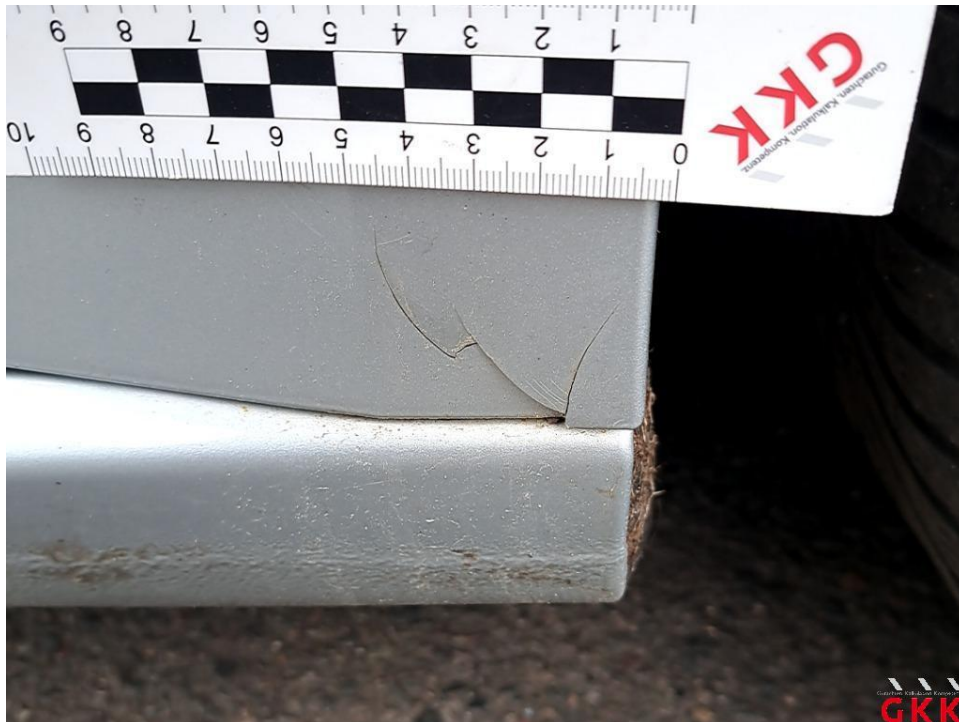
Bild 27. Kotflügel vorne rechts, beschädigt, ersetzen
