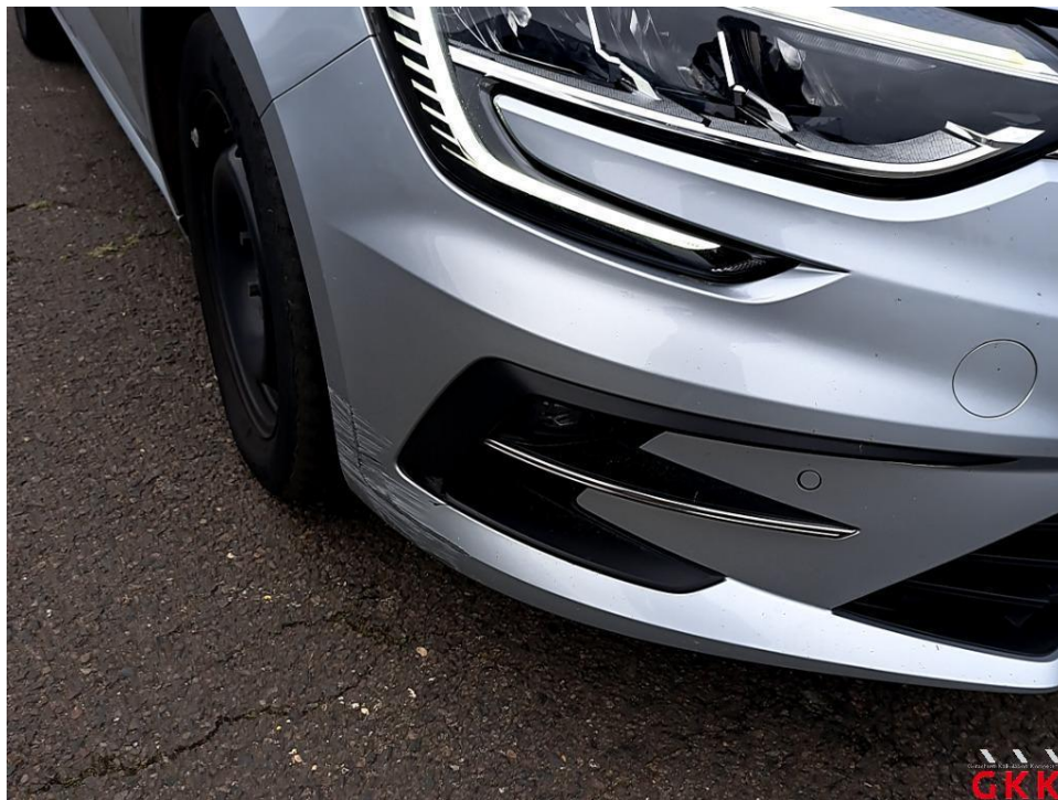
Bild 16. Stoßfänger vorne, Blende -unlackiert-, verkratzt, ersetzen
