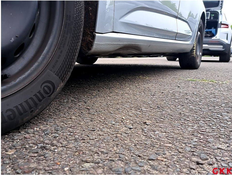
Bild 29. Schweller links, beschädigt, instand setzen - lackieren
