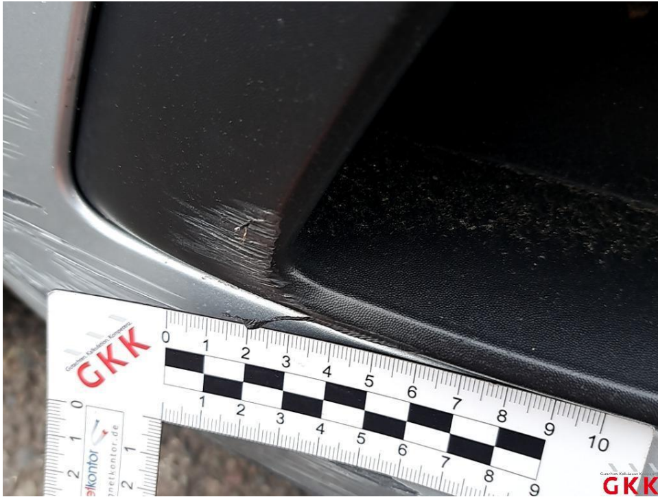
Bild 17. Stoßfänger vorne, Blende -unlackiert-, verkratzt, ersetzen
