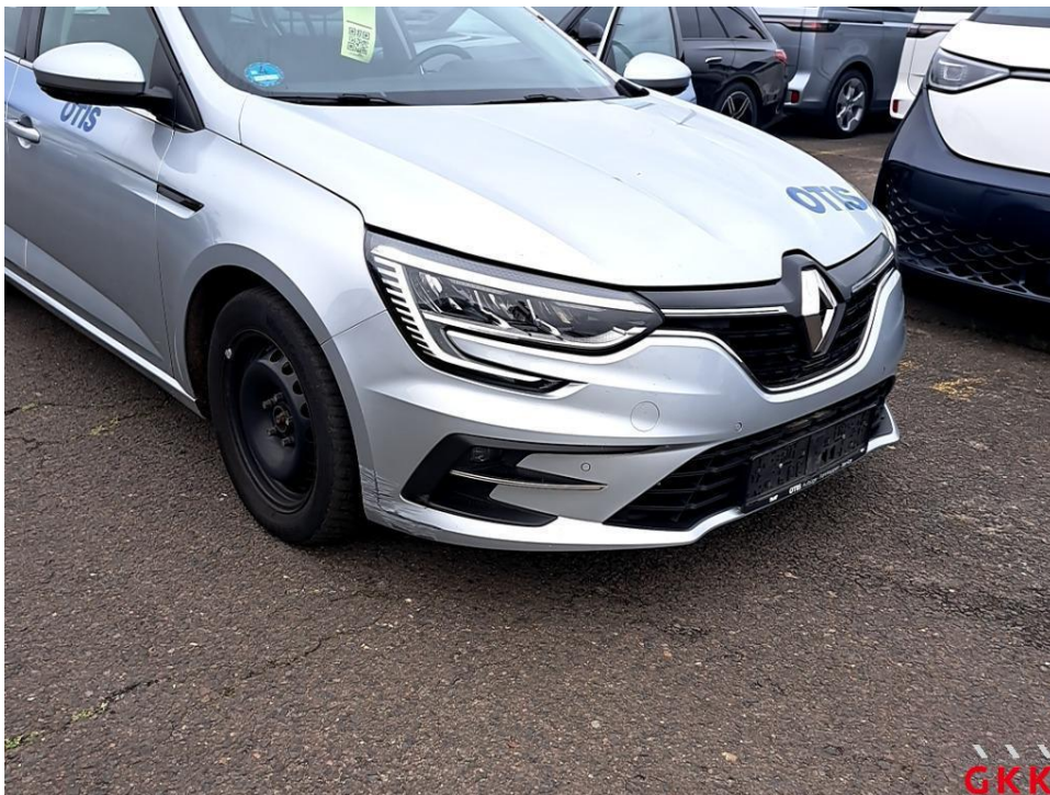
Bild 14. Stoßfänger vorne, Verkleidung -lackiert-, verkratzt, ersetzen
