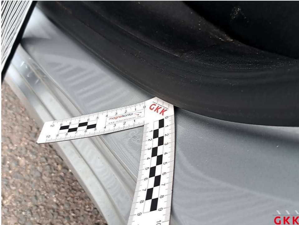
Bild 23. Tür hinten links, Einstieg, beschädigt, instand setzen - lackieren
