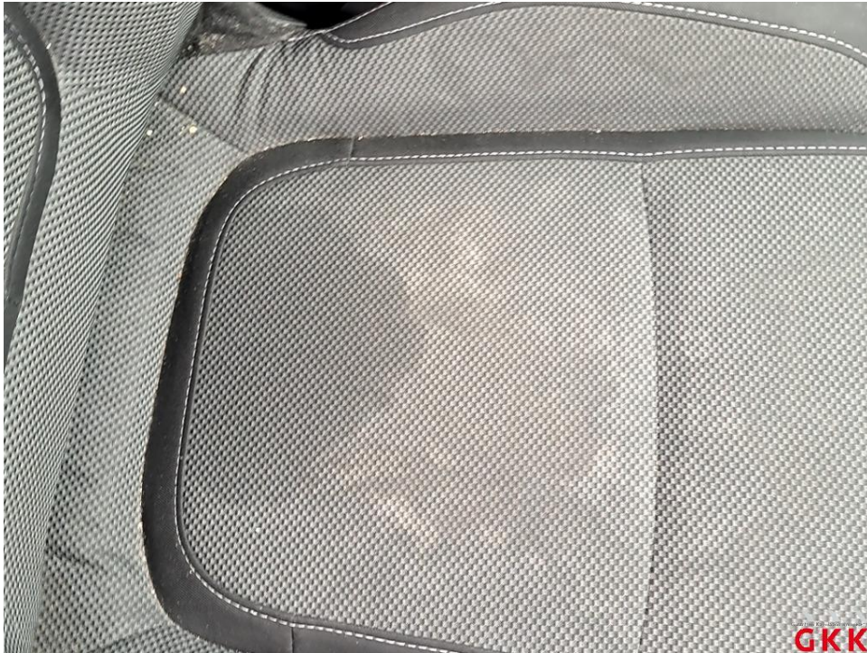
Bild 19. Sitz vorne rechts, Bezug Sitzkissen -Stoff-, verschmutzt, reinigen
