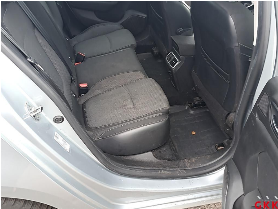
Bild 20. Sitzbank hinten, Bezug Sitzkissen -Stoff-, verschmutzt, reinigen
