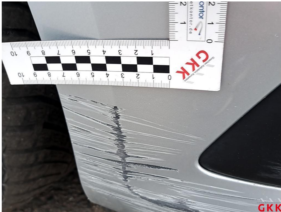
Bild 15. Stoßfänger vorne, Verkleidung -lackiert-, verkratzt, ersetzen
