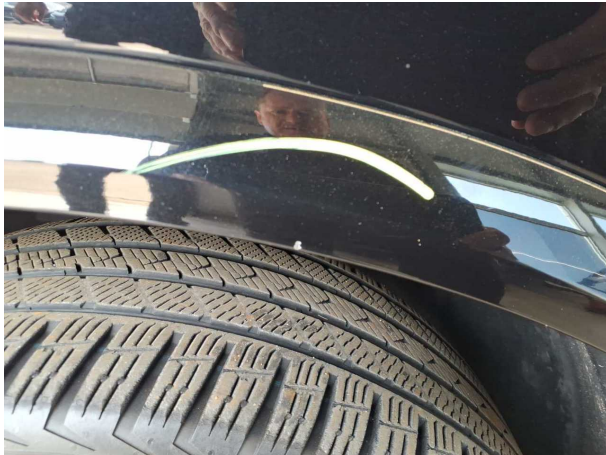
Beschädigung #4: Kotflügel links: Radlauf - Kratzer - Smart Repair
