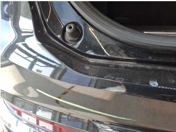
Beschädigung #30: Stossfänger hinten: Stossfänger hinten - Kratzer - lackieren
