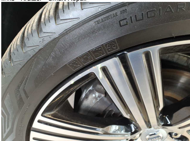
Beschädigung #12: Rad/Reifen: Leichtmetallfelge vorn links - Kratze... Wertminderung
