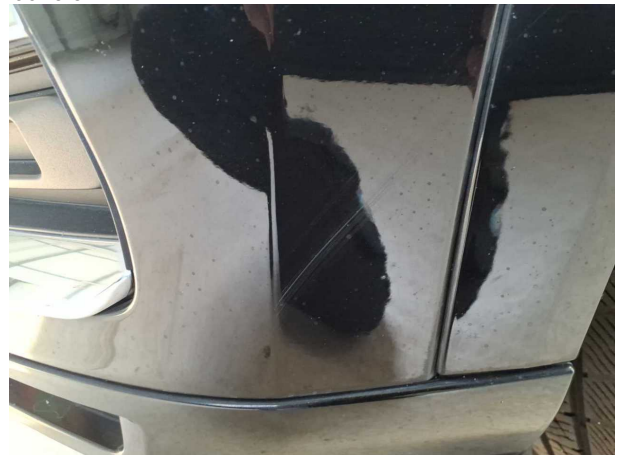
Beschädigung #31: Stossfänger vorn: Stossfänger vorn - Kratzer - lackieren
