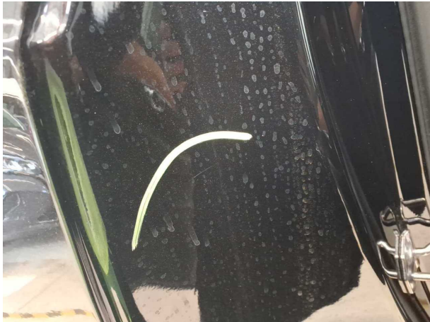
Beschädigung #8: Seitenwand rechts: Einstieg - Kratzer - Smart Repair
