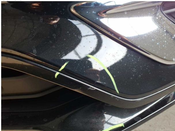
Beschädigung #31: Stossfänger vorn: Stossfänger vorn - Kratzer - lackieren
