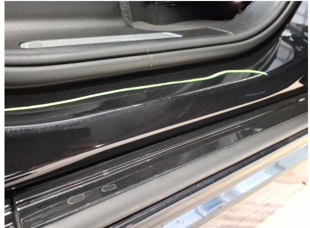
Beschädigung #8: Seitenwand rechts: Einstieg - Kratzer - Smart Repair
