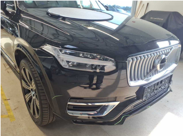
Beschädigung #31: Stossfänger vorn: Stossfänger vorn - Kratzer - lackieren
