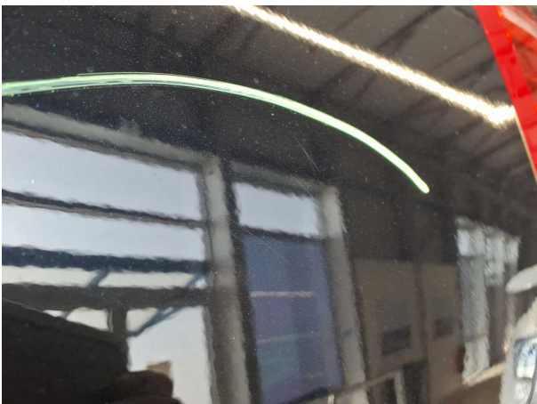
Beschädigung #23: Seitenwand links: Seitenwand - Kratzer - lackieren
