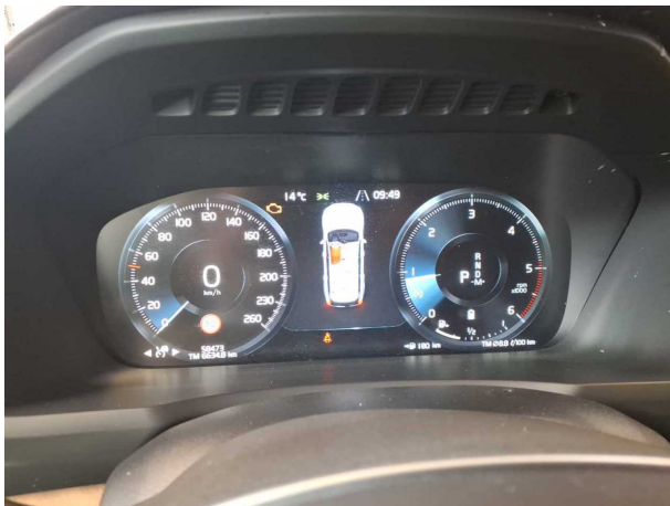
Beschädigung #15: Instrumententafel: Kontrollleuchte (MKL) - elektrischer Fehler - befunden ggf. instandsetzen
