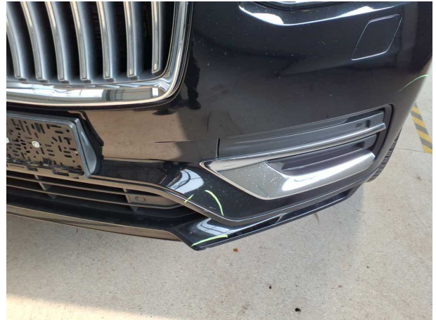
Beschädigung #31: Stossfänger vorn: Stossfänger vorn - Kratzer - lackieren
