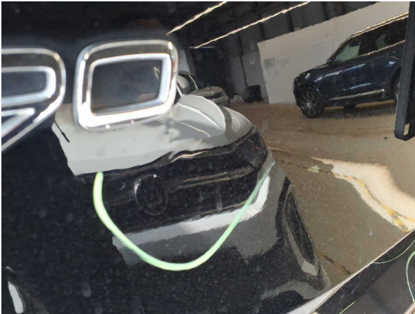
Beschädigung #33: Heckklappe/-tür: Heckklappe - Delle / Lackschaden - lackieren
