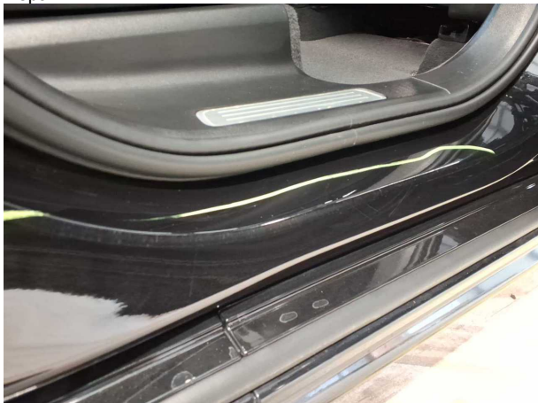
Beschädigung #8: Seitenwand rechts: Einstieg - Kratzer - Smart Repair
