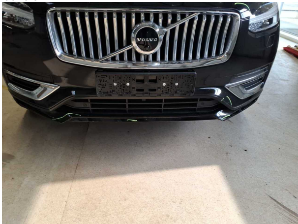
Beschädigung #26: Stossfänger vorn: Spoiler - Kratzer - lackieren
