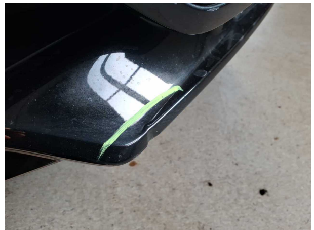
Beschädigung #26: Stossfänger vorn: Spoiler - Kratzer - lackieren
