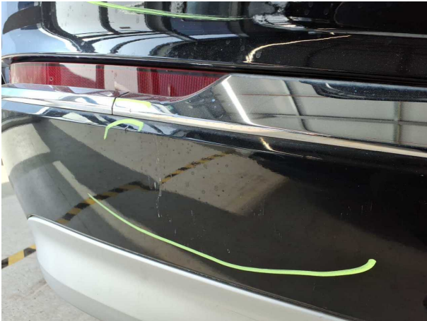
Beschädigung #30: Stossfänger hinten: Stossfänger hinten - Kratzer - lackieren
