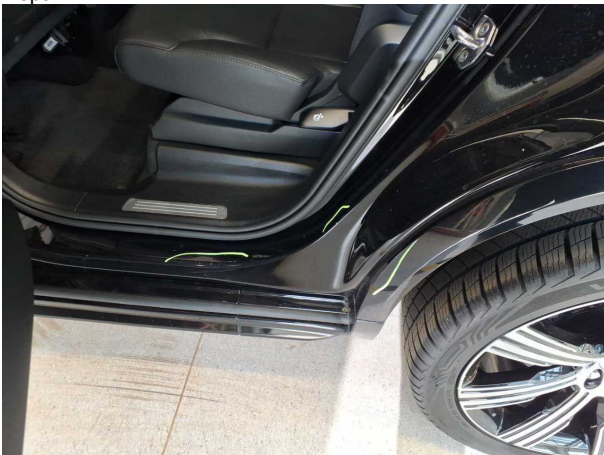
Beschädigung #7: Seitenwand links: Einstieg - Kratzer - Smart Repair
