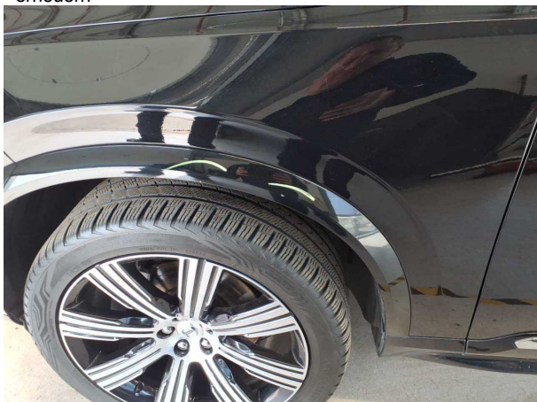
Beschädigung #4: Kotflügel links: Radlauf - Kratzer - Smart Repair
