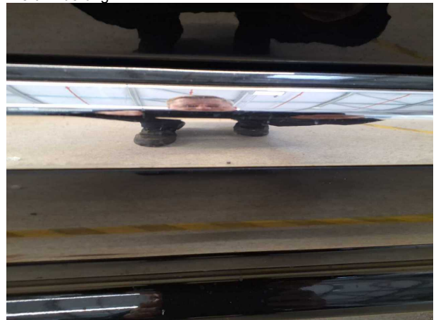
Beschädigung #14: Tür vorn rechts: Zierleiste unten - Kratzer - Wertminderung
