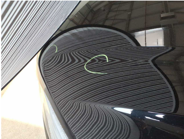
Beschädigung #32: Motorhaube: Motorhaube - Delle / Lackschaden - lackieren
