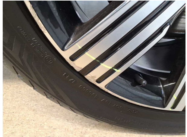
Beschädigung #16: Rad/Reifen: Leichtmetallfelge vorn rechts - beschädigt - erneuern
