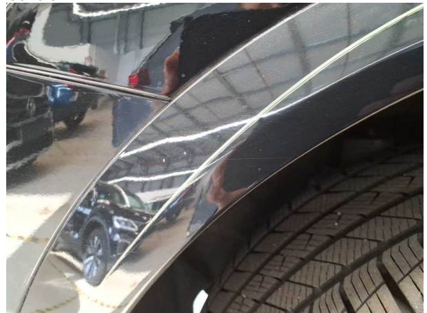
Beschädigung #21: Seitenwand rechts: Radlauf - Kratzer - lackieren
