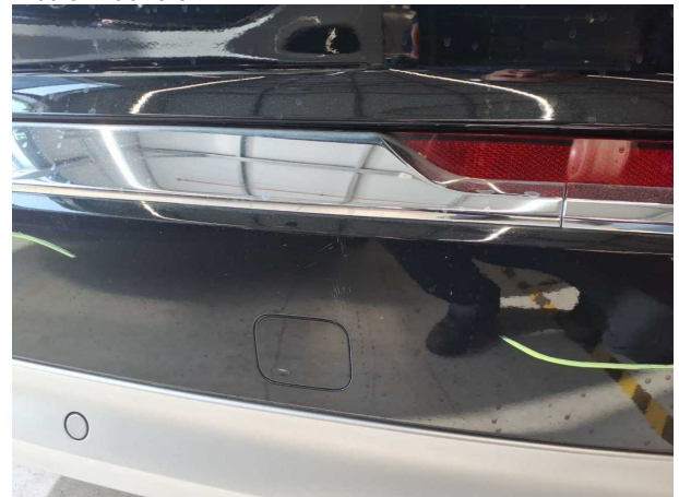
Beschädigung #30: Stossfänger hinten: Stossfänger hinten - Kratzer - lackieren
