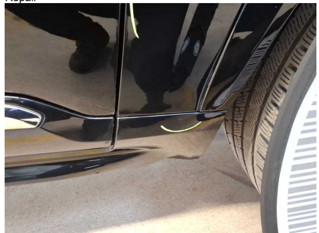
Beschädigung #6: Schweller rechts: Verkleidung - Kratzer - Smart Repair
