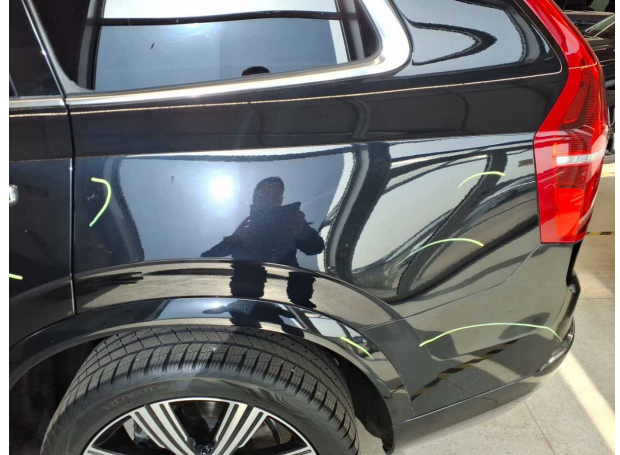
Beschädigung #23: Seitenwand links: Seitenwand - Kratzer - lackieren
