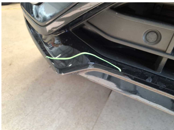
Beschädigung #26: Stossfänger vorn: Spoiler - Kratzer - lackieren
