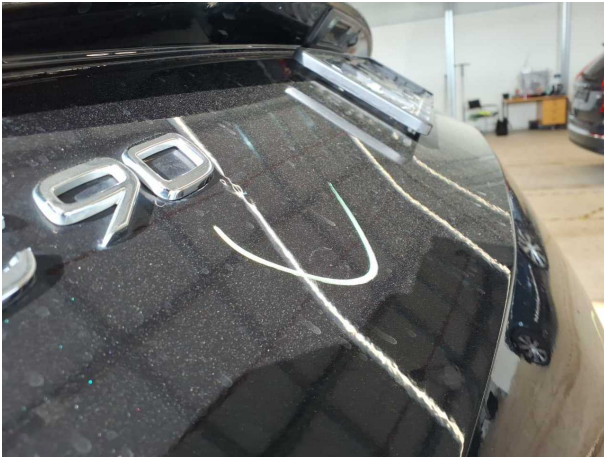
Beschädigung #33: Heckklappe/-tür: Heckklappe - Delle / Lackschaden - lackieren
