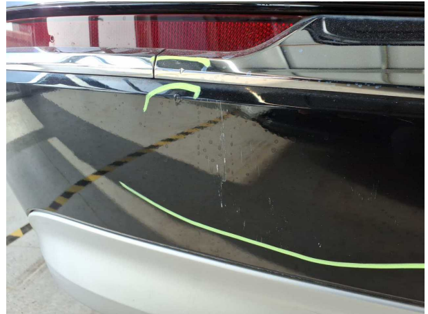
Beschädigung #30: Stossfänger hinten: Stossfänger hinten - Kratzer - lackieren
