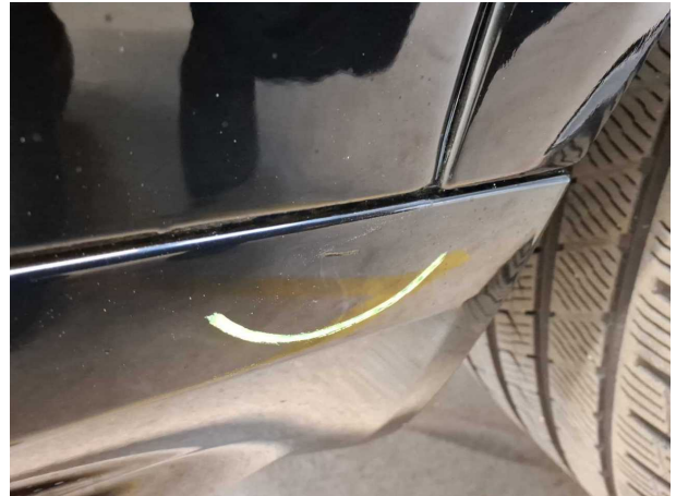
Beschädigung #6: Schweller rechts: Verkleidung - Kratzer - Smart Repair
