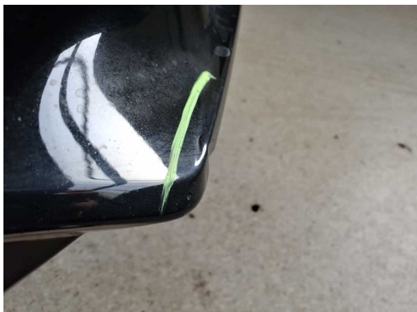
Beschädigung #26: Stossfänger vorn: Spoiler - Kratzer - lackieren
