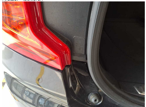
Beschädigung #30: Stossfänger hinten: Stossfänger hinten - Kratzer - lackieren
