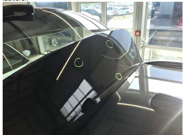
Beschädigung #24: Heckklappe/-tür: Heckspoiler - Kratzer - lackieren
