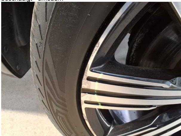
Beschädigung #16: Rad/Reifen: Leichtmetallfelge vorn rechts - beschädigt - erneuern
