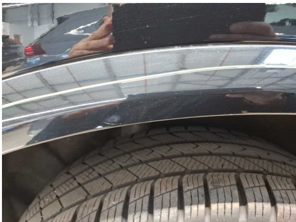
Beschädigung #21: Seitenwand rechts: Radlauf - Kratzer - lackieren
