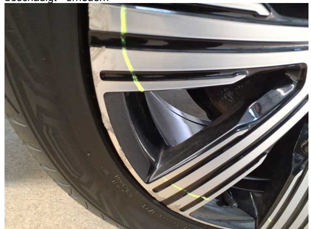
Beschädigung #16: Rad/Reifen: Leichtmetallfelge vorn rechts - beschädigt - erneuern
