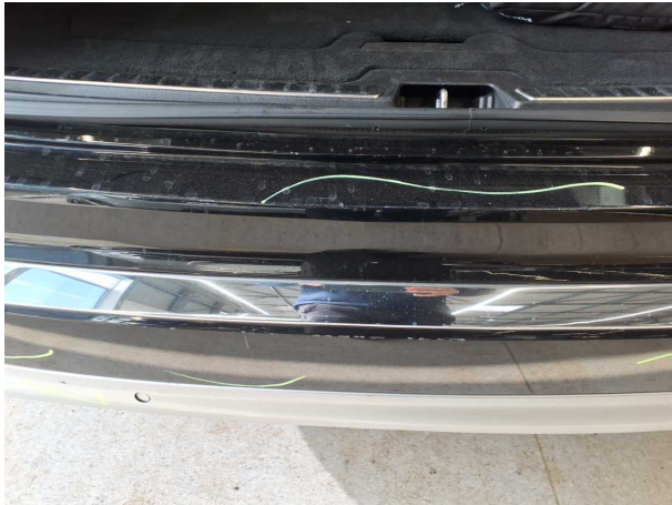
Beschädigung #30: Stossfänger hinten: Stossfänger hinten - Kratzer - lackieren
