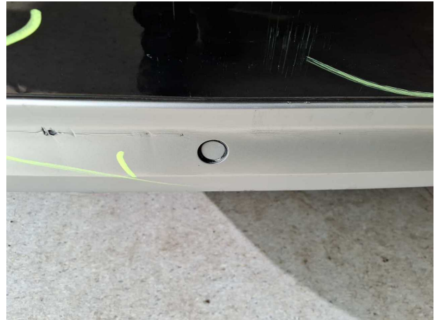
Beschädigung #19: Stossfänger hinten: Parksensoren Mitte - beschädigt - erneuern
