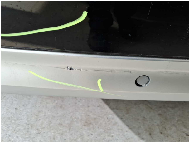
Beschädigung #25: Stossfänger hinten: Spoiler - beschädigt - lackieren
