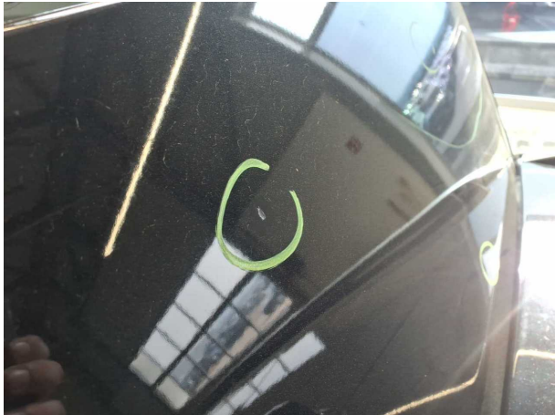
Beschädigung #24: Heckklappe/-tür: Heckspoiler - Kratzer - lackieren
