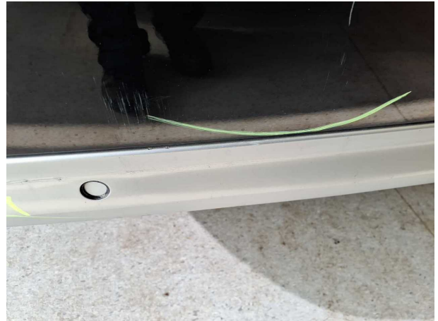
Beschädigung #25: Stossfänger hinten: Spoiler - beschädigt - lackieren
