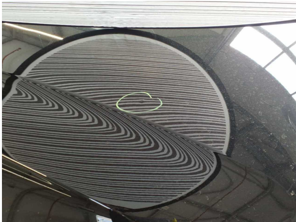
Beschädigung #32: Motorhaube: Motorhaube - Delle / Lackschaden - lackieren
