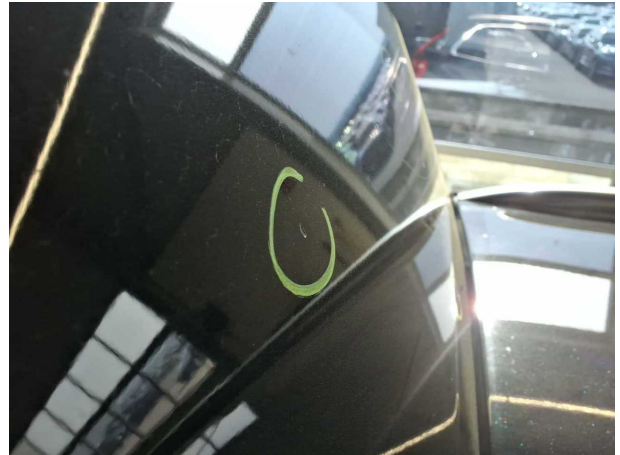
Beschädigung #24: Heckklappe/-tür: Heckspoiler - Kratzer - lackieren
