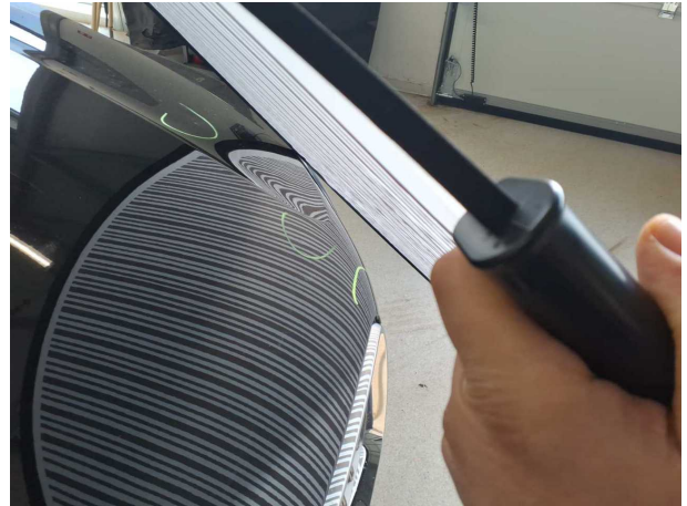
Beschädigung #32: Motorhaube: Motorhaube - Delle / Lackschaden - lackieren
