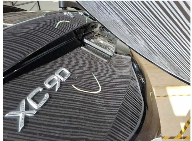
Beschädigung #33: Heckklappe/-tür: Heckklappe - Delle / Lackschaden - lackieren
