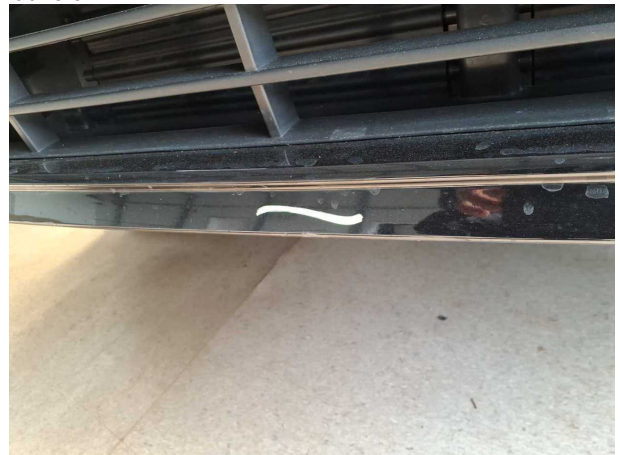
Beschädigung #26: Stossfänger vorn: Spoiler - Kratzer - lackieren
