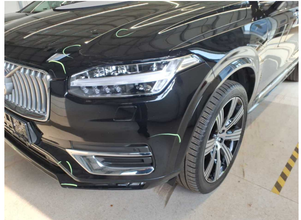
Beschädigung #31: Stossfänger vorn: Stossfänger vorn - Kratzer - lackieren
