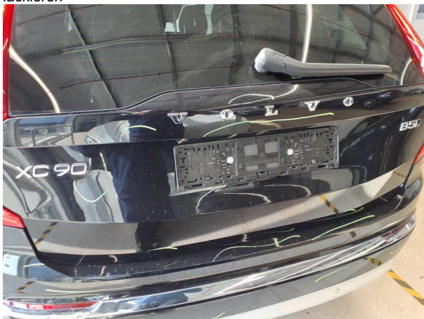
Beschädigung #33: Heckklappe/-tür: Heckklappe - Delle / Lackschaden - lackieren
