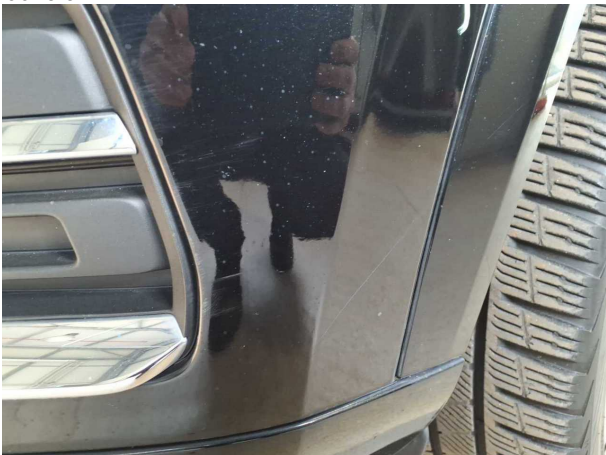
Beschädigung #31: Stossfänger vorn: Stossfänger vorn - Kratzer - lackieren
