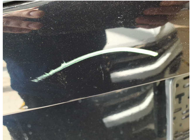
Beschädigung #33: Heckklappe/-tür: Heckklappe - Delle / Lackschaden - lackieren
