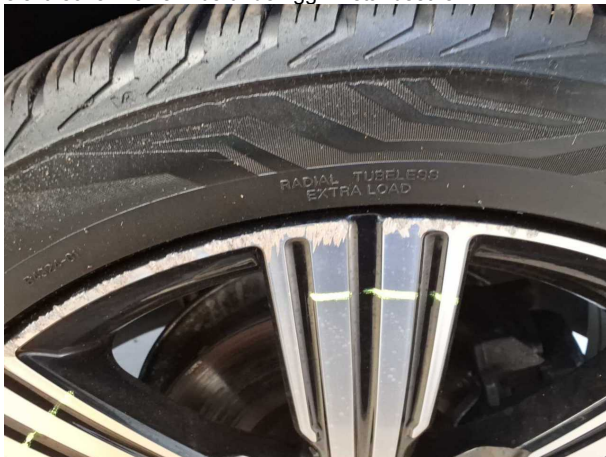
Beschädigung #16: Rad/Reifen: Leichtmetallfelge vorn rechts - beschädigt - erneuern
