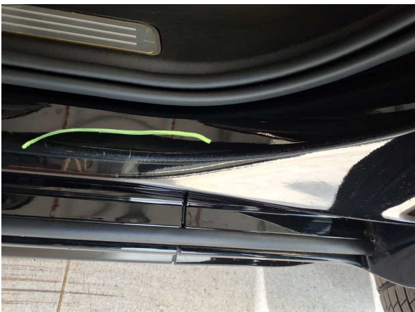
Beschädigung #7: Seitenwand links: Einstieg - Kratzer - Smart Repair
