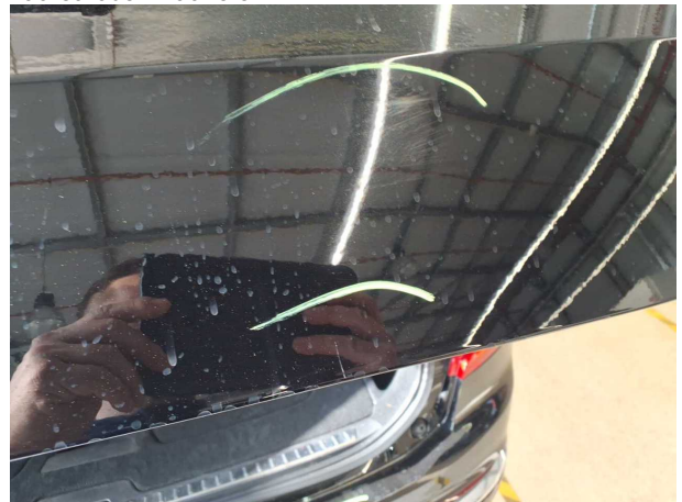
Beschädigung #33: Heckklappe/-tür: Heckklappe - Delle / Lackschaden - lackieren
