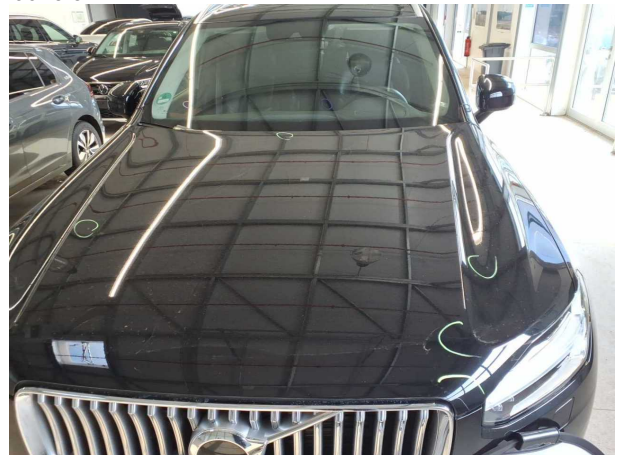
Beschädigung #32: Motorhaube: Motorhaube - Delle / Lackschaden - lackieren
