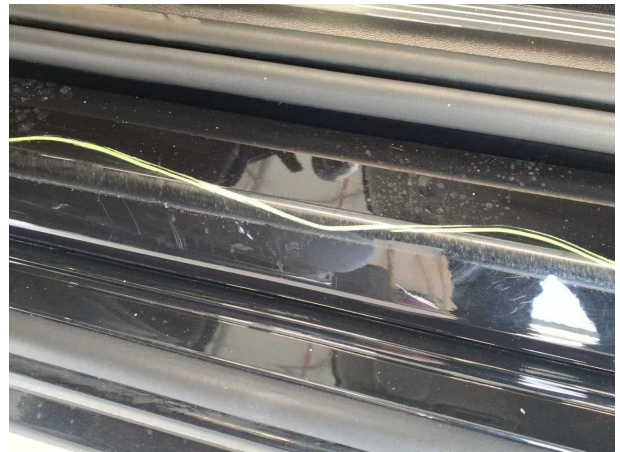
Beschädigung #5: Schweller links: Einstieg - Kratzer - Smart Repair
