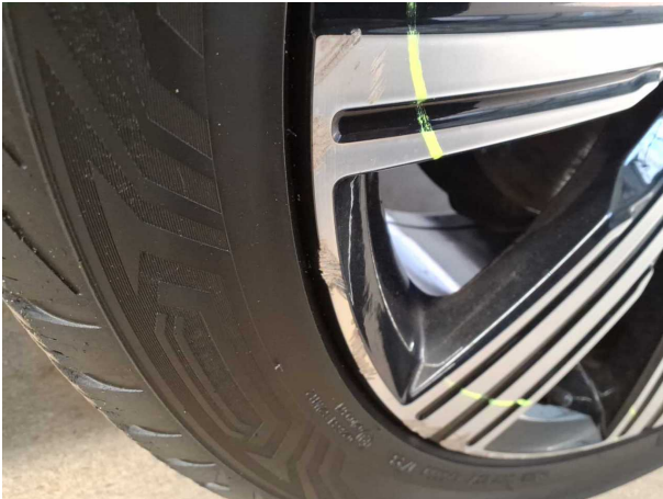
Beschädigung #16: Rad/Reifen: Leichtmetallfelge vorn rechts - beschädigt - erneuern
