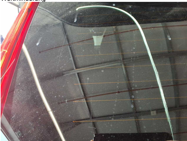
Beschädigung #17: Verglasung: Heckscheibe - Kratzer - Wertminderung
