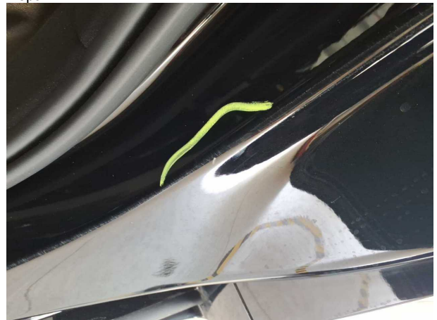
Beschädigung #7: Seitenwand links: Einstieg - Kratzer - Smart Repair
