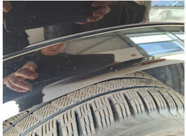
Beschädigung #4: Kotflügel links: Radlauf - Kratzer - Smart Repair
