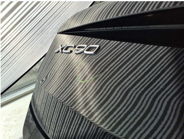
Beschädigung #33: Heckklappe/-tür: Heckklappe - Delle / Lackschaden - lackieren
