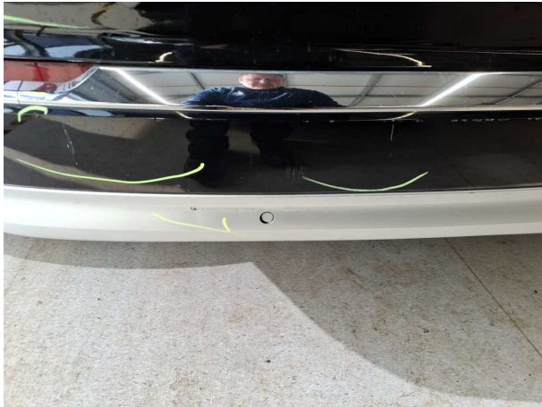
Beschädigung #19: Stossfänger hinten: Parksensoren Mitte - beschädigt - erneuern
