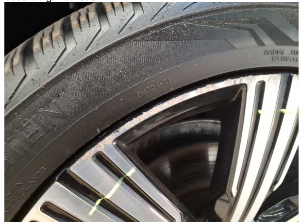
Beschädigung #16: Rad/Reifen: Leichtmetallfelge vorn rechts - beschädigt - erneuern
