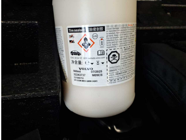
Beschädigung #1: Ausrüstung: Tirefit Füllmittel - abgelaufen - erneuern
