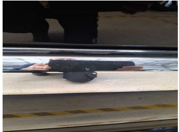
Beschädigung #13: Tür hinten rechts: Zierleiste unten - Kratzer - Wertminderung
