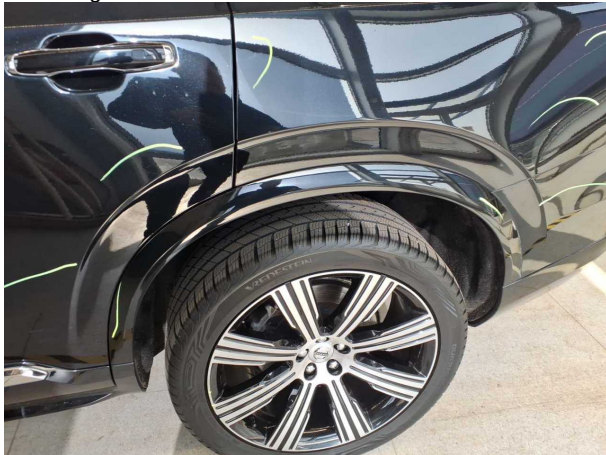
Beschädigung #20: Seitenwand links: Radlauf - Kratzer - lackieren
