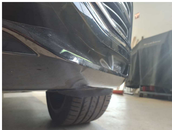
Beschädigung #26: Stossfänger vorn: Spoiler - Kratzer - lackieren
