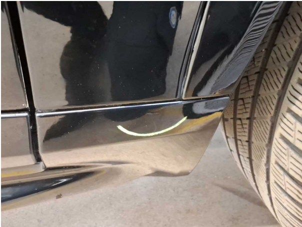
Beschädigung #6: Schweller rechts: Verkleidung - Kratzer - Smart Repair
