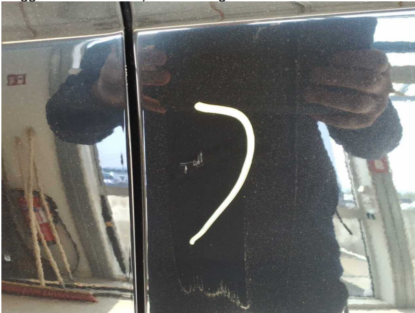
Beschädigung #23: Seitenwand links: Seitenwand - Kratzer - lackieren
