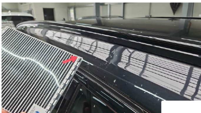
6. Dachrahmen - Links Umweltschaden
