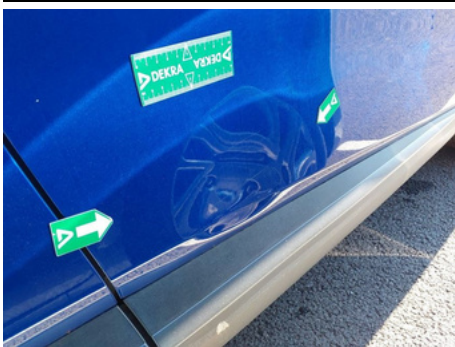
Porte / Avant Droit / Enfoncement
