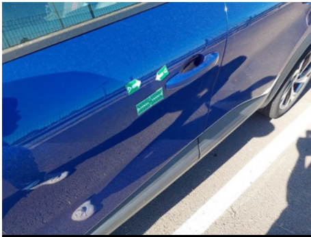
Porte / Avant Gauche / Enfoncement
