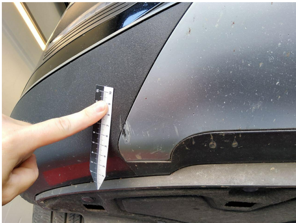
Bild 6 : Spoiler Stoßfänger vorne verschrammt
