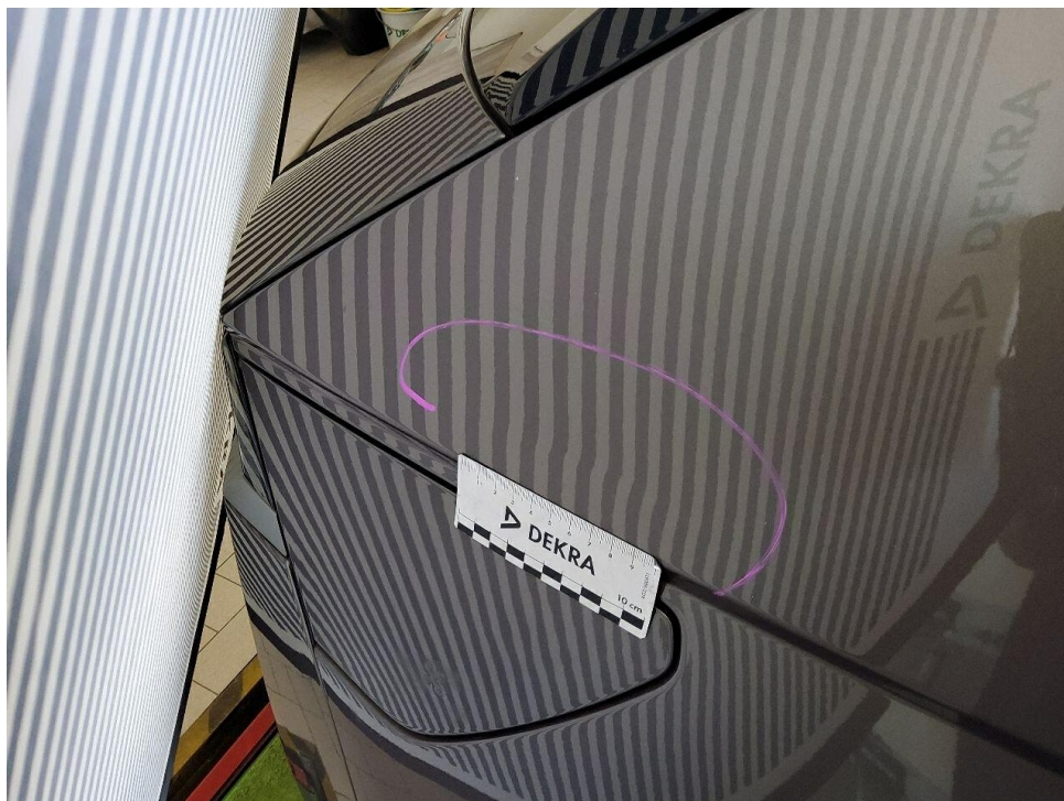
Bild 2 : Seitenteil hinten rechts eingedellt
