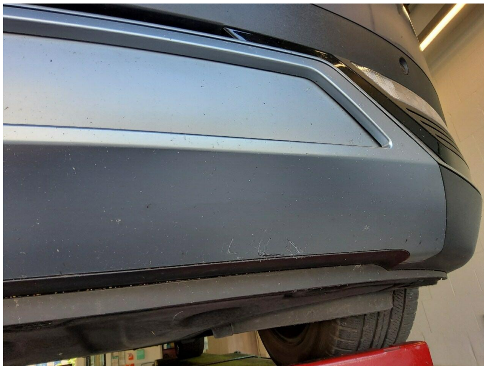
Bild 4 : Spoiler Stoßfänger vorne verschrammt
