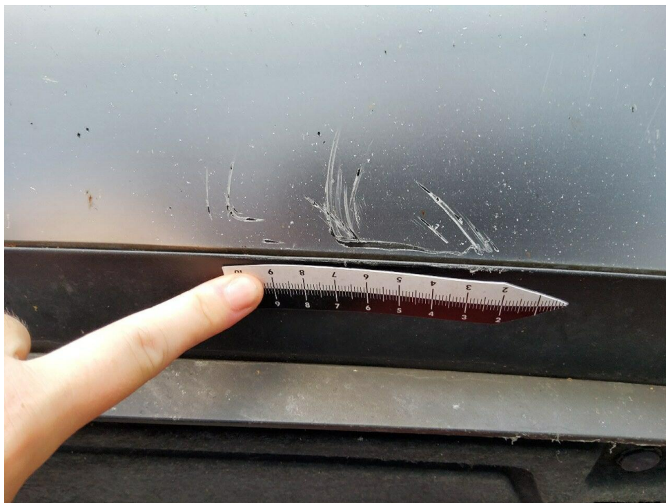
Bild 5 : Spoiler Stoßfänger vorne verschrammt
