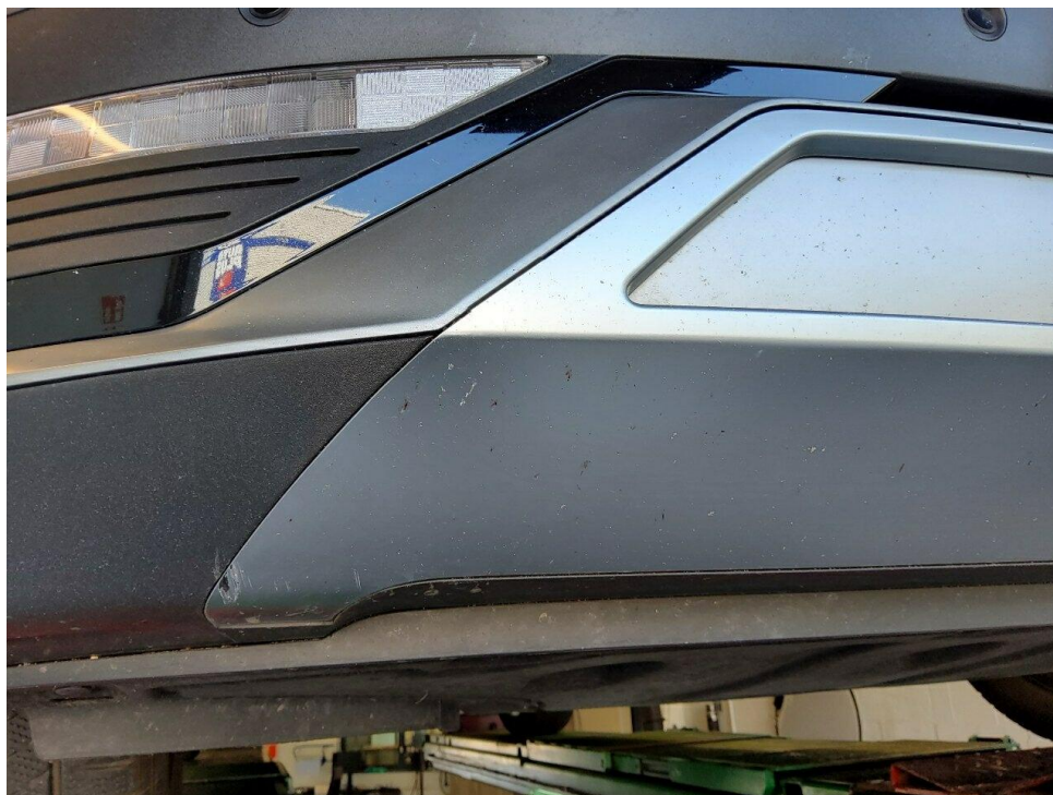
Bild 3 : Spoiler Stoßfänger vorne verschrammt
