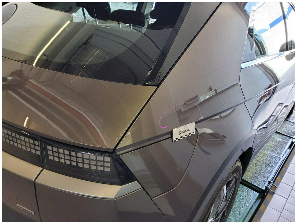
Bild 1 : Seitenteil hinten rechts eingedellt
