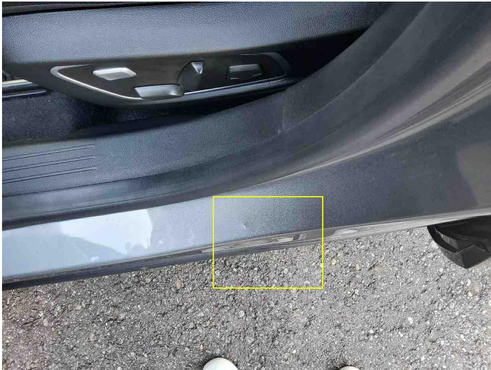
Bild 5 : Einstieg vorne links Delle mit Kratzer
