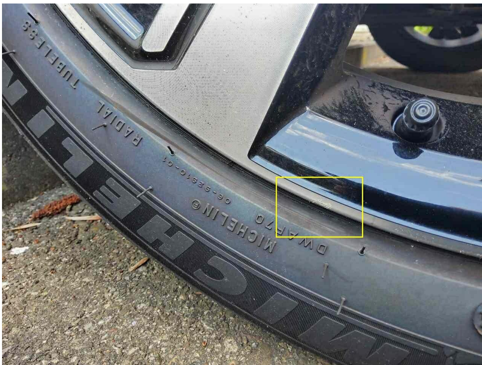
Bild 6 : Felge vorne links Kratzer
