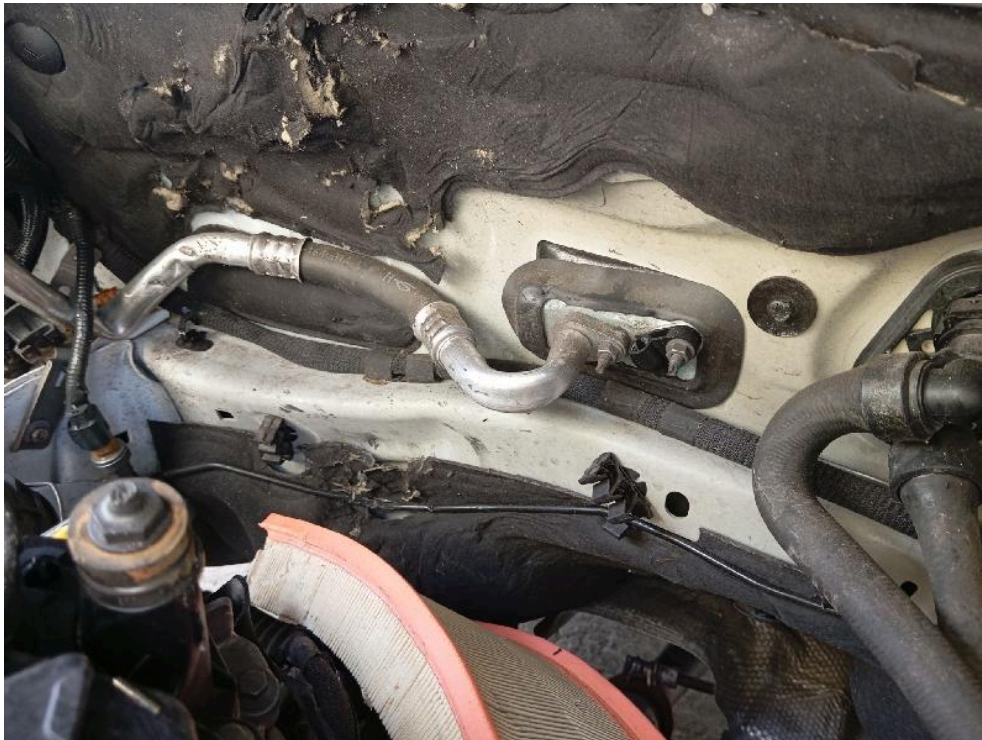
Bild: 19 Spritzwand Motorraum deformiert
