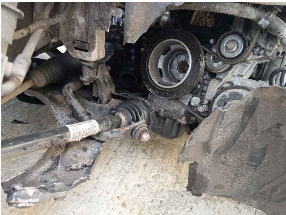
Bild: 20 Antriebswelle rechts abgerissen/ Achshälfte abgerissen
