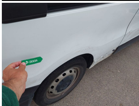
Aleta / Trasero Derecho / Abolladura
