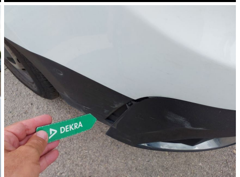
Paragolpes inferior / Delantero / Abolladura
