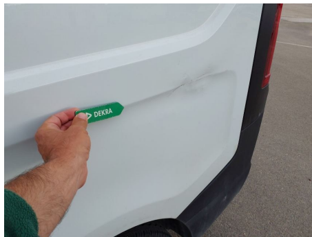
Panel lateral / Trasero Izquierdo / Abolladura
