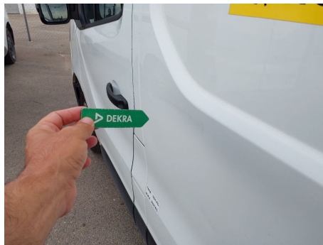
Panel lateral / Delantero Izquierdo / Abolladura
