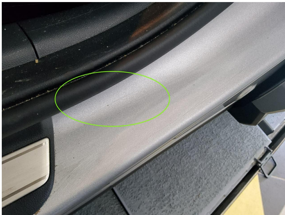
Bild 9 : Türeinstieg vorne links verkratzt
