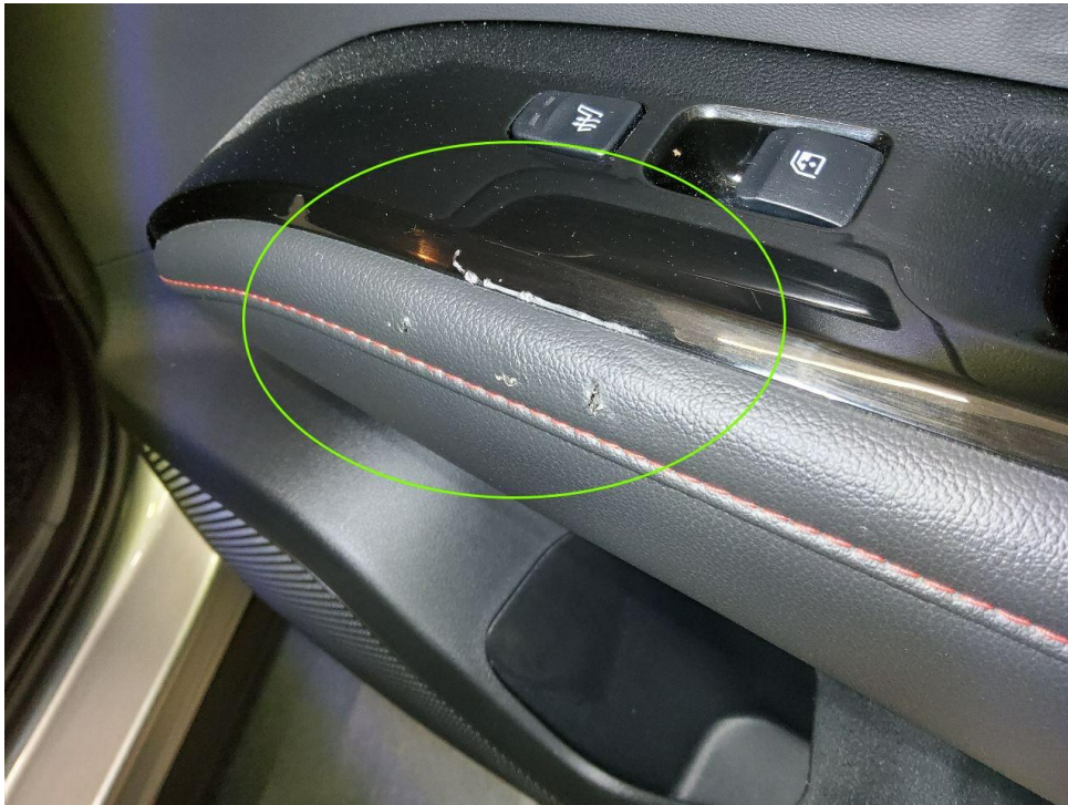
Bild 7 : Armablage Türverkleidung hinten rechts mehrfach verkratzt
