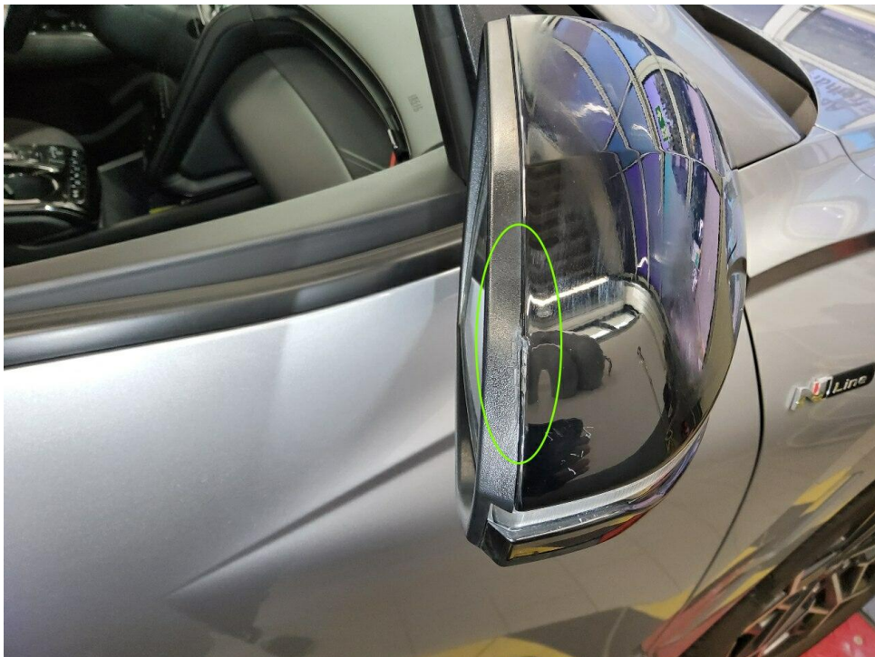
Bild 14 : Spiegelkappe und Blende rechts verschrammt
