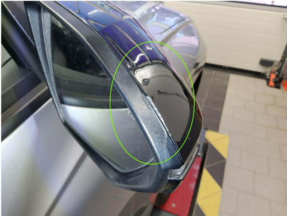
Bild 13 : Spiegelkappe und Blende rechts verschrammt
