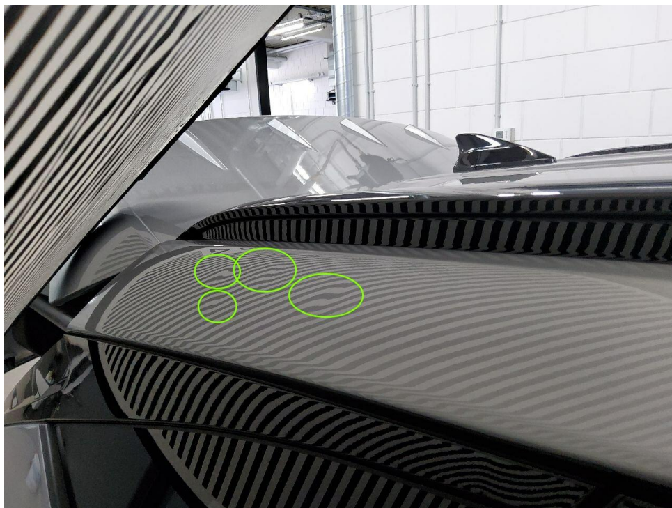
Bild 15 : Dachholm rechts mehrfach eingedellt
