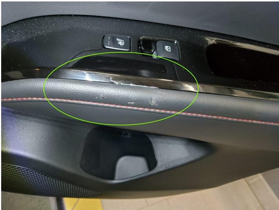
Bild 6 : Armablage Türverkleidung hinten rechts mehrfach verkratzt
