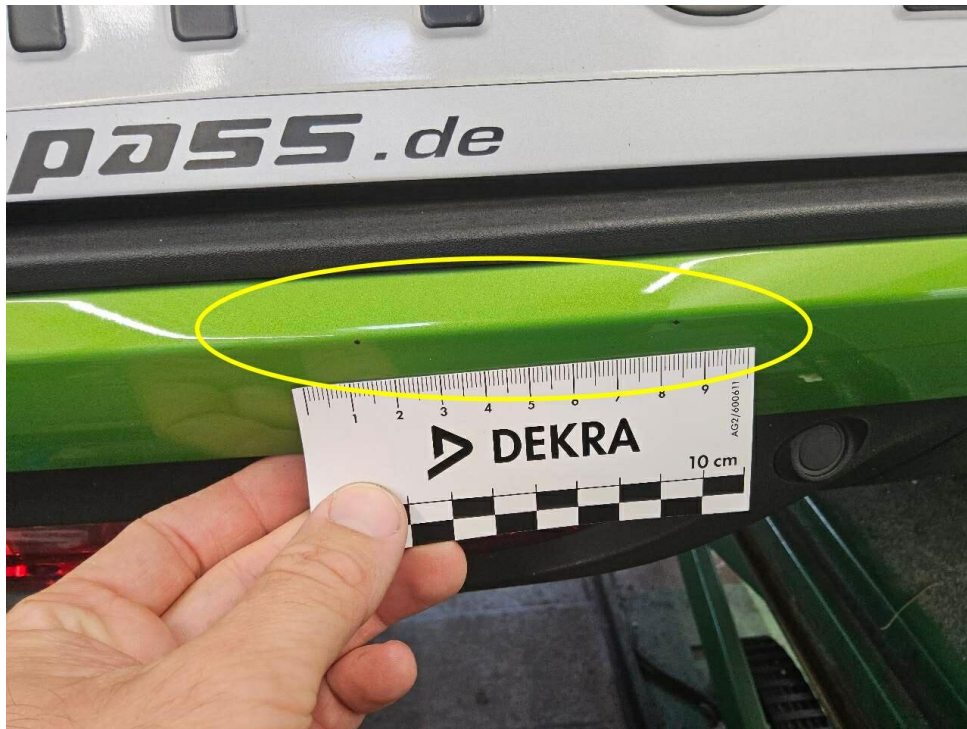
Bild 25 : Stoßfänger hinten Lackierung, zerkratzt, Gebrauchsspur
