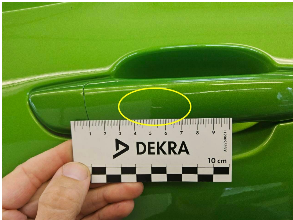
Bild 28 : Tür hinten rechts Türgriff, zerkratzt, Gebrauchsspur
