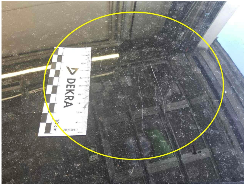
Bild 17 : Dach Lackierung, zerkratzt, lackieren mit Lackaufbau
