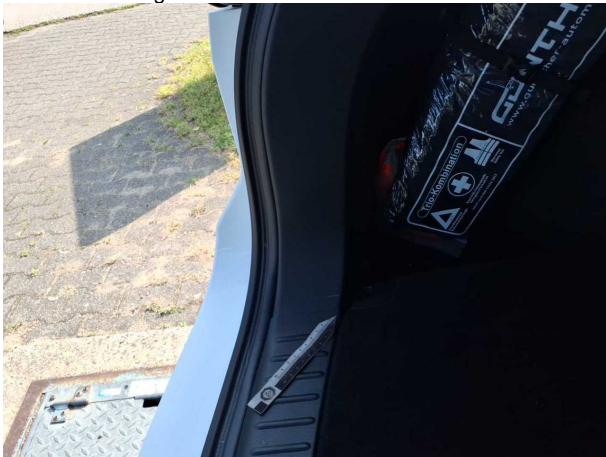
Beschädigung #4: Verkleidungen/Abdeckungen: Kofferraumverkleidung (Linksseitig) - verkratzt / verschürft -
