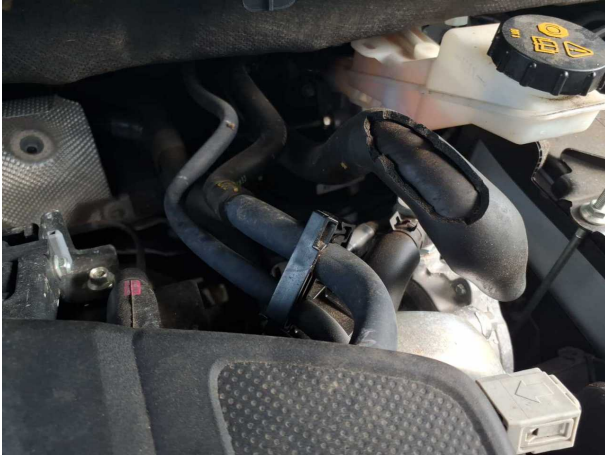
Beschädigung #1: Kraftstoffanlage: Kraftstoffleitung (Isolierung) - beschädigt - erneuern
