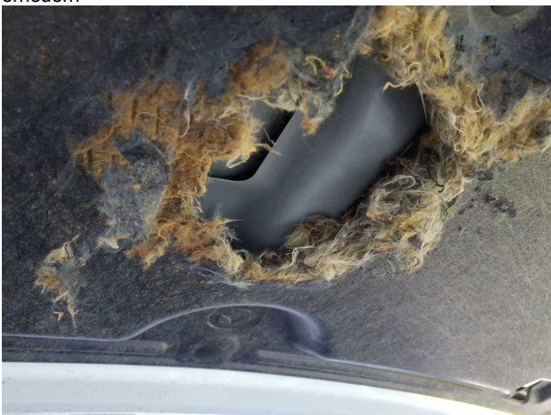
Beschädigung #2: Motorhaube: Dämmmatte - beschädigt - erneuern
