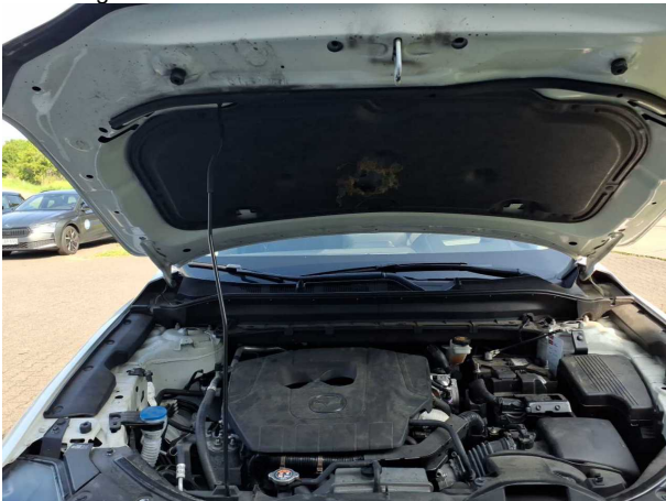
Beschädigung #2: Motorhaube: Dämmmatte - beschädigt - erneuern
