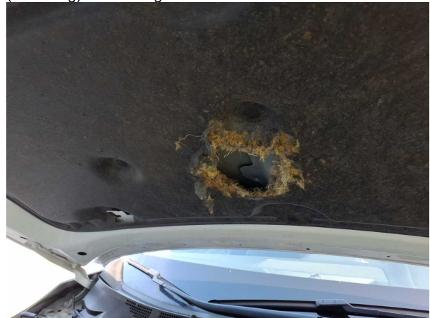
Beschädigung #2: Motorhaube: Dämmmatte - beschädigt - erneuern
