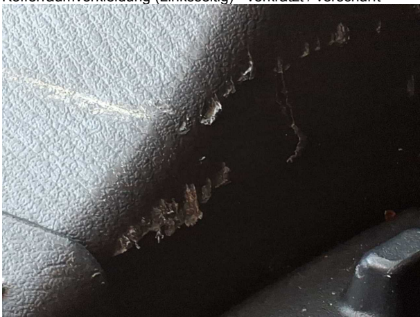
Beschädigung #4: Verkleidungen/Abdeckungen: Kofferraumverkleidung (Linksseitig) - verkratzt / verschürft -
