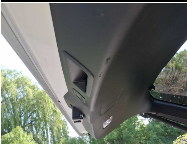
Beschädigung #3: Verkleidungen/Abdeckungen: Heckdeckel, Innenverkleidung - verkratzt / verschürft - erneuern
