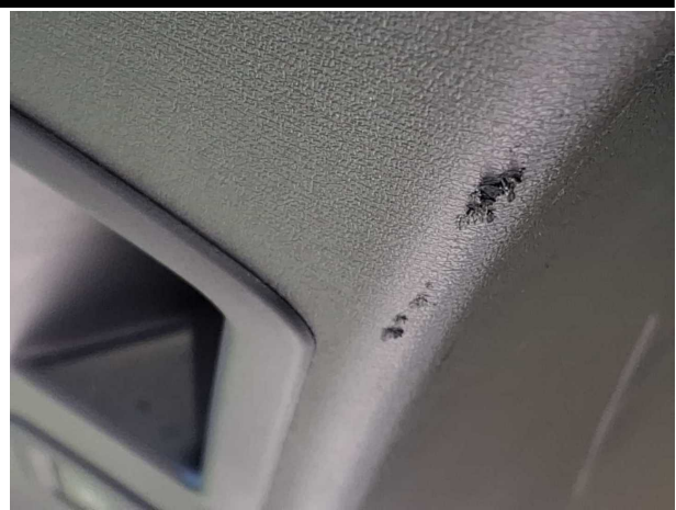
Beschädigung #3: Verkleidungen/Abdeckungen: Heckdeckel, Innenverkleidung - verkratzt / verschürft - erneuern
