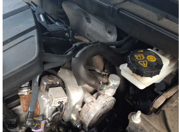
Beschädigung #1: Kraftstoffanlage: Kraftstoffleitung (Isolierung) - beschädigt - erneuern
