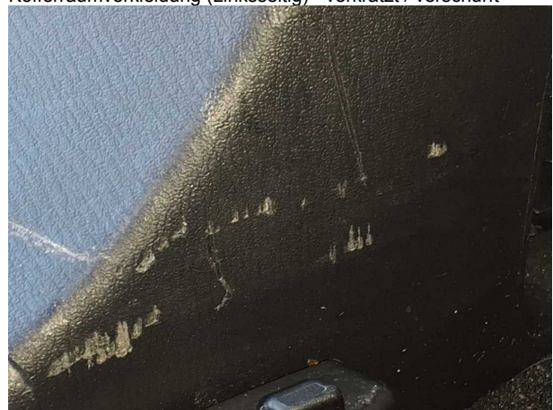
Beschädigung #4: Verkleidungen/Abdeckungen: Kofferraumverkleidung (Linksseitig) - verkratzt / verschürft -
