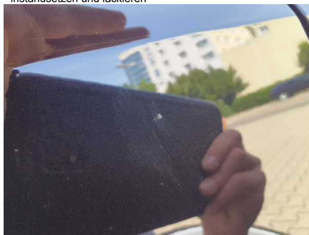
Beschädigung #4: Tür hinten rechts: Tür - Delle / Lackschaden - instandsetzen und lackieren
