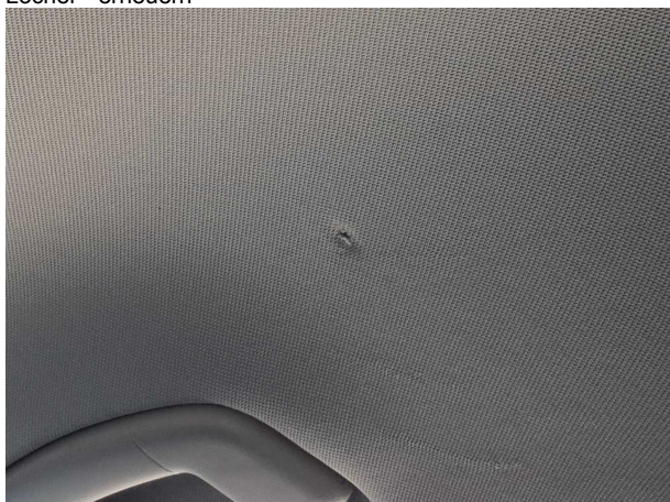
Beschädigung #3: Verkleidungen/Abdeckungen: Dachhimmel - Löcher - erneuern
