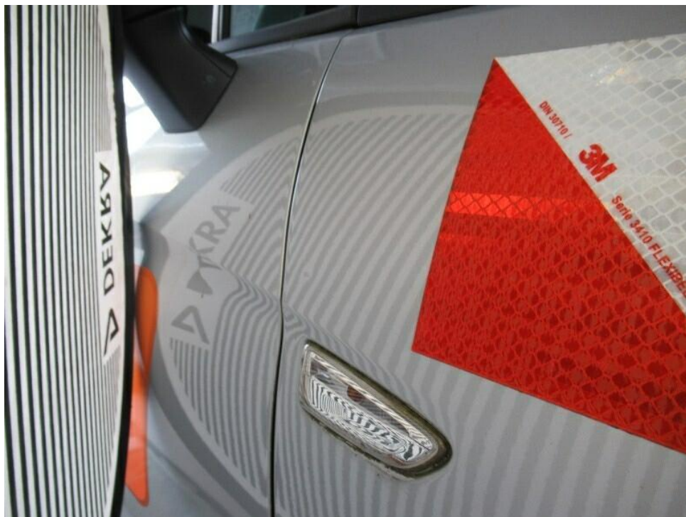
Bild 20 : Kotflügel vorne rechts, eingedellt, Gebrauchsspur
