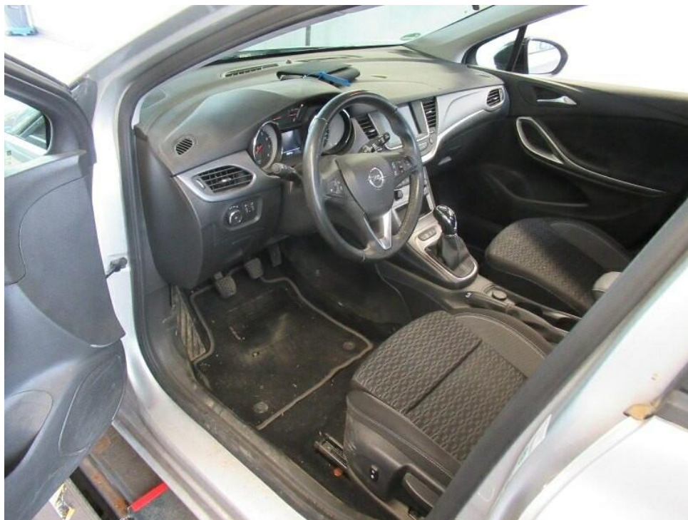
Bild 23 : Polster, Teppiche, Verkleidungen, ..... verschmutzt. Geruch im Fahrzeug: Ozonbehandlung.
