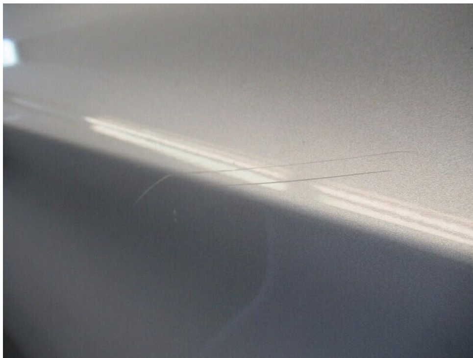
Bild 22 : Tür hinten links Lackierung, zerkratzt, Gebrauchsspur
