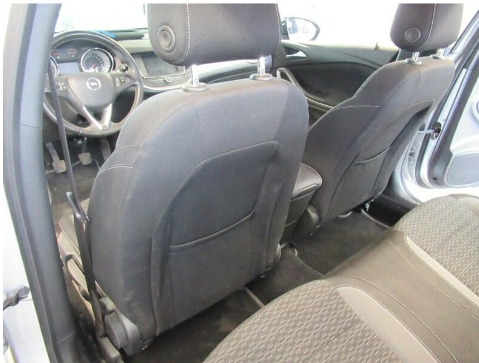
Bild 27 : Polster,Teppiche,Verkleidungen,..... verschmutzt. Geruch im Fahrzeug: Ozonbehandlung.
