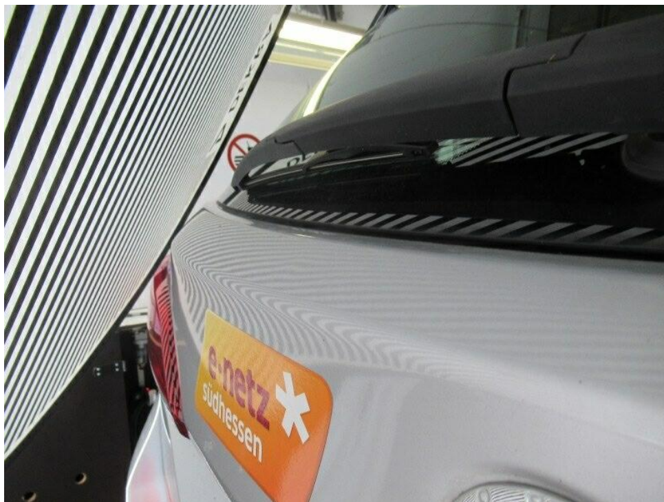
Bild 21 : Heckklappe, eingedellt, Gebrauchsspur
