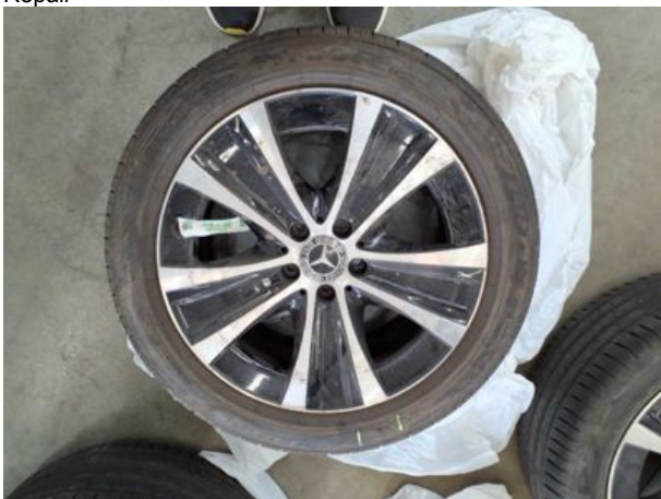
Beschädigung #12: 2.Radsatz: 1 Reifen - gebrochen / gerissen - erneuern
