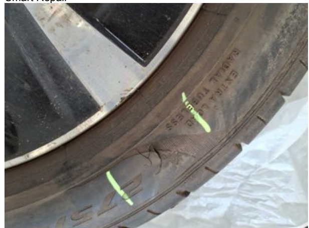
Beschädigung #12: 2.Radsatz: 1 Reifen - gebrochen / gerissen - erneuern
