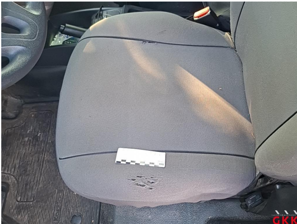
Bild 17. Sitz vorne links, Schonbezug, beschädigt, ersetzen
