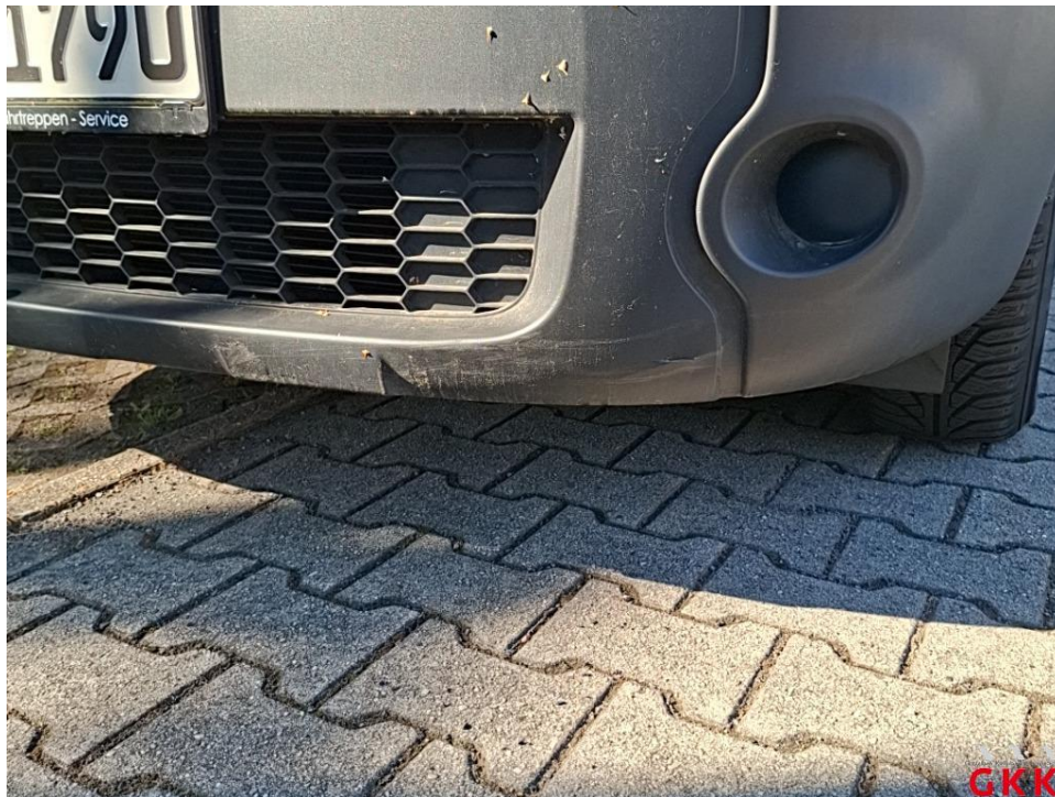
Bild 13. Stoßfänger vorne, Verkleidung -unlackiert-, beschädigt, ersetzen
