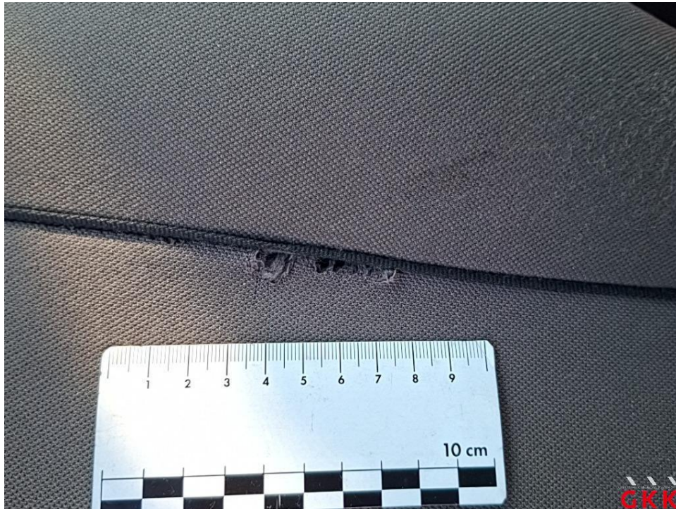
Bild 19. Sitz vorne links, Schonbezug, beschädigt, ersetzen
