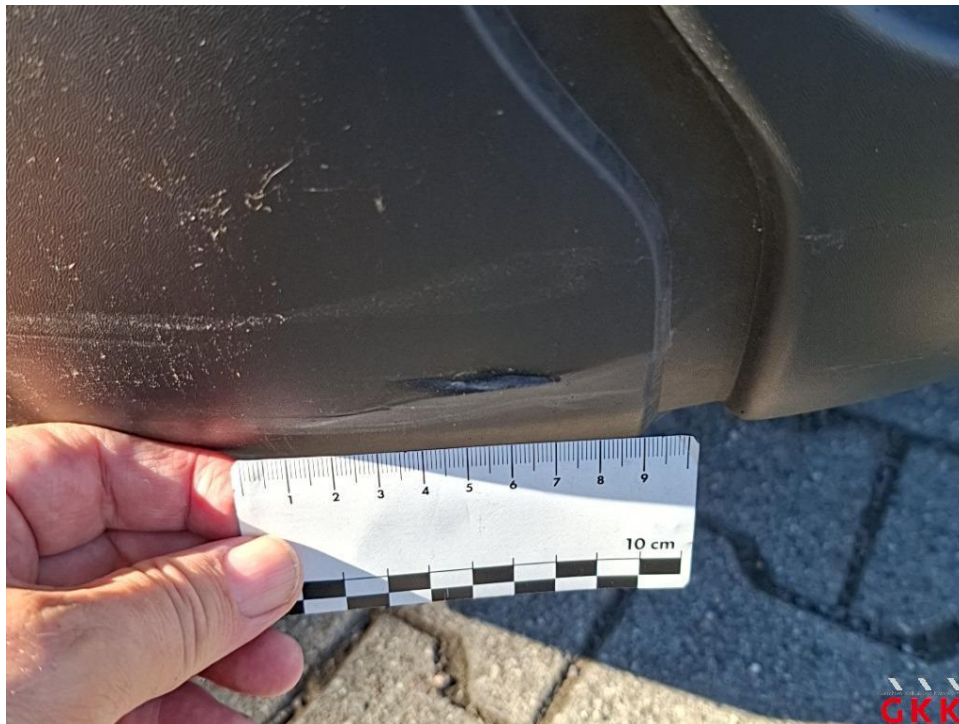
Bild 14. Stoßfänger vorne, Verkleidung -unlackiert-, beschädigt, ersetzen
