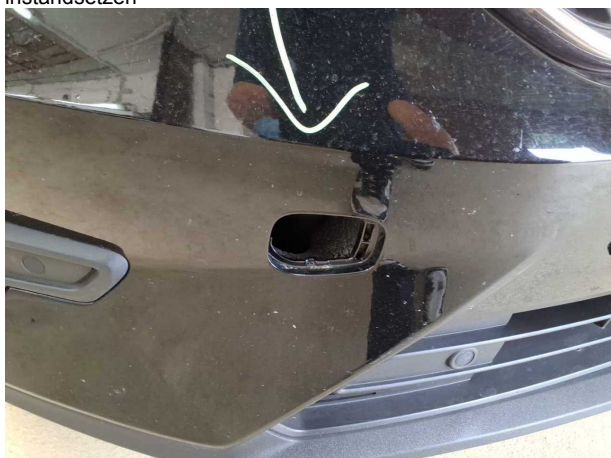
Beschädigung #2: Verkleidungen/Abdeckungen: Zierleiste / Dekorleiste (Fehl) - erneuern
