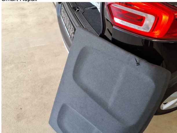
Beschädigung #4: Interieur: Hutablage - beschädigt - erneuern
