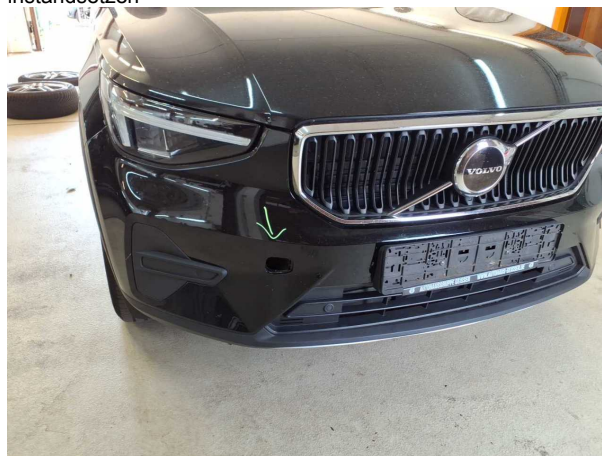
Beschädigung #2: Verkleidungen/Abdeckungen: Zierleiste / Dekorleiste (Fehl) - erneuern
