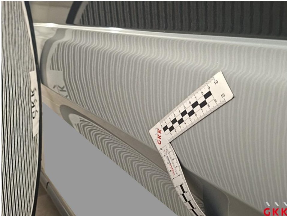
Bild 31 Seitenwand links, beschädigt, kalt drücken
