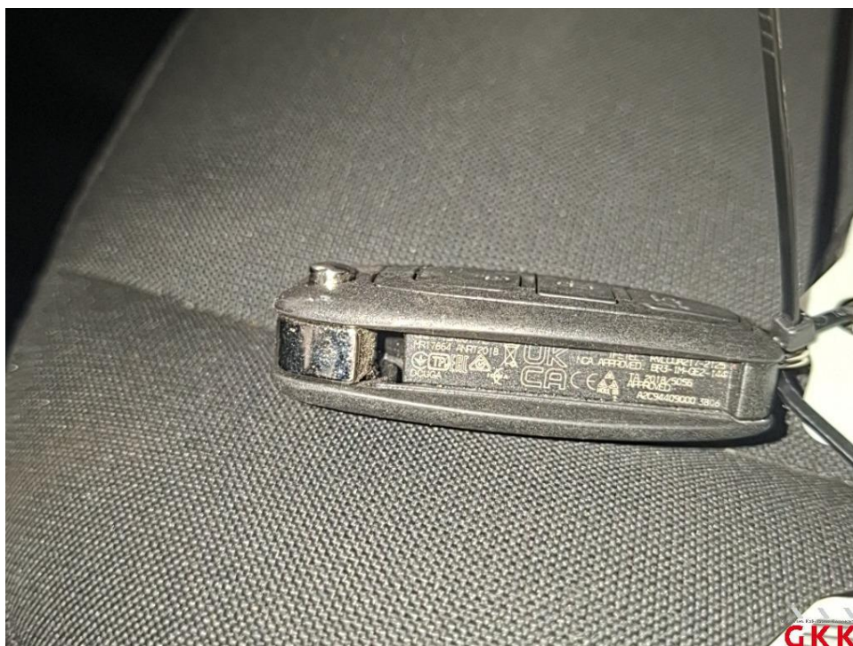
Bild 16 Hauptschlüssel, mit Fernbedienung, beschädigt, ersetzen
