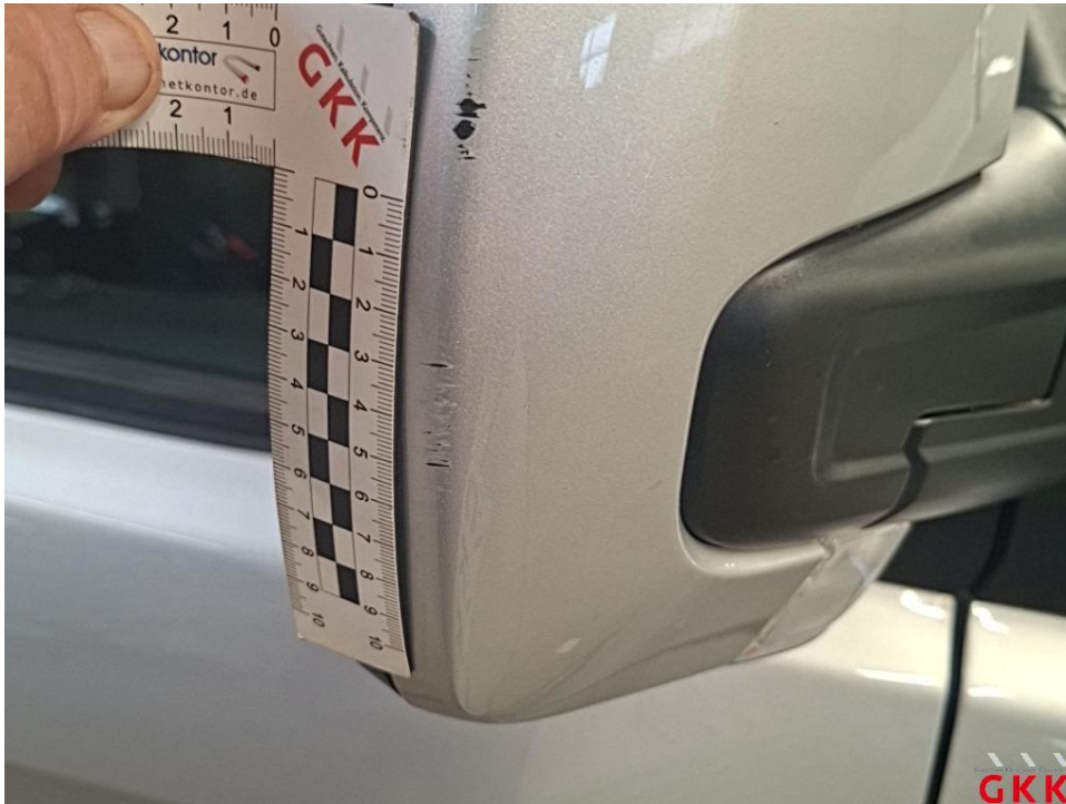
Bild 23 Spiegelgehäuse rechts, Kappe -lackiert-, verkratzt, lackieren
