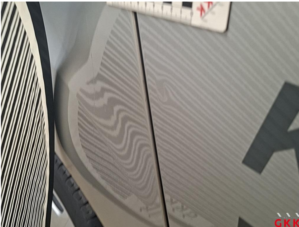
Bild 34 Schiebetür rechts, beschädigt, instand setzen - lackieren
