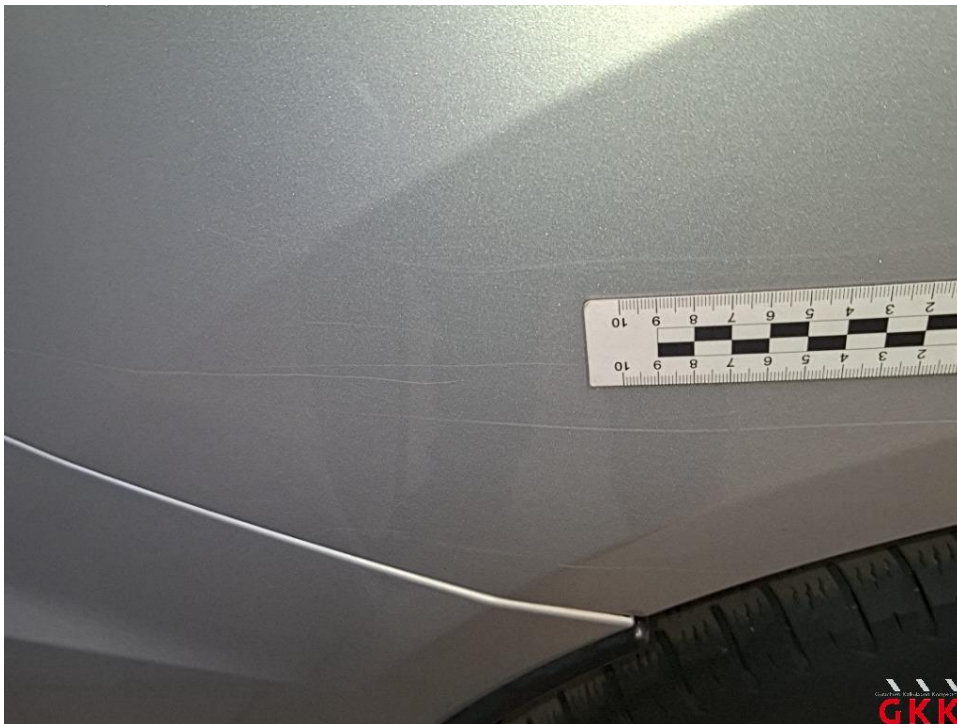
Bild 30 Seitenwand rechts, unterhalb, verkratzt, lackieren
