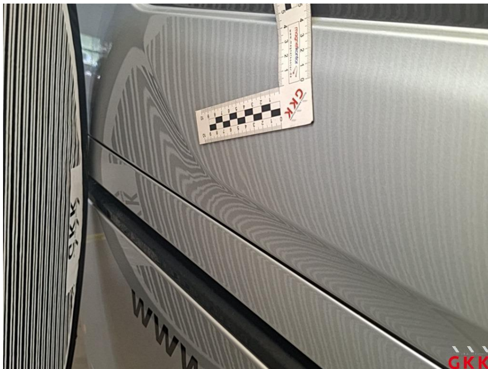
Bild 26 Seitenwand links, beschädigt, instand setzen - lackieren
