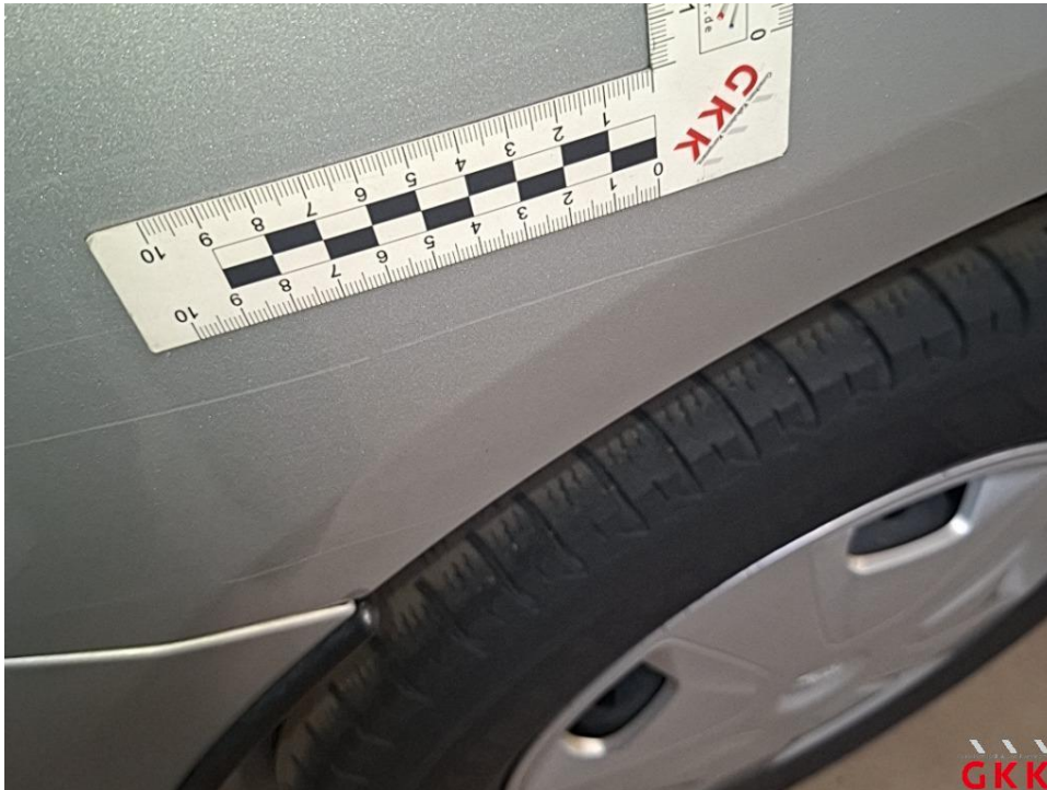
Bild 29 Seitenwand rechts, unterhalb, verkratzt, lackieren
