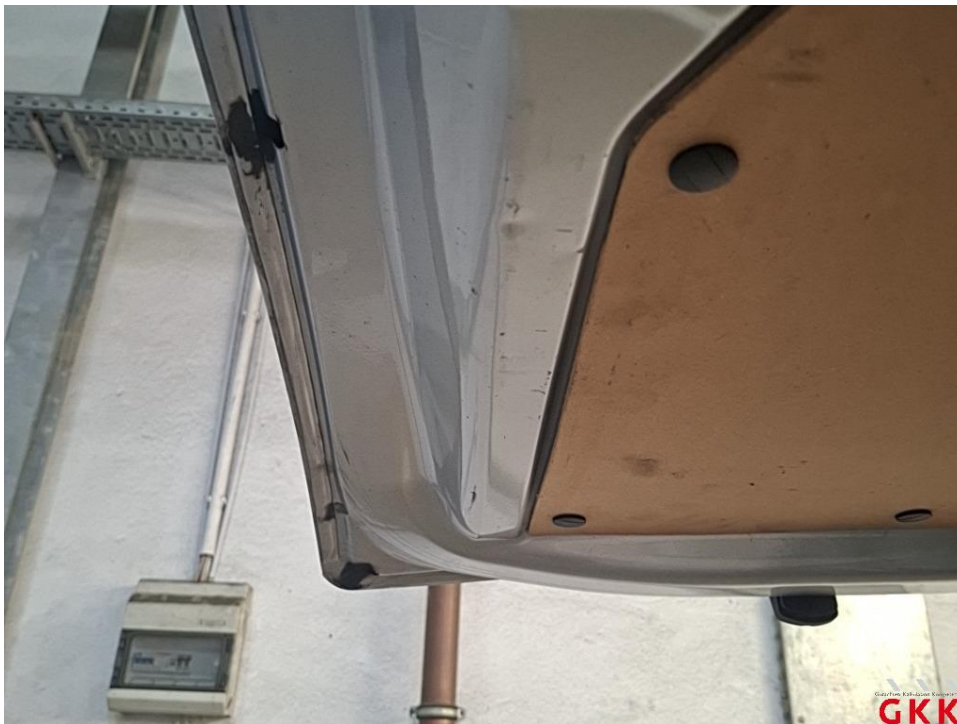
Bild 24 Heckklappe, innen, beschädigt, Smartrepair
