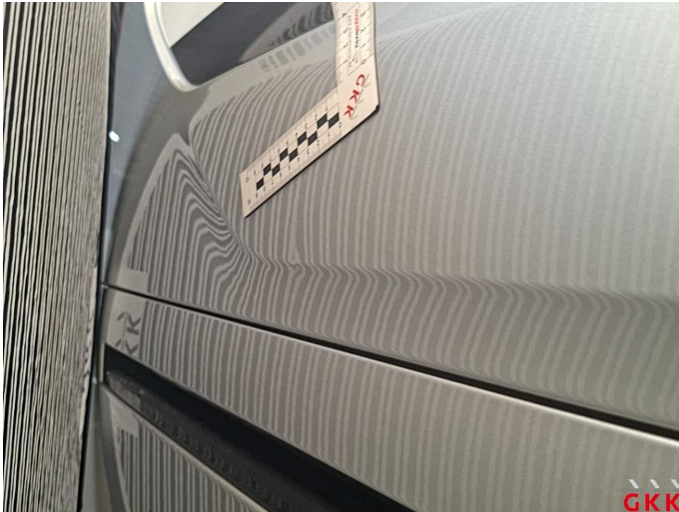
Bild 27 Seitenwand links, beschädigt, instand setzen - lackieren
