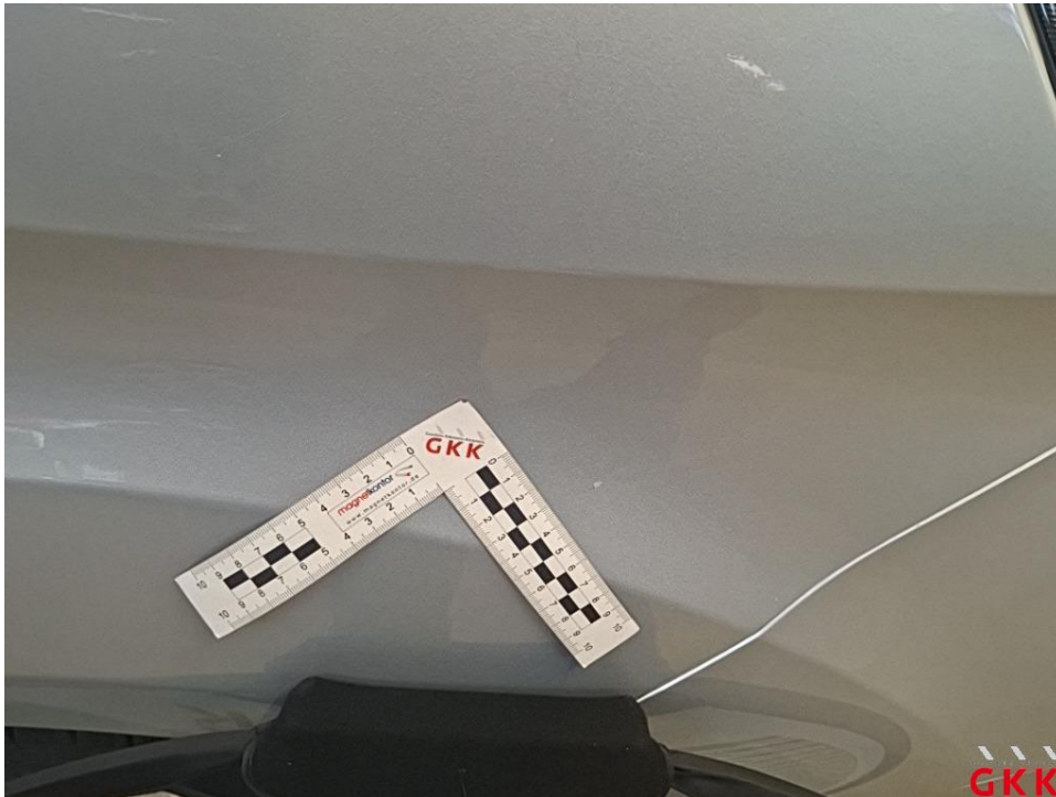
Bild 21 Kotflügel vorne rechts, Steinschlag, lackieren
