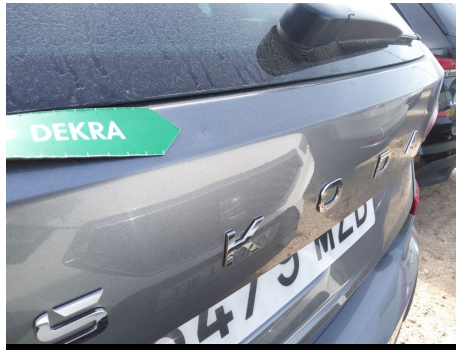
Portón trasero / puerta del maletero / - / Abolladura
