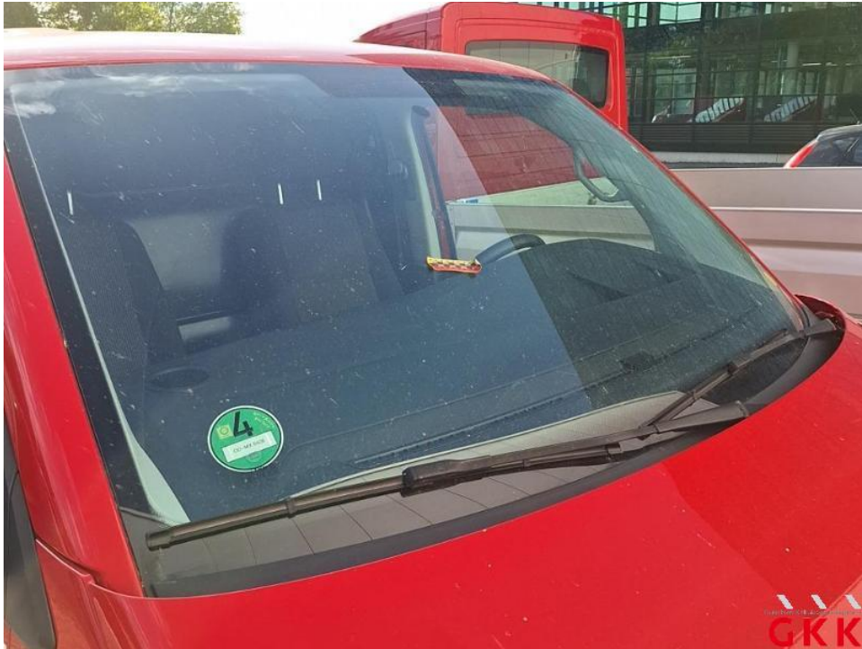
Bild 11. Frontscheibe, Steinschlag mit Rissbildung, ersetzen
