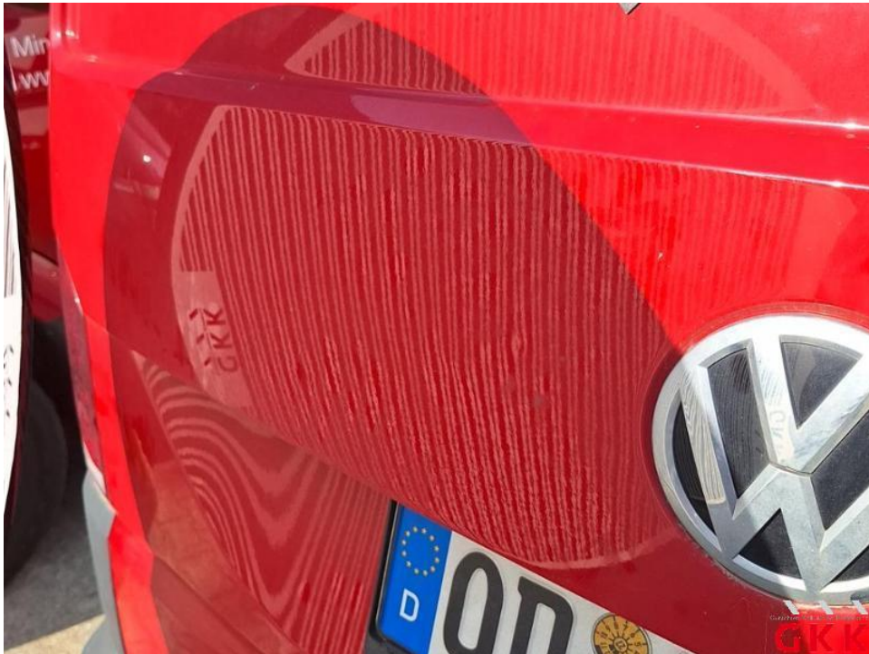
Bild 40. Heckklappe, bis 3 Dellen / Bauteil, kalt drücken
