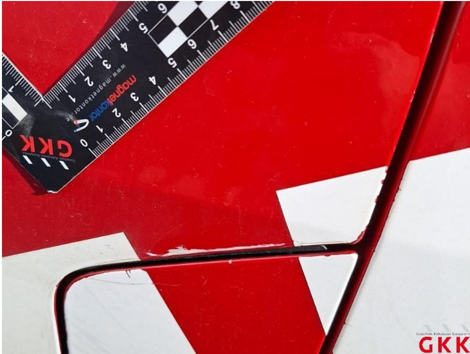
Bild 45. Tür vorne links, verkratzt, lackieren
