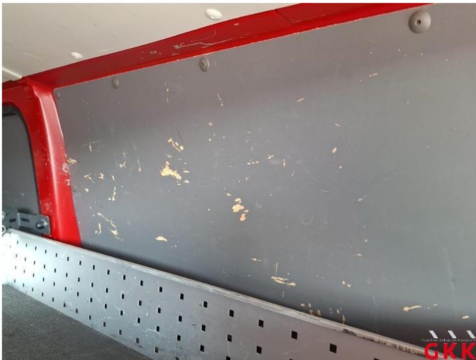
Bild 18. Laderaum, Innenverkleidung (Satz), beschädigt, ersetzen
