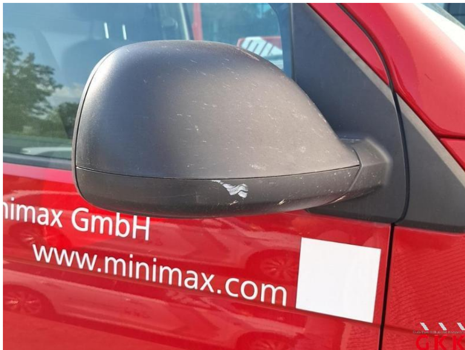
Bild 28. Spiegelgehäuse rechts, Blende -unlackiert-, verkratzt, ersetzen
