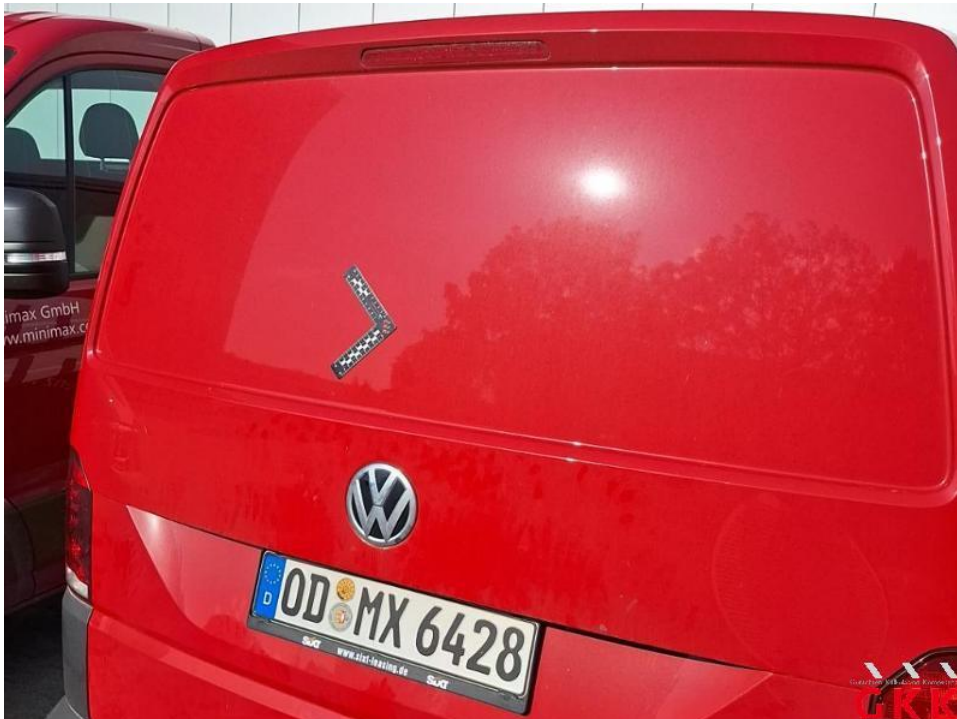
Bild 38. Heckklappe, bis 3 Dellen / Bauteil, kalt drücken
