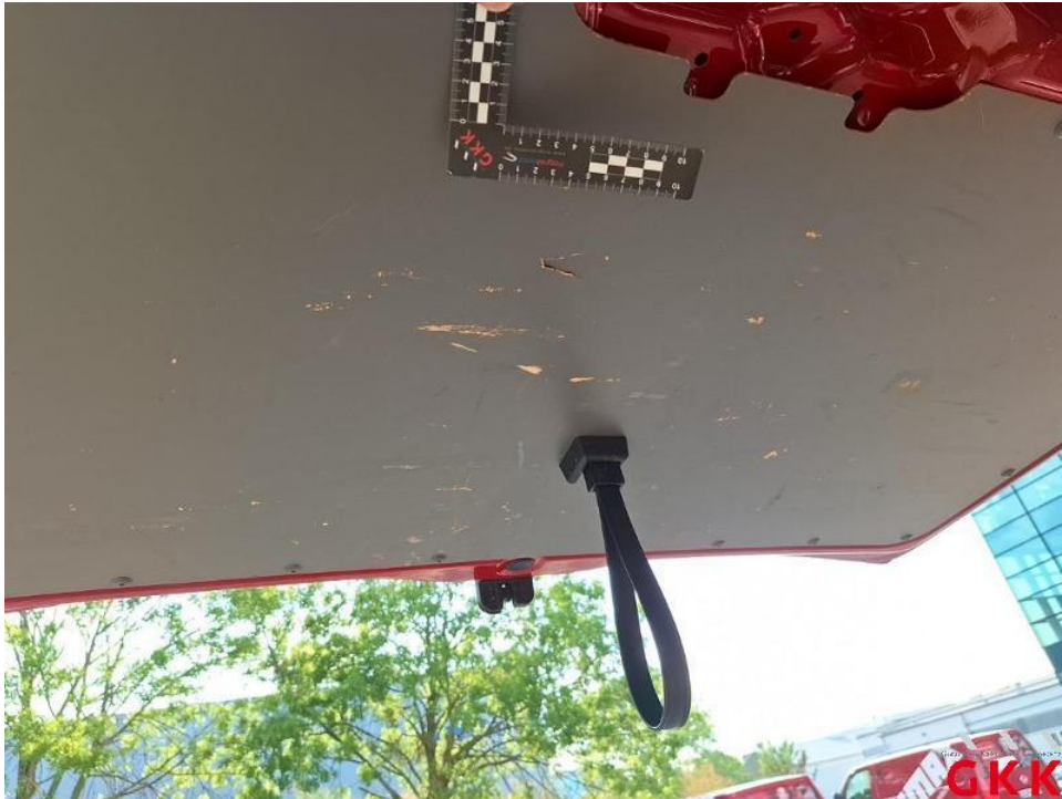
Bild 17. Laderaum, Innenverkleidung (Satz), beschädigt, ersetzen
