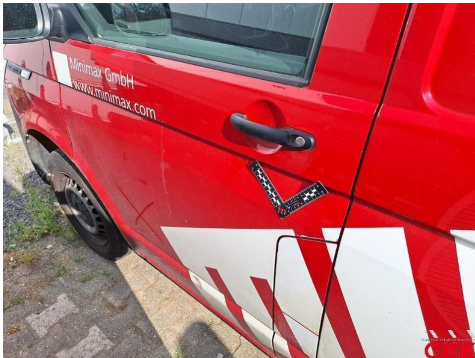
Bild 44. Tür vorne links, verkratzt, lackieren
