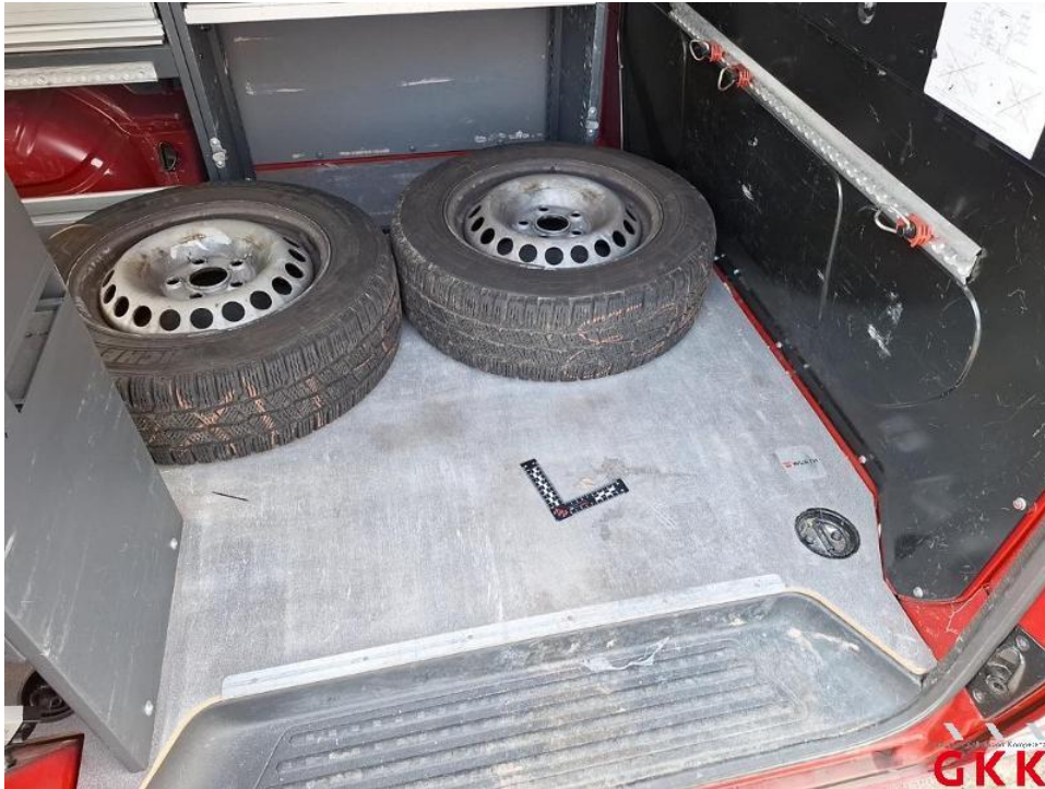
Bild 23. Laderaum, Bodenbelag Holz, beschädigt, ersetzen
