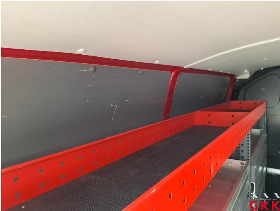
Bild 19. Laderaum, Innenverkleidung (Satz), beschädigt, ersetzen
