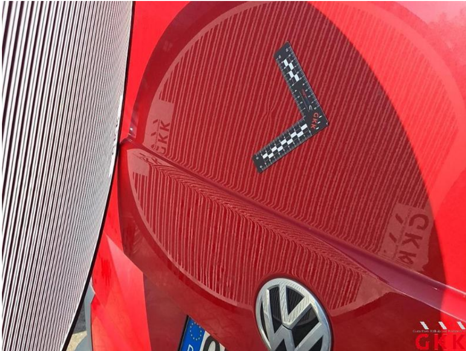
Bild 39. Heckklappe, bis 3 Dellen / Bauteil, kalt drücken
