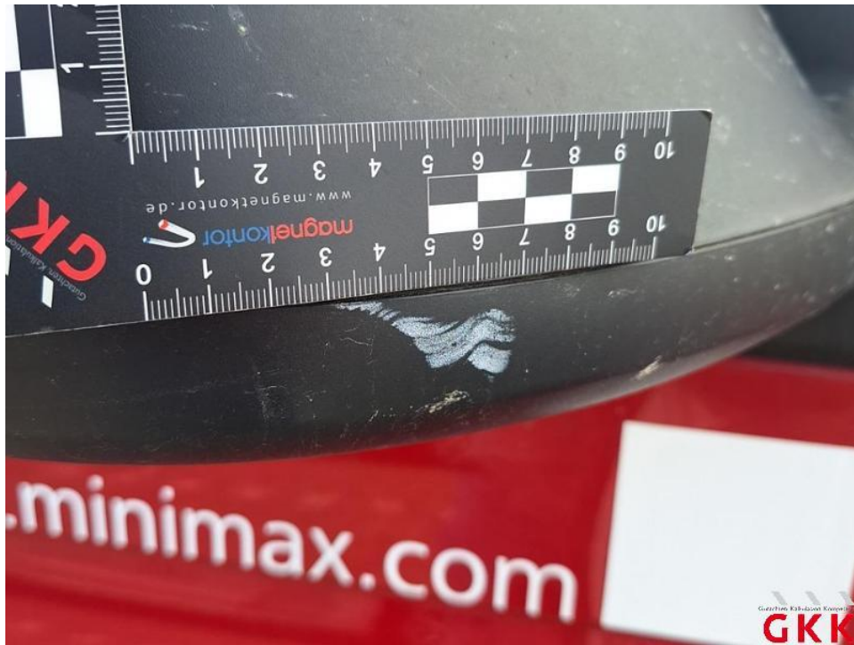
Bild 29. Spiegelgehäuse rechts, Blende -unlackiert-, verkratzt, ersetzen
