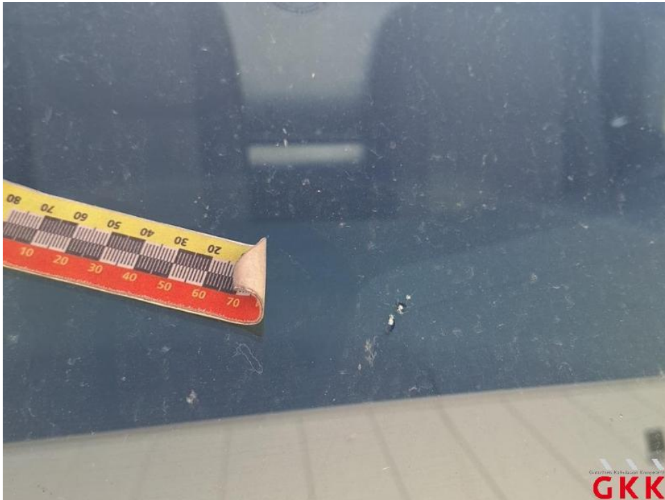
Bild 12. Frontscheibe, Steinschlag mit Rissbildung, ersetzen
