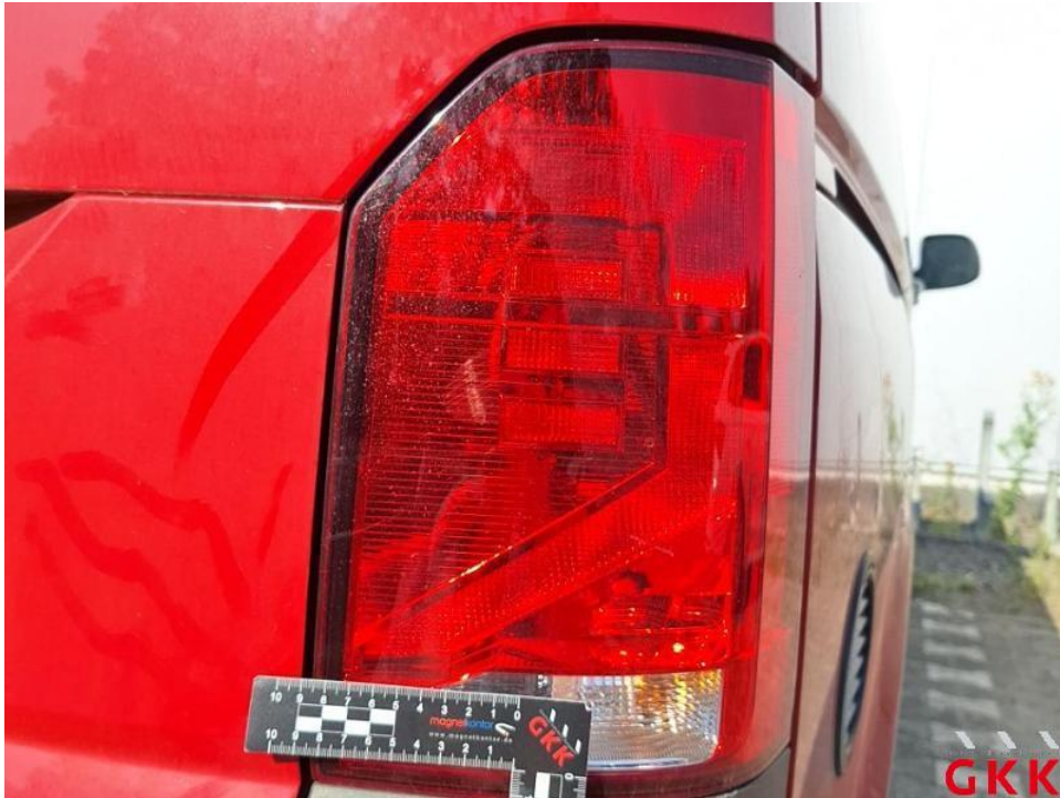
Bild 41. Rückleuchte rechts, außen, verkratzt, ersetzen
