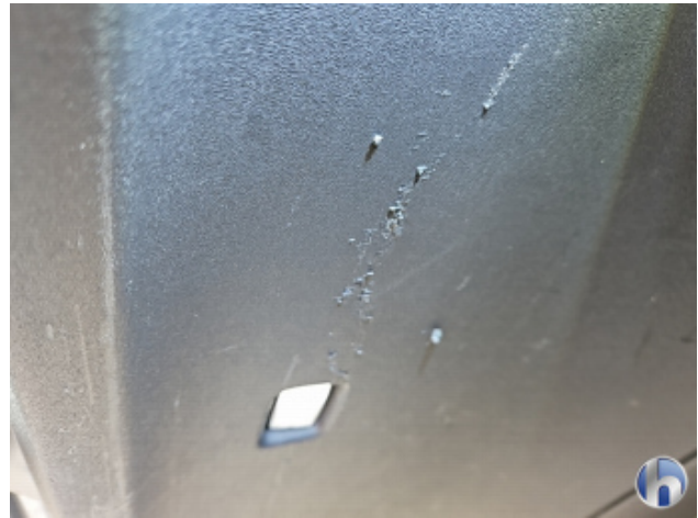
9. Heckklappenverkleidung Beschädigt - Erneuern
