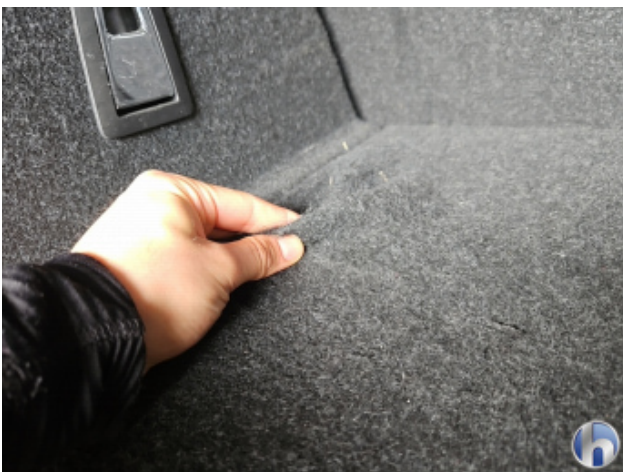
8. Kofferraumbodenbelag Materialabrieb - Erneuern
