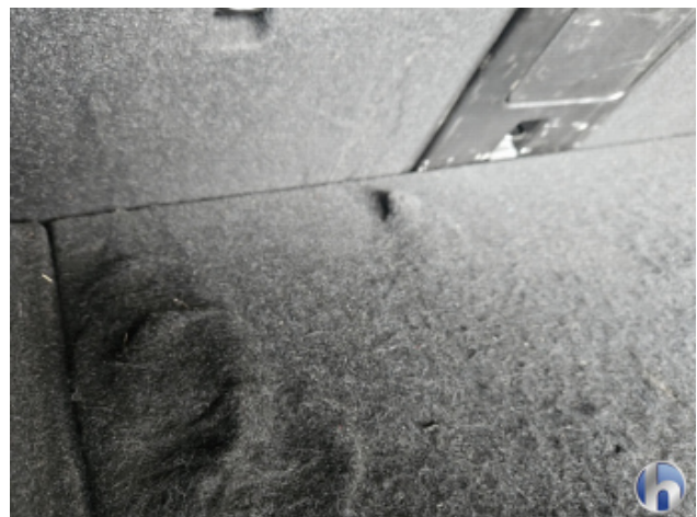
8. Kofferraumbodenbelag Materialabrieb - Erneuern
