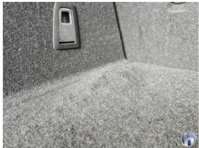
8. Kofferraumbodenbelag Materialabrieb - Erneuern
