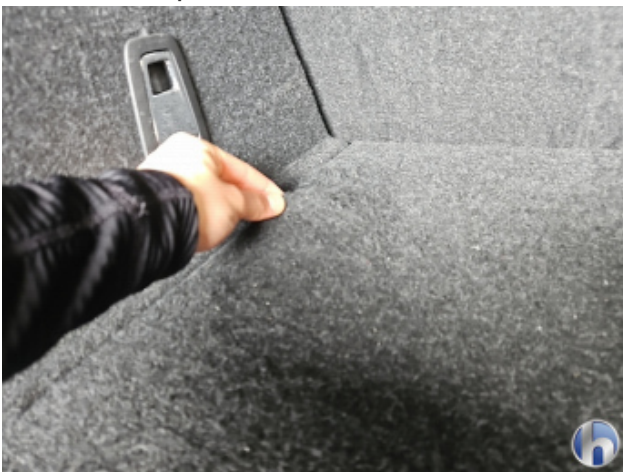
8. Kofferraumbodenbelag Materialabrieb - Erneuern
