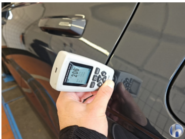
1. Seitenwand - Hinten - Links Nachlackiert - Ohne Reparatur
