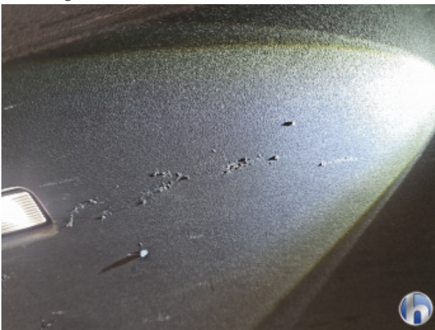
9. Heckklappenverkleidung Beschädigt - Erneuern
