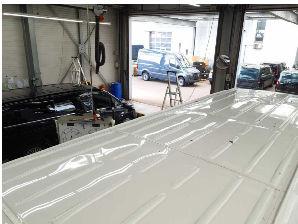
Beschädigung #9: Fahrzeugdach: Dach - verformt - instandsetzen u... lackieren
