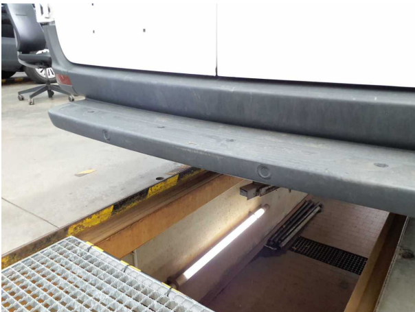
Beschädigung #5: Stossfänger hinten: Verkl. Stossfänger Auftritt mit Parktronic - verkratzt / verschürft - erneuern
