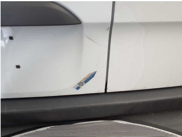
Beschädigung #8: Heckklappe/-tür: Hecktür links - verformt - instandsetzen und lackieren
