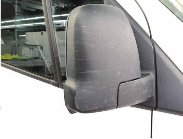
Beschädigung #1: Außenspiegel rechts: Abdeckkappe - verkratzt / verschürft - erneuern
