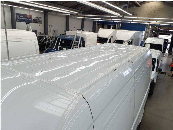
Beschädigung #9: Fahrzeugdach: Dach - verformt - instandsetzen u... lackieren
