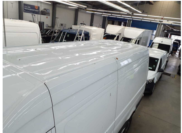
Beschädigung #9: Fahrzeugdach: Dach - verformt - instandsetzen und lackieren
