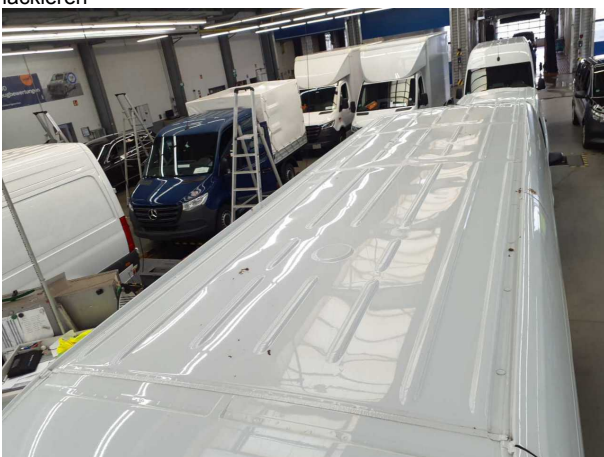
Beschädigung #9: Fahrzeugdach: Dach - verformt - instandsetzen u... lackieren
