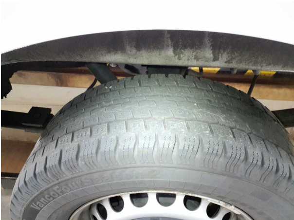
Beschädigung #4: Rad/Reifen: Reifen hinten - verschlissen - erneuern
