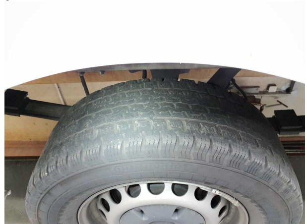
Beschädigung #4: Rad/Reifen: Reifen hinten - verschlissen - erneuern
