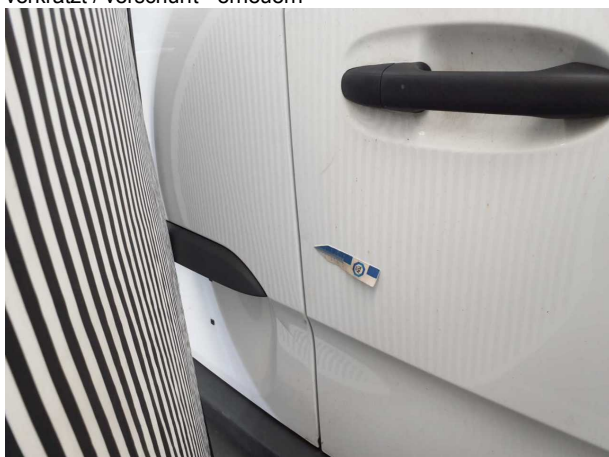
Beschädigung #7: Heckklappe/-tür: Hecktür rechts - verformt - instandsetzen und lackieren
