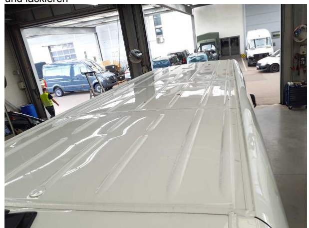
Beschädigung #9: Fahrzeugdach: Dach - verformt - instandsetzen und lackieren
