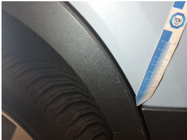
Beschädigung #1: Seitenwand rechts: Radhausverbreiterung - verkratzt / verschürft - erneuern
