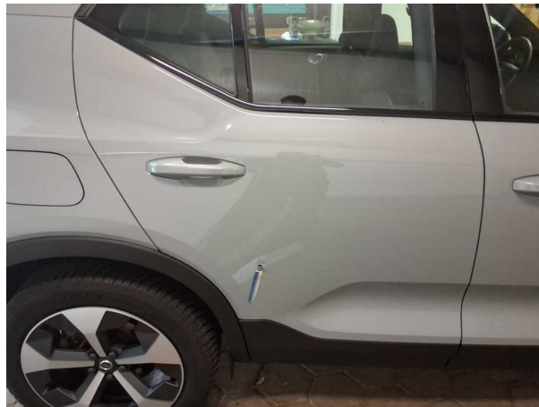
Beschädigung #2: Tür hinten rechts: Tür - Delle / Lackschaden - lackieren
