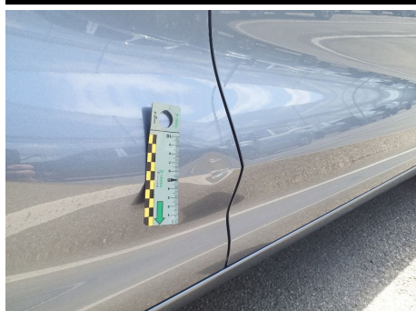
Porta / Posteriore Destro / Ammaccato vernice incisa
