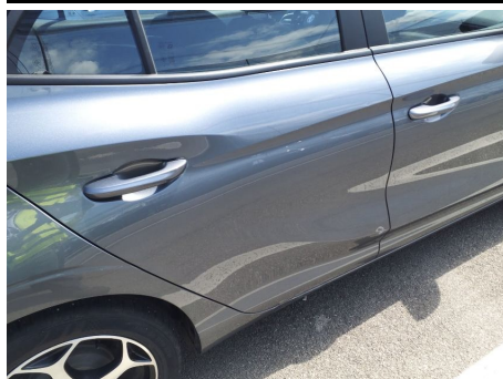
Porta / Posteriore Destro / Ammaccato vernice incisa
