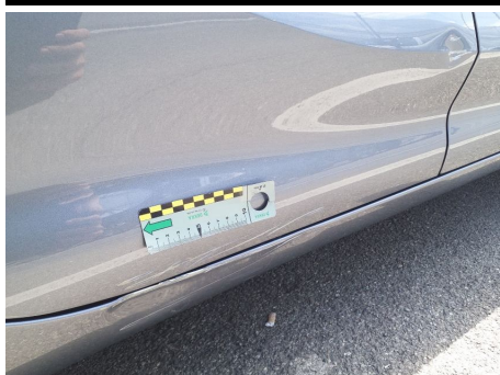
Porta / Posteriore Destro / Ammaccato vernice incisa
