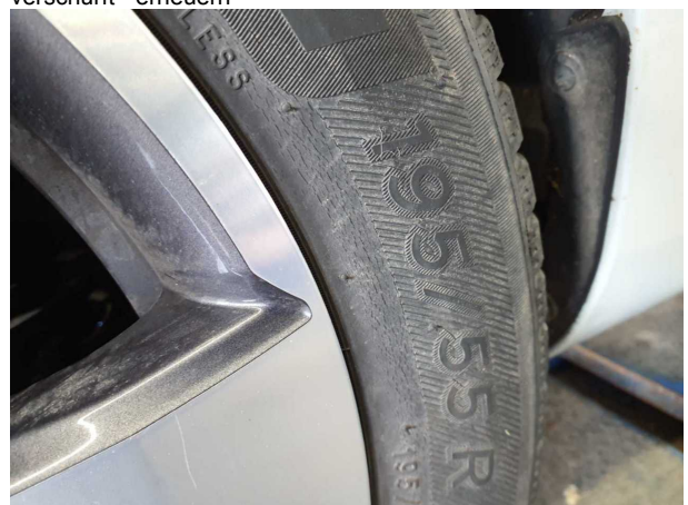
Beschädigung #3: Rad/Reifen: Reifen hinten - porös / rissig - erneuern
