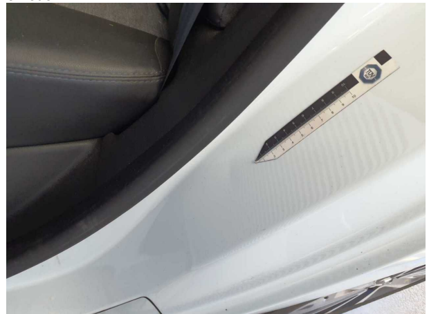
Beschädigung #4: Seitenwand links: Einstieg - Delle(n) - Smart Repair
