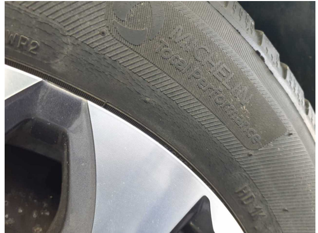
Beschädigung #3: Rad/Reifen: Reifen hinten - porös / rissig - erneuern
