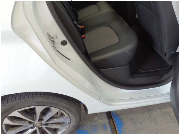
Beschädigung #9: Seitenwand rechts: Einstieg - Delle / Lackschade... Smart Repair
