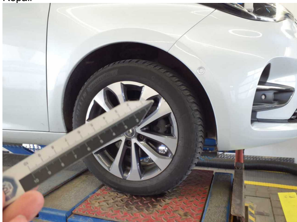
Beschädigung #7: Rad/Reifen: Leichtmetallfelge vorn rechts - Kratz... Wertminderung
