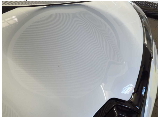
Beschädigung #12: Karosserie: Karosserie - Hagelschaden - instandsetzen
