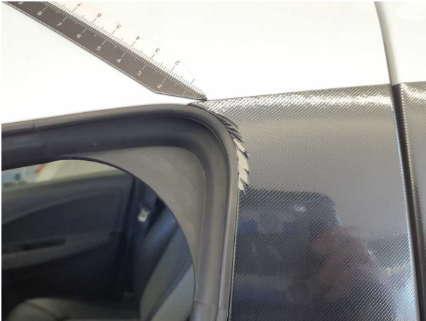
Beschädigung #10: Tür vorn links: Tür (Folie) - beschädigt - erneuern
