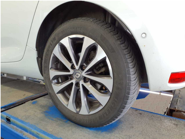
Beschädigung #3: Rad/Reifen: Reifen hinten - porös / rissig - erneuern
