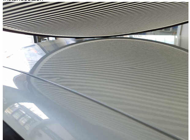
Beschädigung #12: Karosserie: Karosserie - Hagelschaden - instandsetzen
