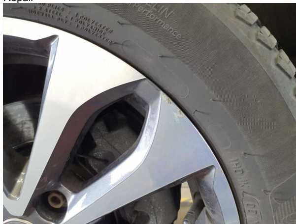
Beschädigung #7: Rad/Reifen: Leichtmetallfelge vorn rechts - Kratzer - Wertminderung
