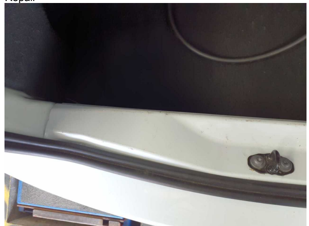
Beschädigung #5: Karosserie: Karosserie (Ladekante) - Kratzer - Smart Repair
