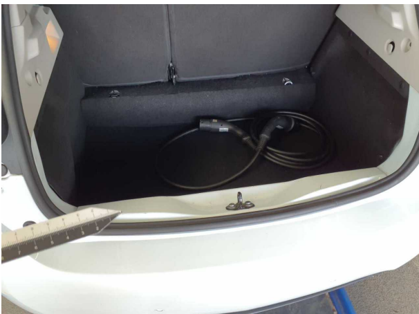
Beschädigung #5: Karosserie: Karosserie (Ladekante) - Kratzer - Smart Repair
