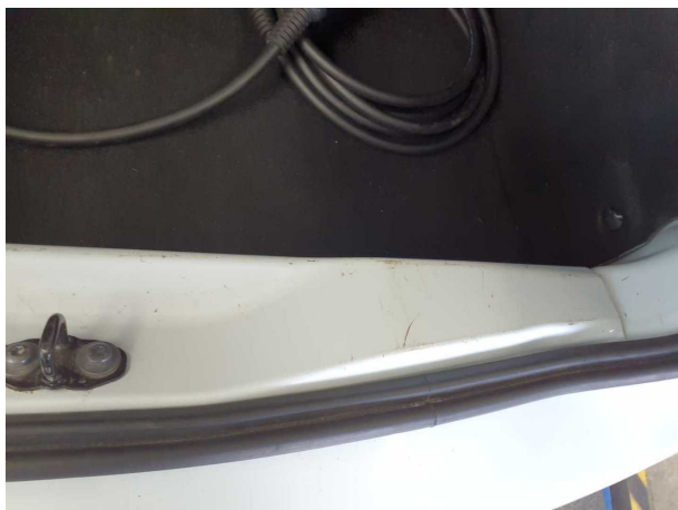
Beschädigung #5: Karosserie: Karosserie (Ladekante) - Kratzer - Smart Repair
