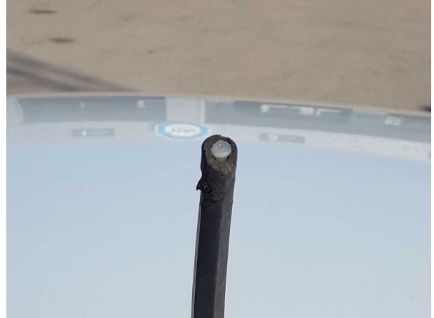
Beschädigung #1: Fahrzeugdach: Antennenstab - Marderschaden - erneuern
