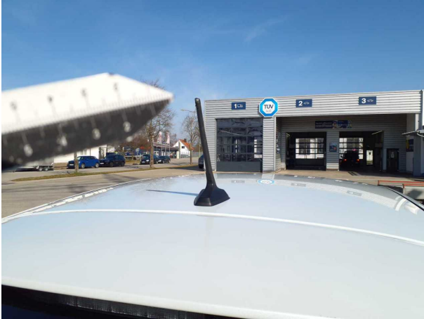
Beschädigung #1: Fahrzeugdach: Antennenstab - Marderschaden - erneuern
