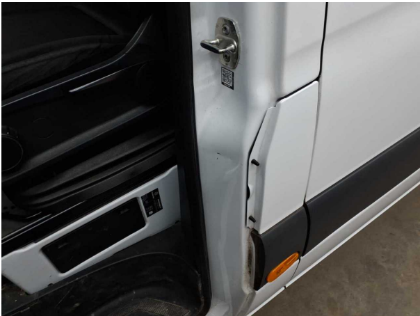
Beschädigung #9: Karosserie: B-Säule links - Delle / Lackschaden - instandsetzen und lackieren
