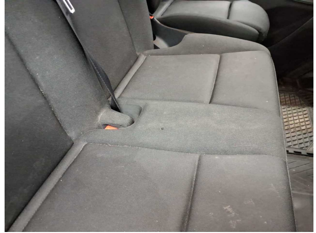
Beschädigung #2: Sitz vorn: Sitzbezug rechts (2er) - Brandloch - Smart Repair
