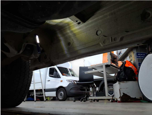
Beschädigung #11: Schweller links: Schweller - verformt - instandsetzen und lackieren
