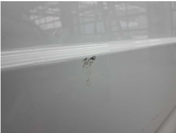
Beschädigung #4: Schiebetür rechts: Schiebetür - Delle / Lackschad... - Smart Repair
