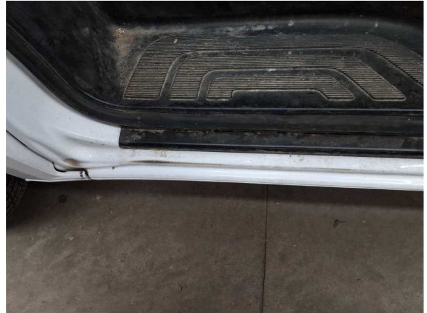
Beschädigung #8: Schweller links: Einstieg - verkratzt / verschürft - lackieren
