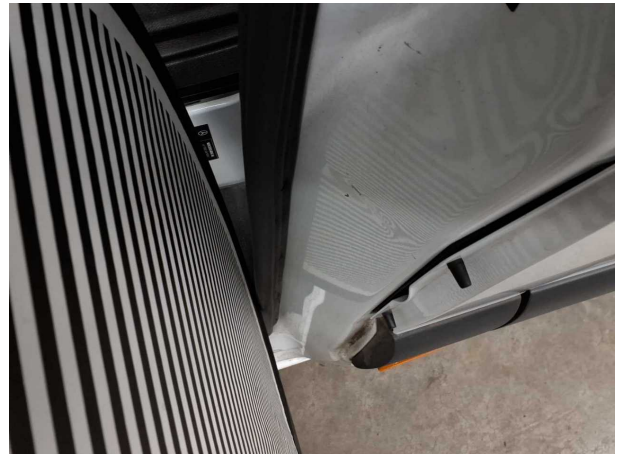
Beschädigung #9: Karosserie: B-Säule links - Delle / Lackschad... - instandsetzen und lackieren
