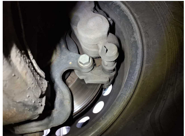
Beschädigung #12: Bremsanlage: Bremsscheiben und Beläge vorn - verschlissen - erneuern
