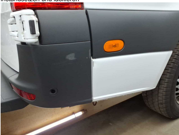
Beschädigung #10: Seitenwand rechts: Seitenwand (Bepankung unten hinten) - Delle / Lackschaden - instandsetzen und lackieren
