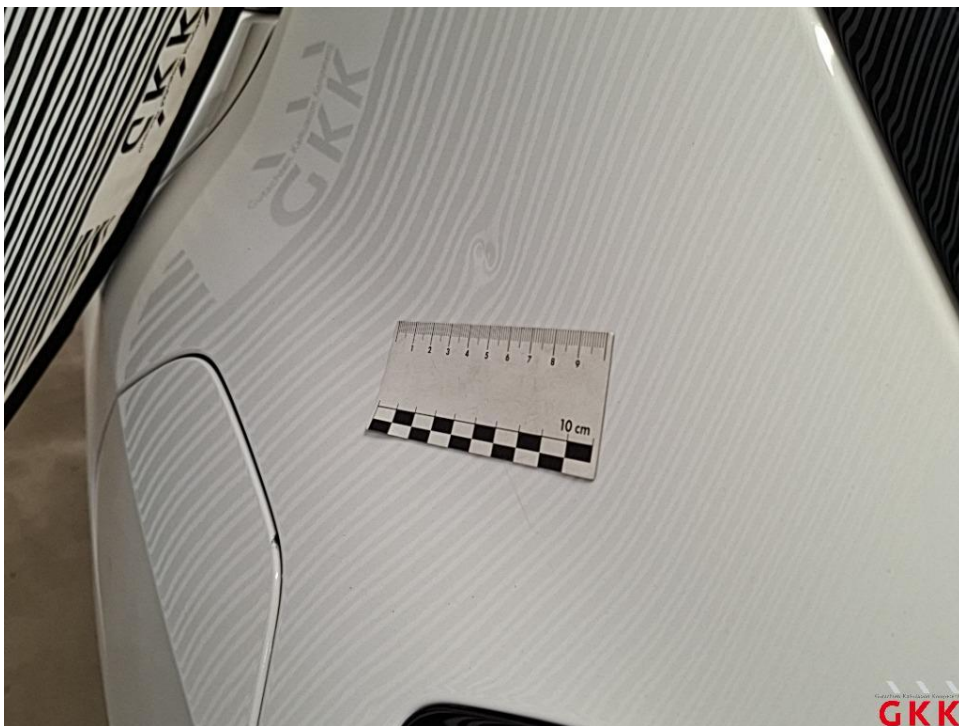
Bild 28 Seitenwand links, beschädigt, instand setzen - lackieren
