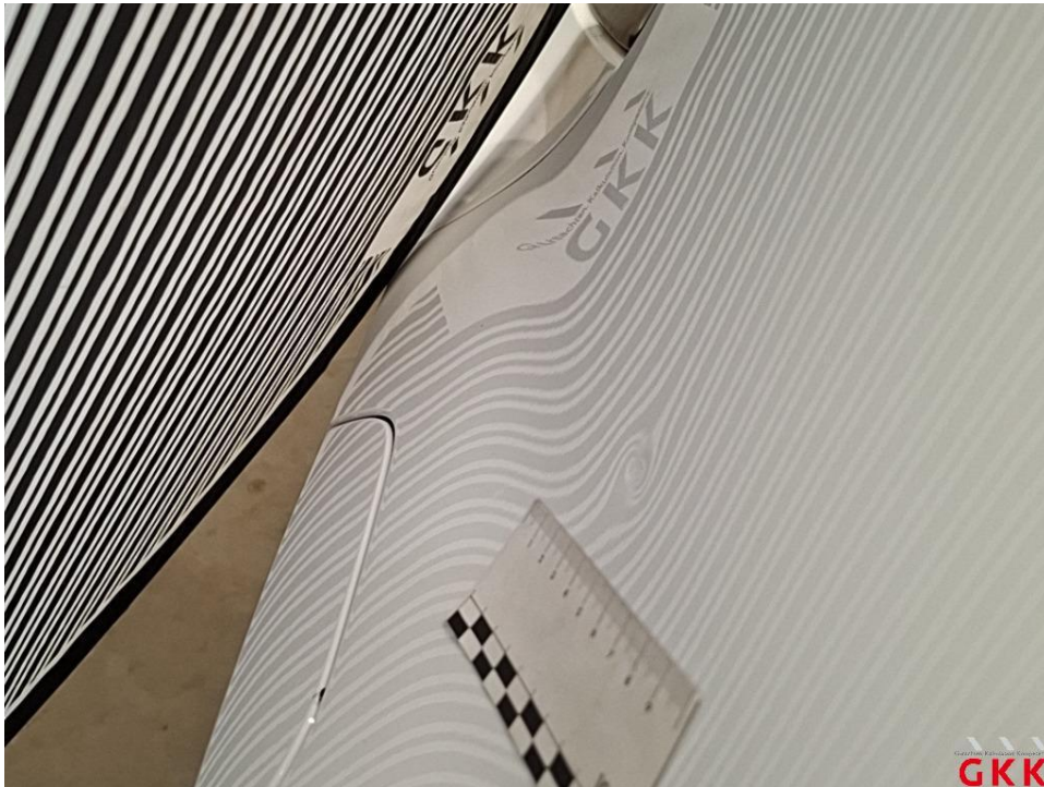
Bild 29 Seitenwand links, beschädigt, instand setzen - lackieren
