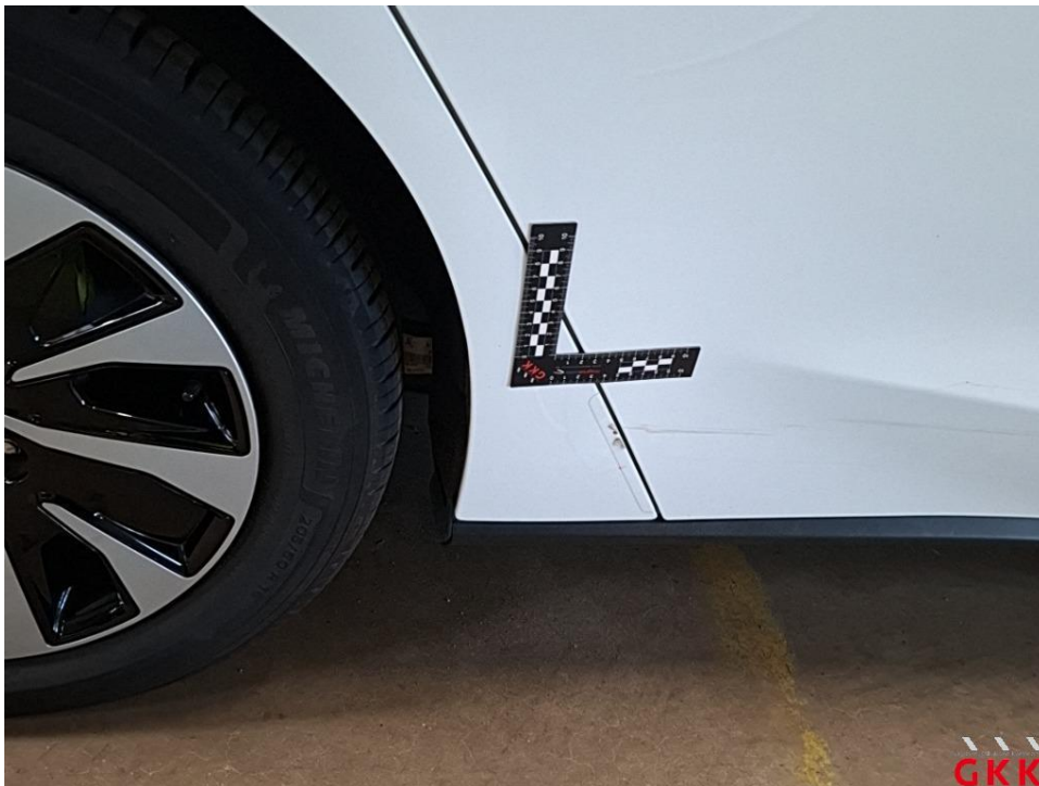
Bild 20 Seitenwand rechts, eingedellt und verkratzt (I), Smartrepair
