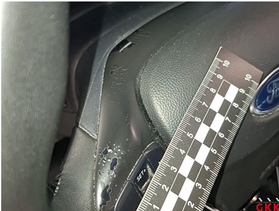
Bild 16 Lenkrad, Blende, beschädigt, ersetzen
