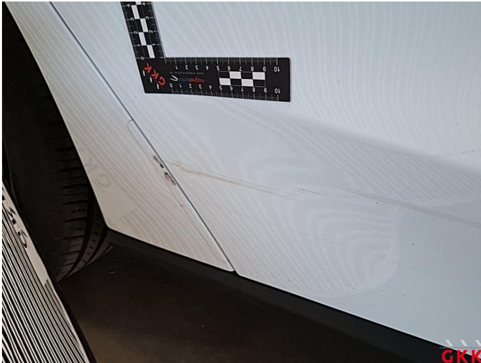
Bild 23 Tür hinten rechts, eingedellt und verkratzt (I), Smartrepair
