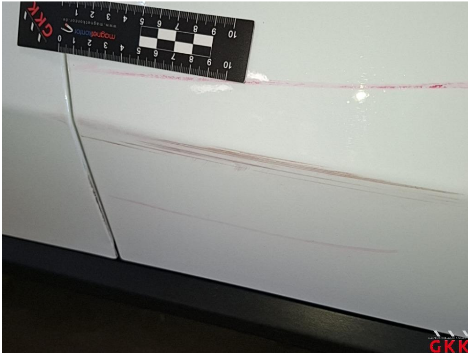
Bild 19 Tür vorne rechts, verkratzt, lackieren
