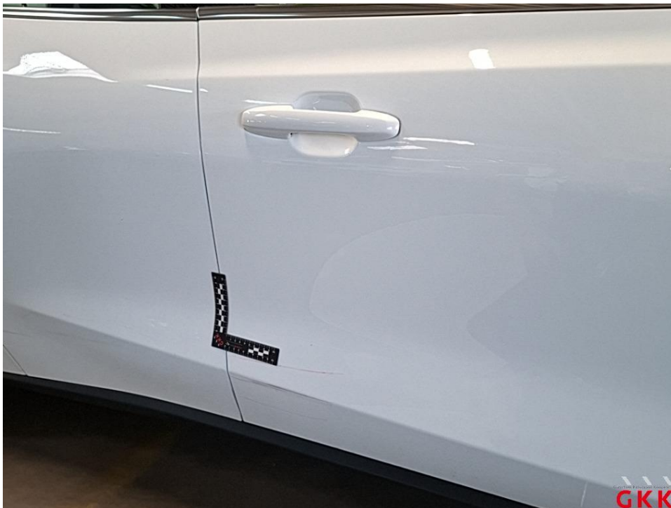
Bild 18 Tür vorne rechts, verkratzt, lackieren
