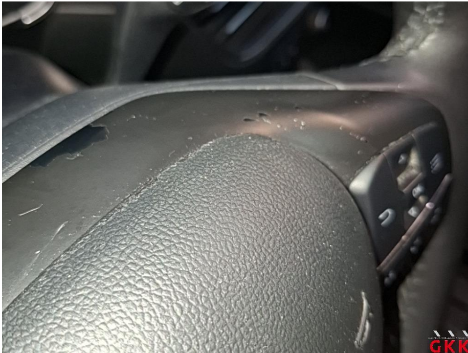
Bild 17 Lenkrad, Blende, beschädigt, ersetzen
