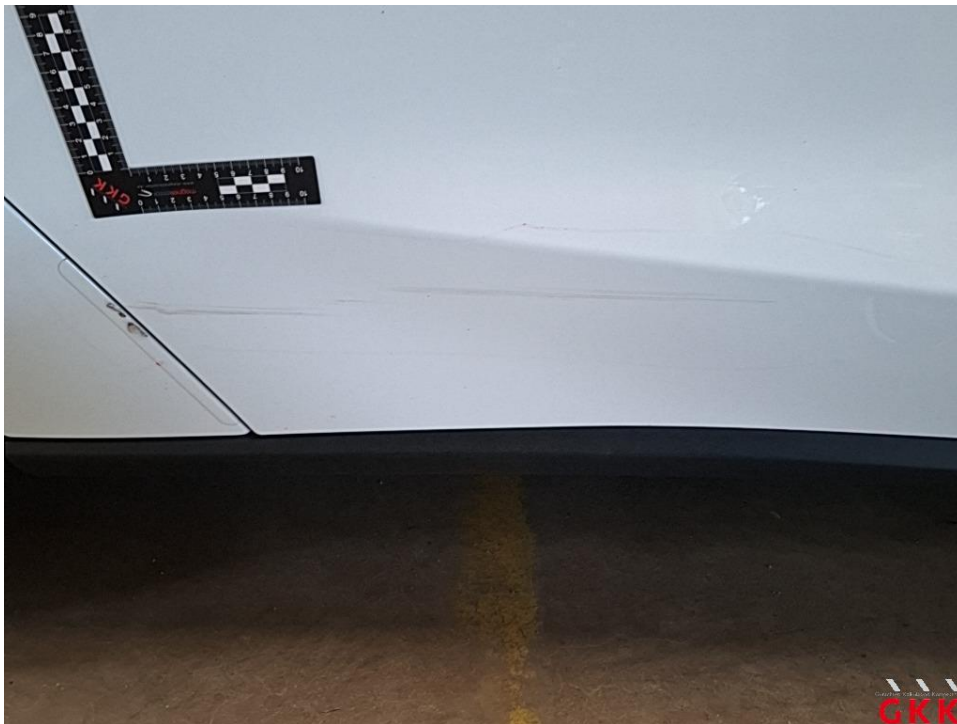
Bild 24 Tür hinten rechts, eingedellt und verkratzt (I), Smartrepair
