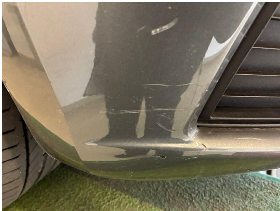
Bild 16 : Stoßfänger vorne Kratzer + Dellen
