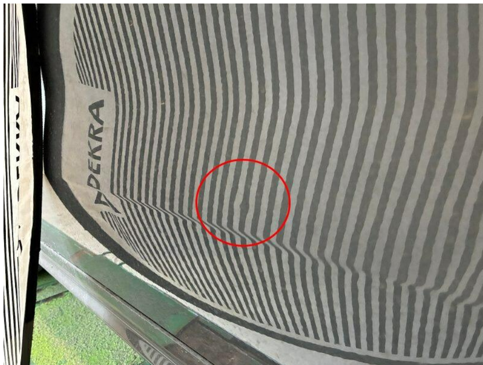
Bild 30 : Türe vorne links Kratzer + Delle
