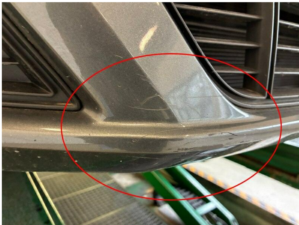
Bild 15 : Stoßfänger vorne Kratzer + Dellen
