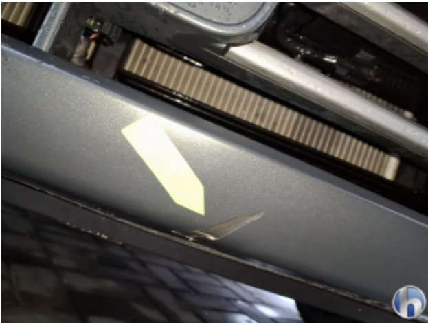
1. Stoßfänger Vorne Kratzer - Erneuern
