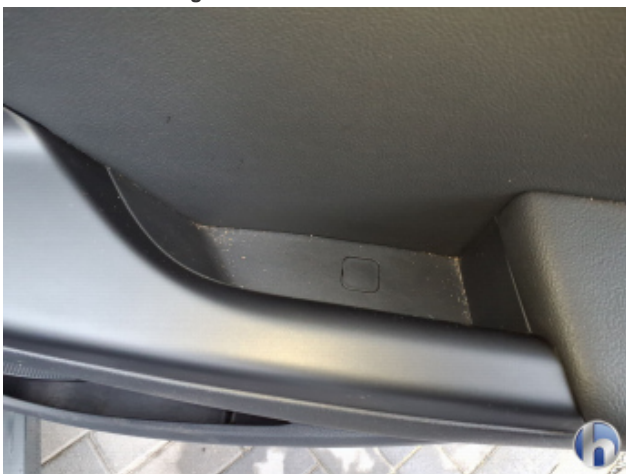
5. Verkleidung Verschmutzt - Reinigen
