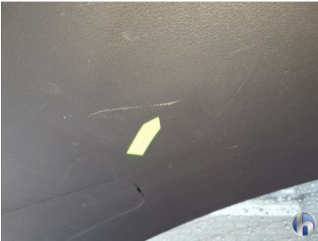
6. Heckklappenverkleidung Kratzer - Erneuern
