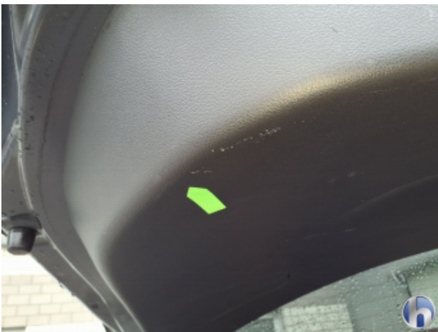
6. Heckklappenverkleidung Kratzer - Erneuern
