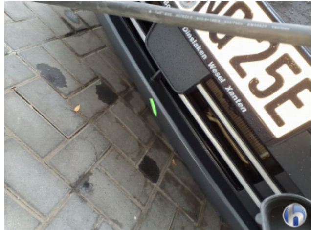
1. Stoßfänger Vorne Kratzer - Erneuern
