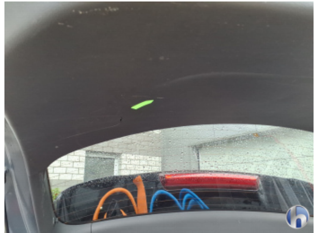
6. Heckklappenverkleidung Kratzer - Erneuern
