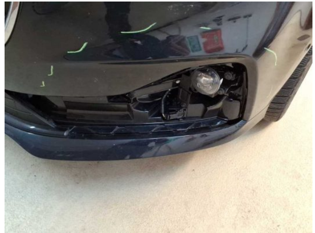
Beschädigung #16: Stossfänger vorn: Stossfänger vorn - beschädigt - erneuern
