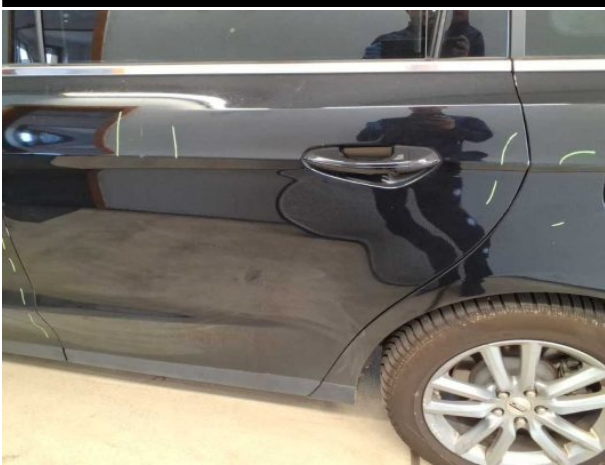
Beschädigung #8: Tür hinten links: Tür - verkratzt / verschürft - instandsetzen und lackieren
