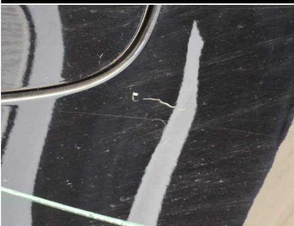
Beschädigung #13: Seitenwand links: Seitenwand - verkratzt / verschürft - instandsetzen und lackieren
