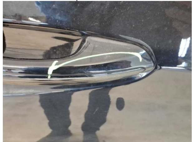
Beschädigung #4: Tür vorn rechts: Griff außen - verkratzt / verschürft - Smart Repair
