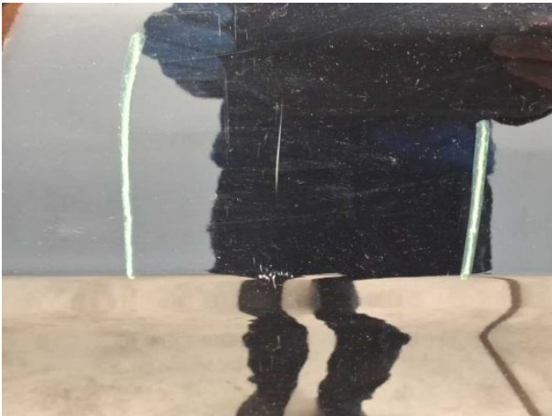
Beschädigung #8: Tür hinten links: Tür - verkratzt / verschürft - instandsetzen und lackieren
