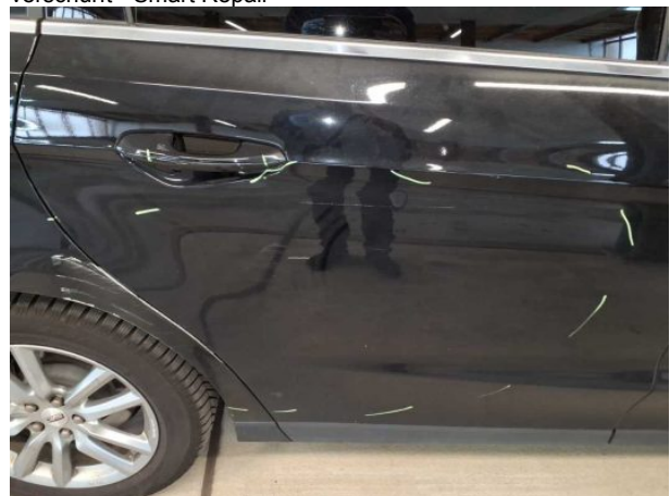
Beschädigung #5: Tür hinten rechts: Griff außen - verkratzt / verschürft - Smart Repair
