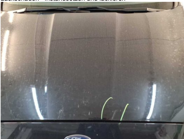
Beschädigung #15: Motorhaube: Motorhaube - verkratzt / verschürft - instandsetzen und lackieren
