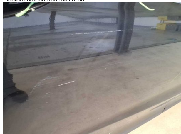
Beschädigung #9: Tür hinten rechts: Tür - verkratzt / versch... - instandsetzen und lackieren
