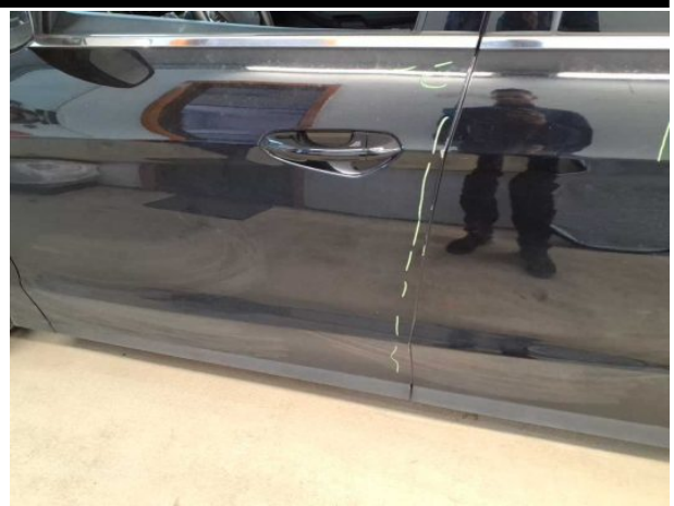
Beschädigung #11: Tür vorn links: Tür - verkratzt / verschürft - instandsetzen und lackieren
