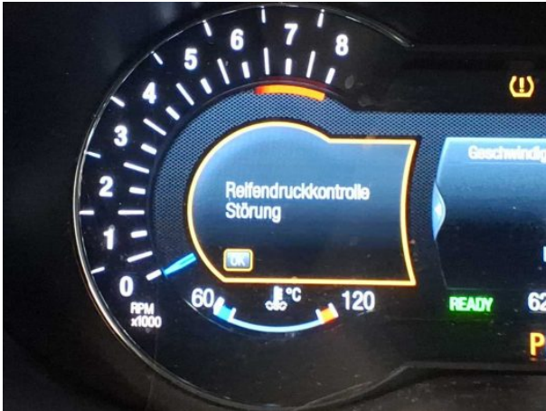
Beschädigung #2: Instrumententafel: Kontrollleuchte (RDKS brennt) - abweichend Auslieferungszustand - Diagnose durchführen
