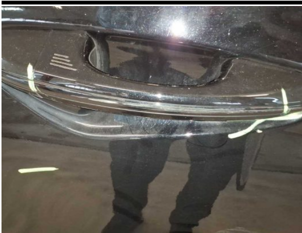
Beschädigung #5: Tür hinten rechts: Griff außen - verkratzt / verschürft - Smart Repair
