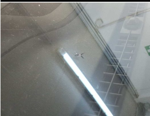
Beschädigung #10: Verglasung: Frontscheibe - Steinschlag - erneuern
