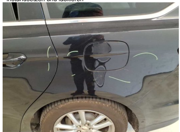
Beschädigung #13: Seitenwand links: Seitenwand - verkratzt / verschürft - instandsetzen und lackieren
