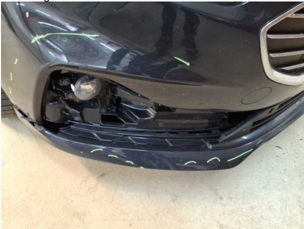
Beschädigung #16: Stossfänger vorn: Stossfänger vorn - beschädigt - erneuern
