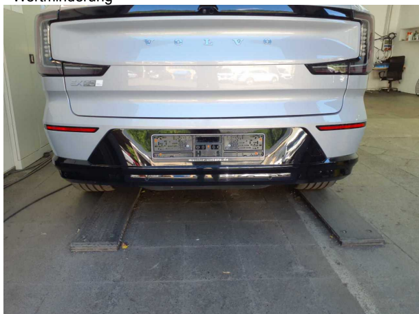
Beschädigung #3: Stossfänger hinten: Spoiler - Kratzer - instandsetzen und lackieren
