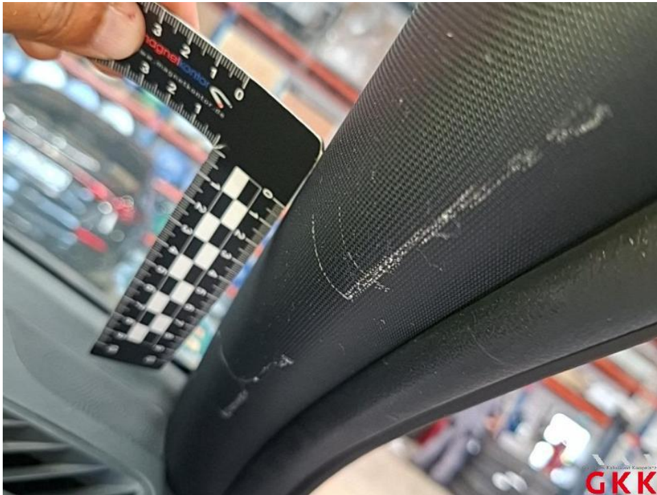
Bild 45. A- Säule rechts, Innenverkleidung, verkratzt, ersetzen
