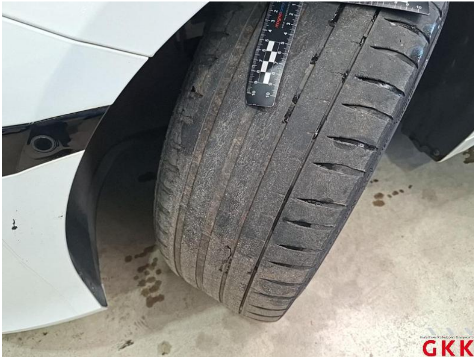
Bild 20. Reifen, vorn links und rechts, beschädigt und Untermaß, ersetzen
