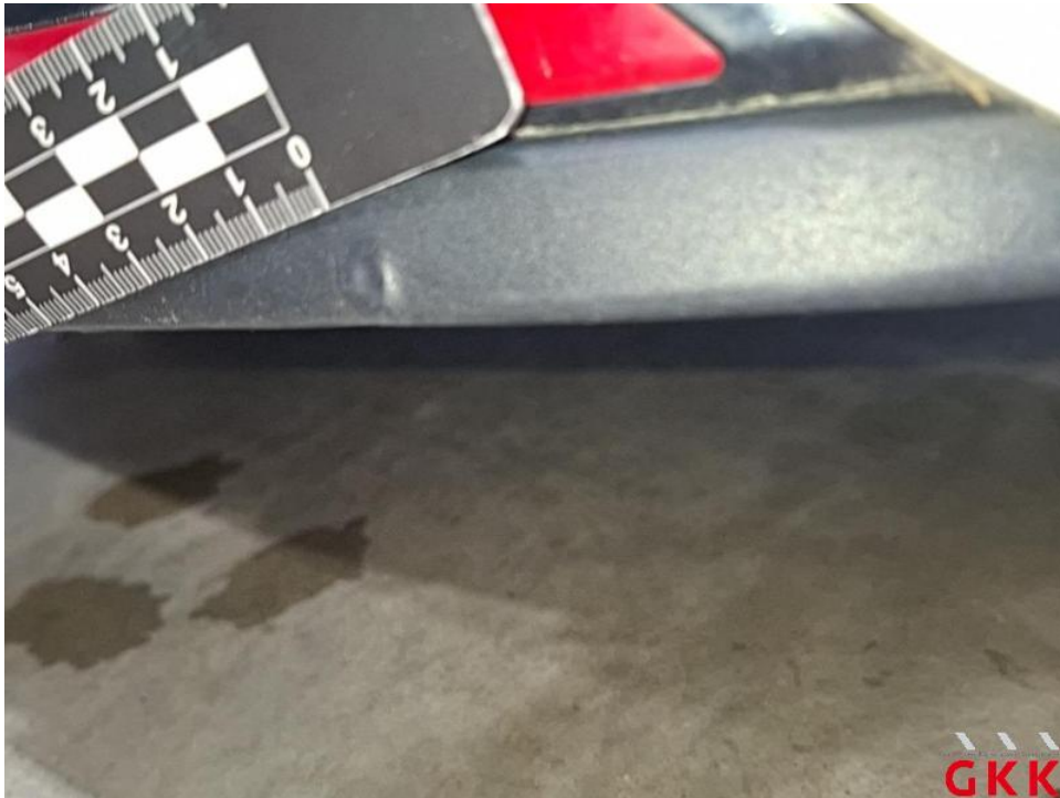
Bild 27. Stoßfänger vorne, Spoiler -unlackiert-, beschädigt, ersetzen
