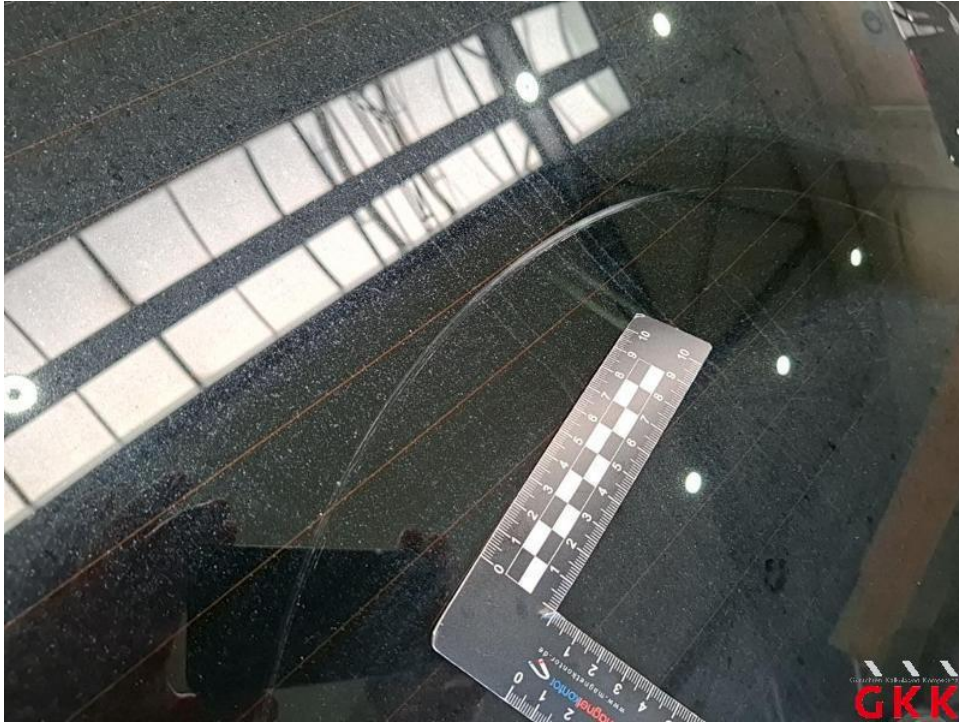
Bild 19. Heckscheibe, getönt, verkratzt, ersetzen
