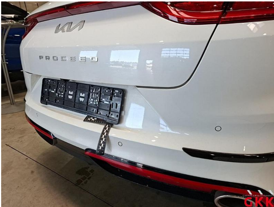
Bild 28. Stoßfänger hinten, Verkleidung -lackiert-, beschädigt, instand setzen - lackieren
