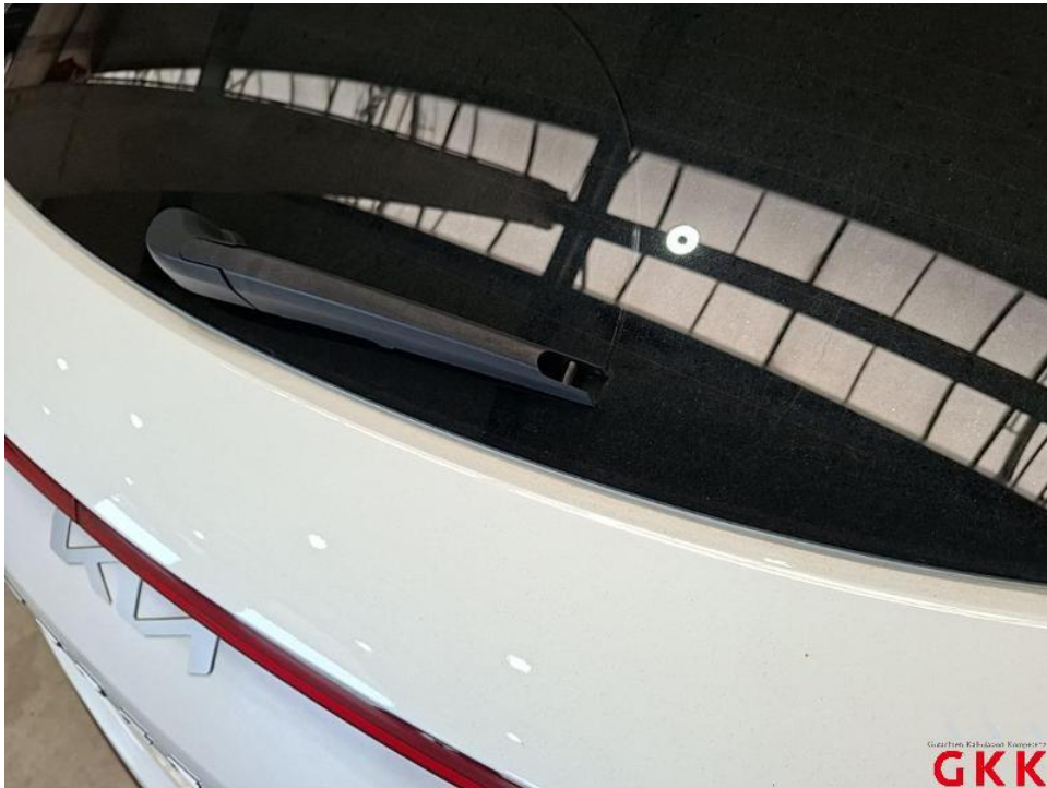
Bild 17. Heckwischer, Blatt, fehlt, ersetzen
