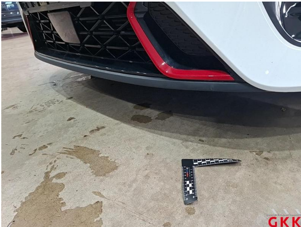
Bild 26. Stoßfänger vorne, Spoiler -unlackiert-, beschädigt, ersetzen
