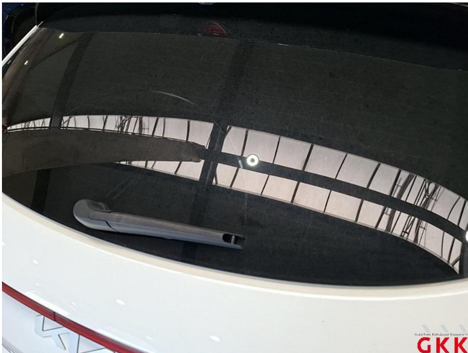
Bild 18. Heckscheibe, getönt, verkratzt, ersetzen
