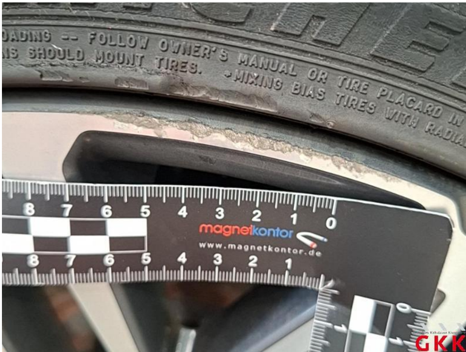
Bild 32. LM-Rad, hinten rechts, Materialabtrag, ersetzen
