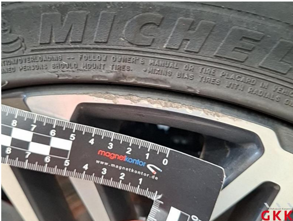
Bild 34. Reifen, hinten rechts, beschädigt, ersetzen
