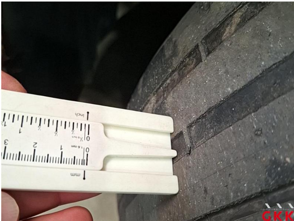
Bild 22. Reifen, vorn links und rechts, beschädigt und Untermaß, ersetzen
