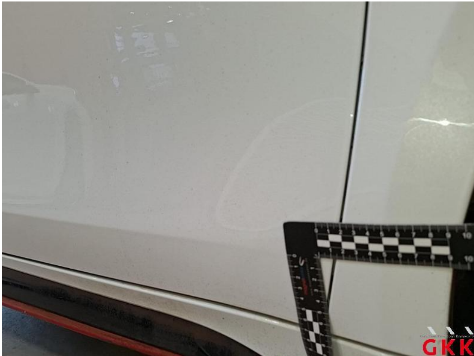
Bild 47. Fahrzeug, außen, Industriestaubhaftung / Flugrost, aufbereiten
