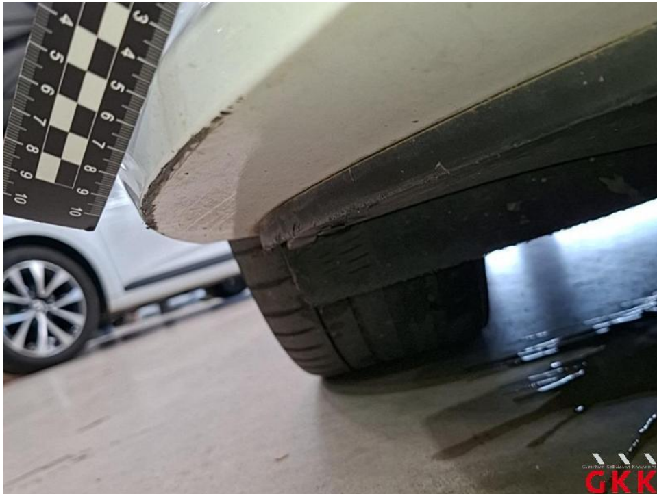
Bild 24. Stoßfänger vorne, Verkleidung -lackiert-, beschädigt, instand setzen - lackieren
