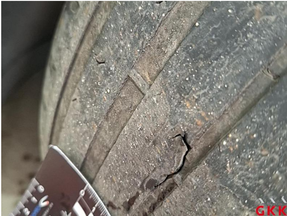
Bild 21. Reifen, vorn links und rechts, beschädigt und Untermaß, ersetzen
