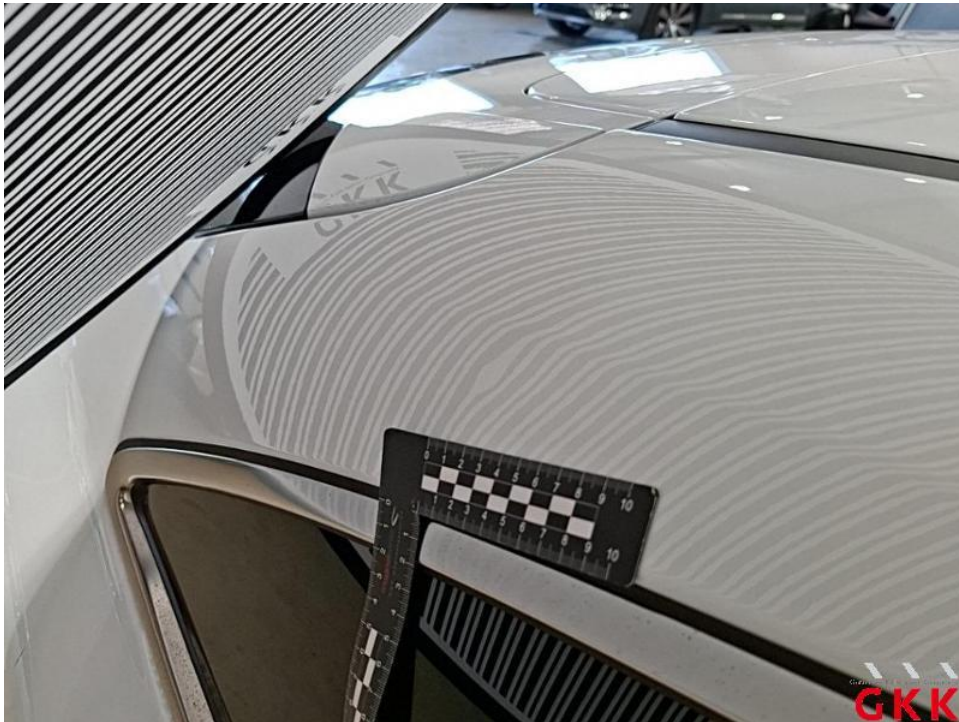
Bild 43. Dach, Holm rechts, beschädigt, kalt drücken
