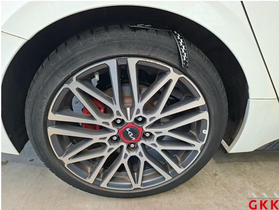
Bild 31. LM-Rad, hinten rechts, Materialabtrag, ersetzen
