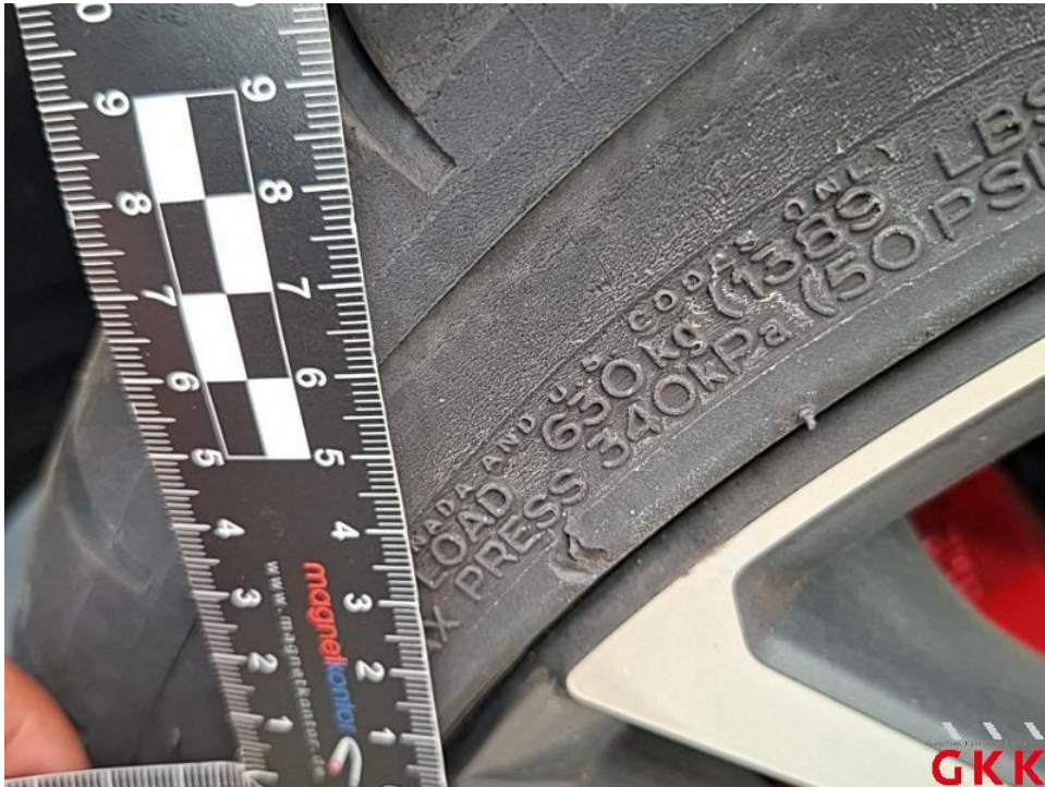
Bild 35. Reifen, hinten rechts, beschädigt, ersetzen
