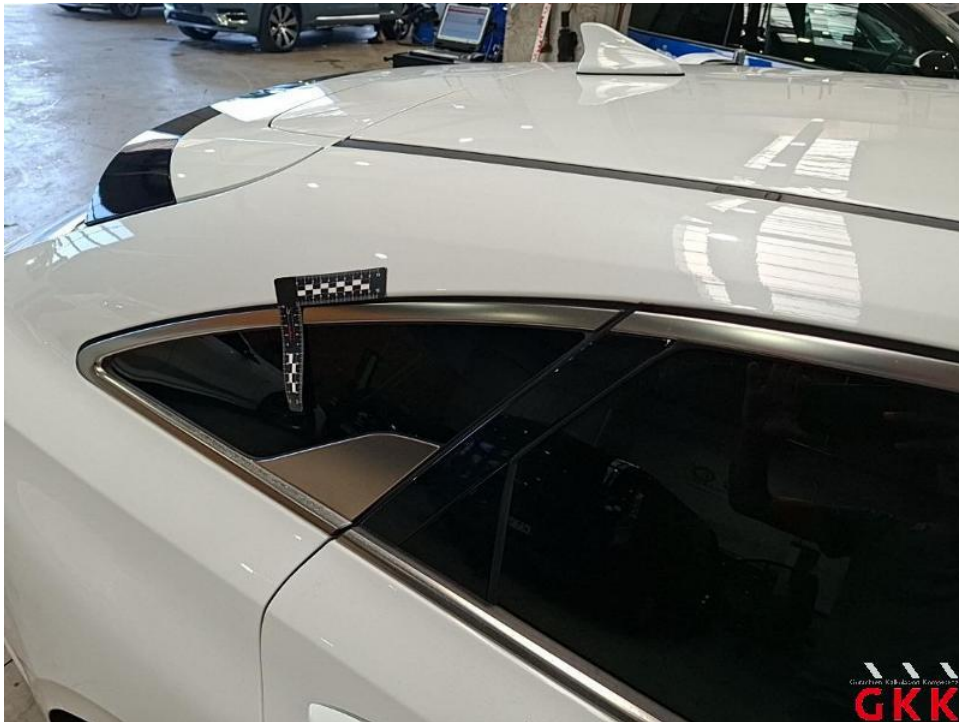
Bild 42. Dach, Holm rechts, beschädigt, kalt drücken
