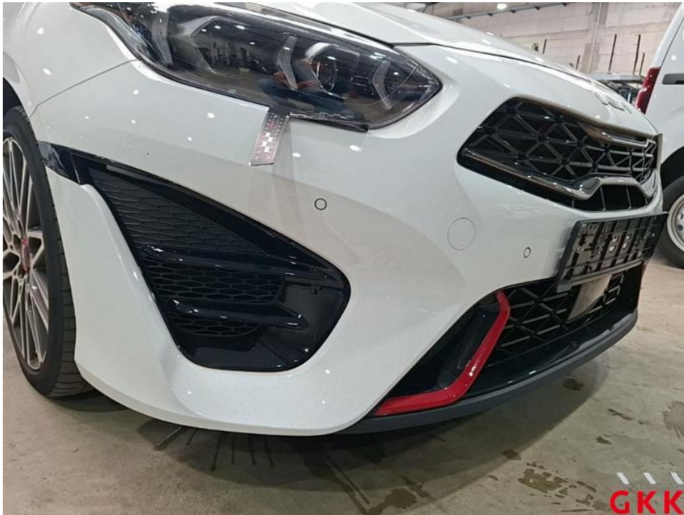
Bild 23. Stoßfänger vorne, Verkleidung -lackiert-, beschädigt, instand setzen - lackieren
