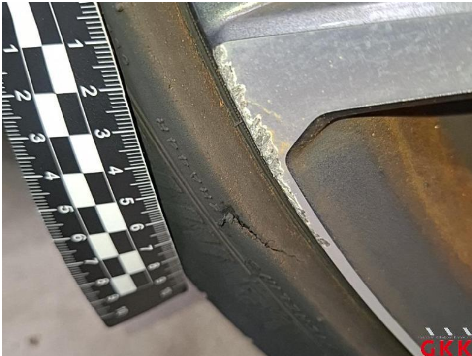
Bild 40. LM-Rad, vorne rechts, Materialabtrag, ersetzen
