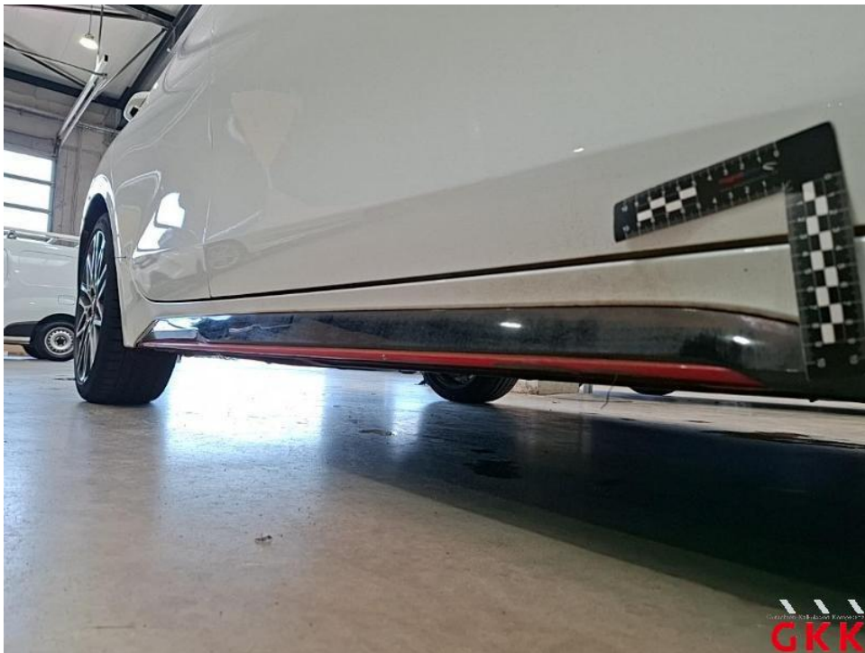
Bild 36. Schweller rechts, Verkleidung -lackiert-, beschädigt, ersetzen
