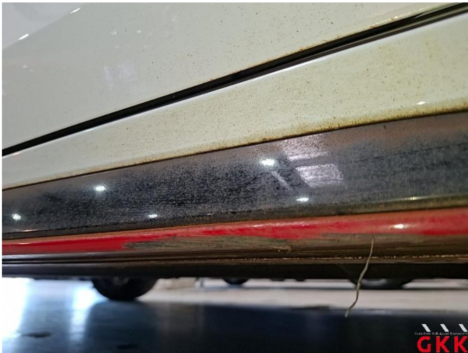
Bild 38. Schweller rechts, Verkleidung -lackiert-, beschädigt, ersetzen
