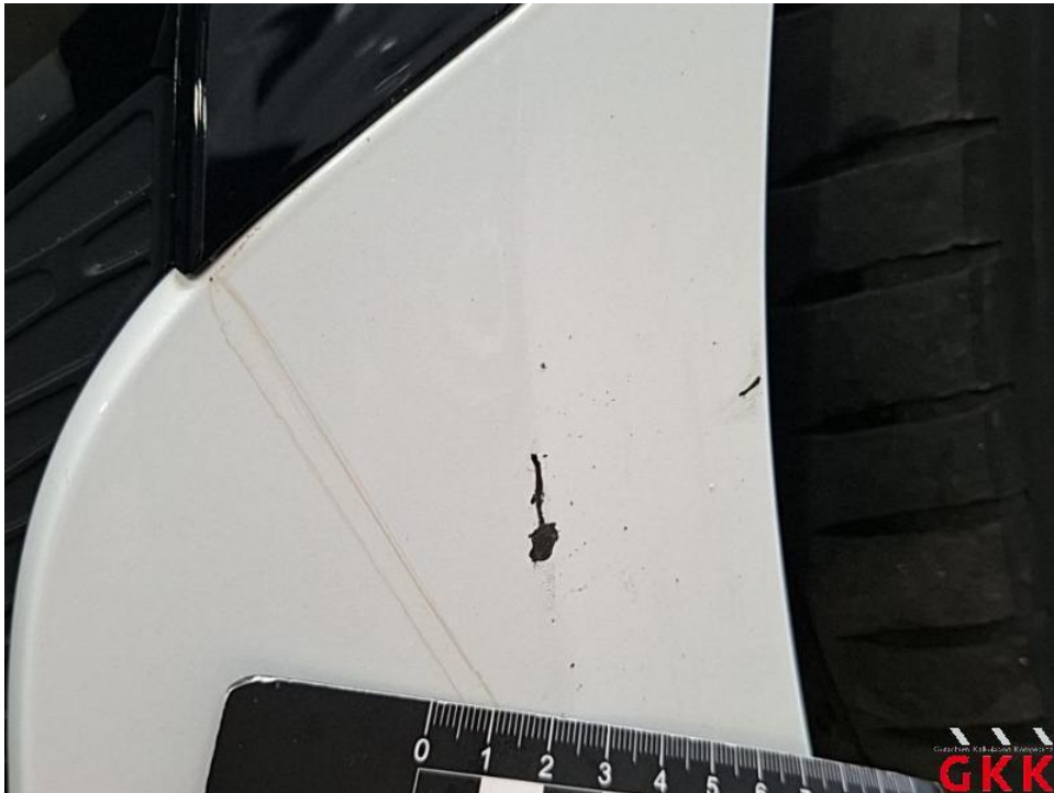
Bild 25. Stoßfänger vorne, Verkleidung -lackiert-, beschädigt, instand setzen - lackieren
