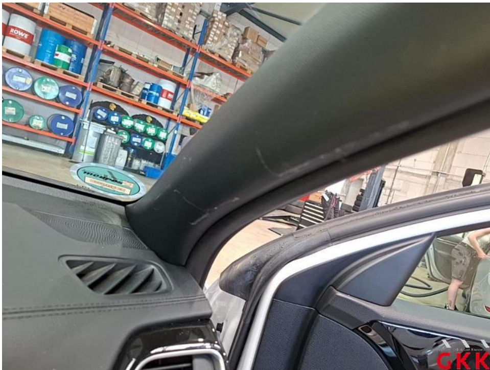
Bild 44. A- Säule rechts, Innenverkleidung, verkratzt, ersetzen
