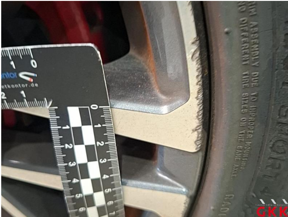
Bild 41. LM-Rad, vorne rechts, Materialabtrag, ersetzen
