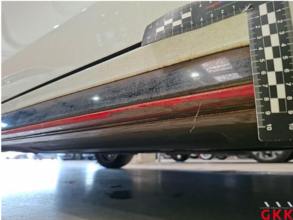
Bild 37. Schweller rechts, Verkleidung -lackiert-, beschädigt, ersetzen
