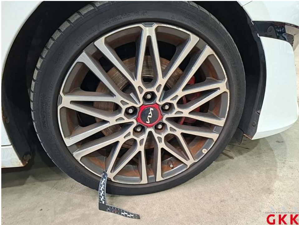
Bild 39. LM-Rad, vorne rechts, Materialabtrag, ersetzen
