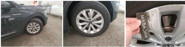
Jante alum. AVD, Déformé / Forcé, E - Remplacer
