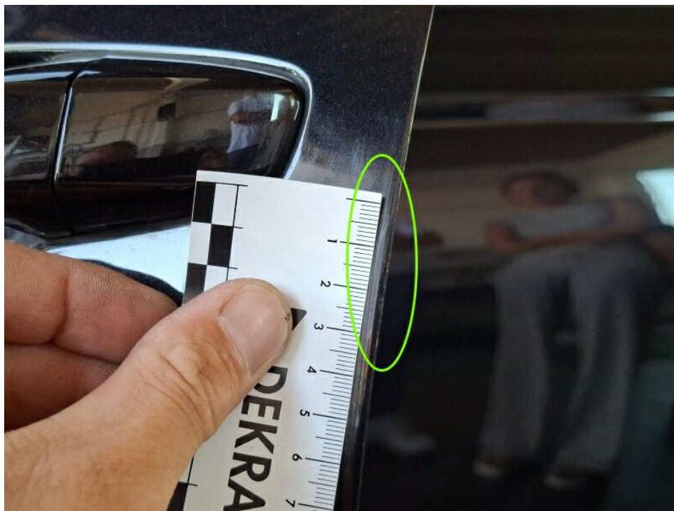
Bild 18 : Türkante Tür vorne links verschrammt
