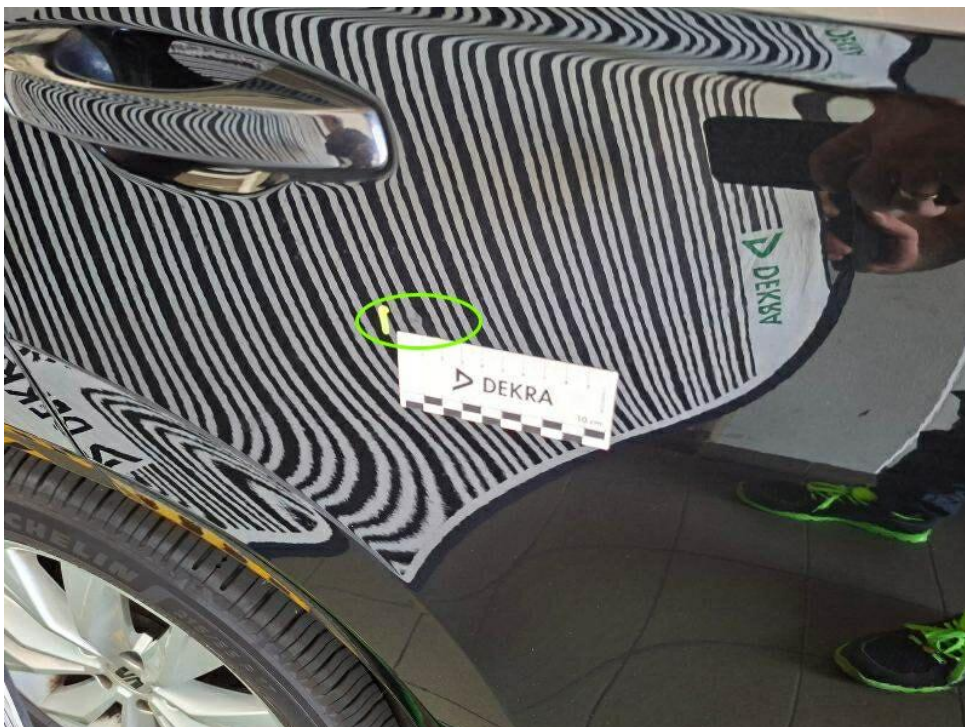
Bild 24 : Tür hinten rechts mittig punktuell eingedellt
