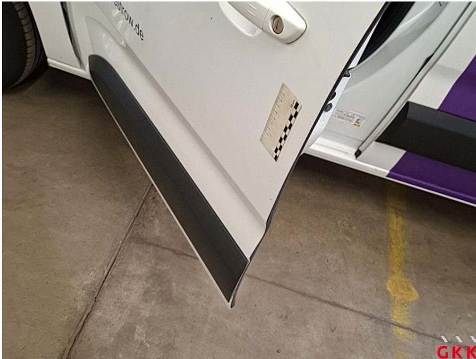
Bild 31 Tür vorne links, beschädigt, instand setzen - lackieren
