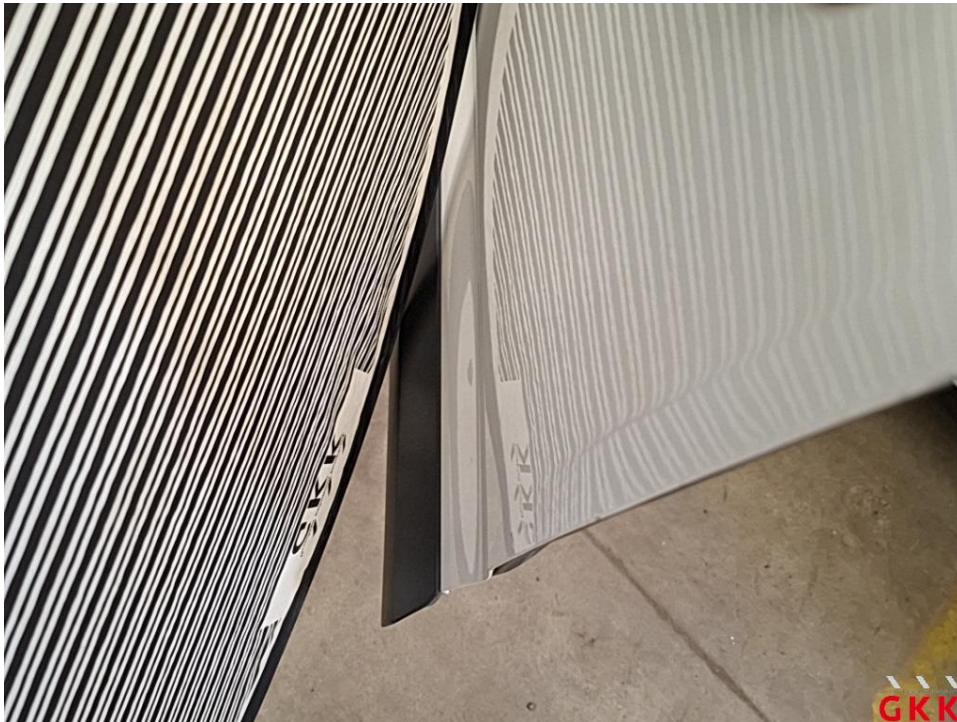
Bild 33 Tür vorne links, beschädigt, instand setzen - lackieren
