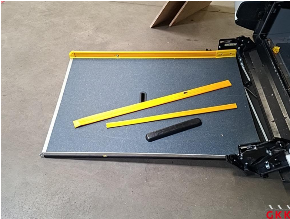
Bild 13 Leiste Rampe rechts, beschädigt, ersetzen
