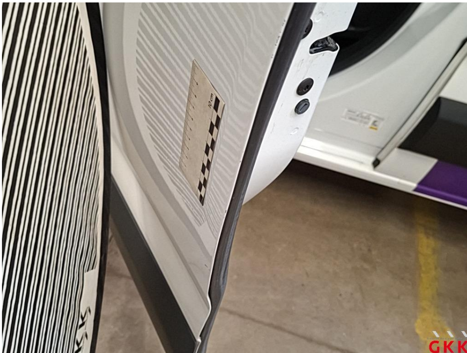
Bild 32 Tür vorne links, beschädigt, instand setzen - lackieren
