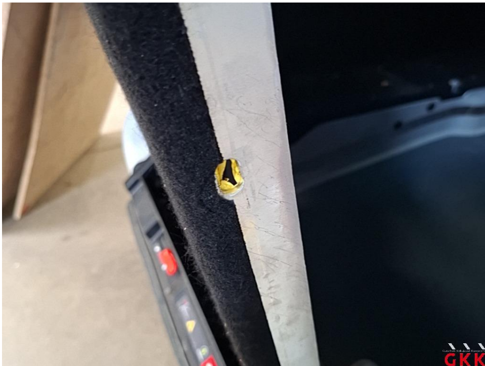
Bild 16 Stift Rampe rechts, fehlt, ersetzen
