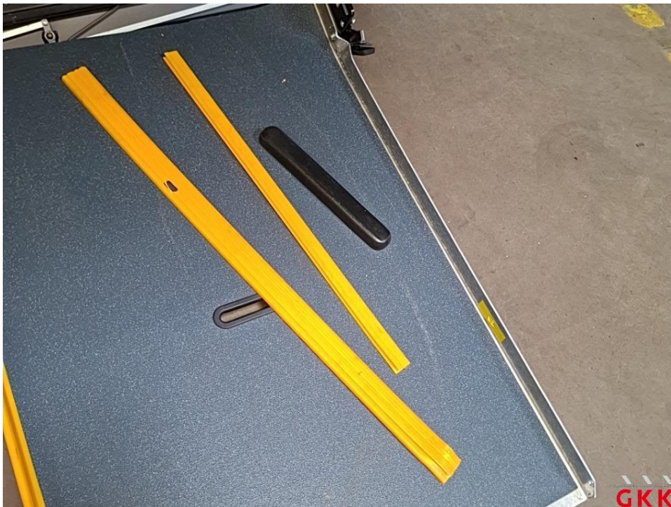
Bild 14 Leiste Rampe rechts, beschädigt, ersetzen
