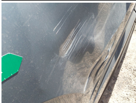
Panel de la puerta / Trasero Derecho / Abolladura
