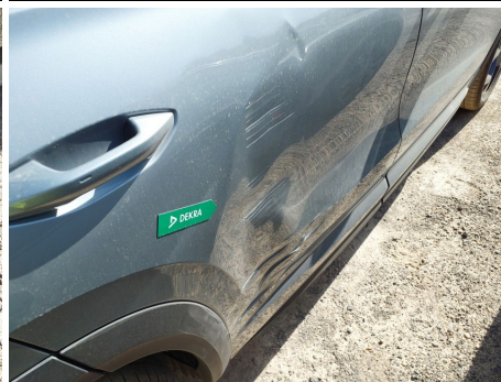
Panel de la puerta / Trasero Derecho / Abolladura
