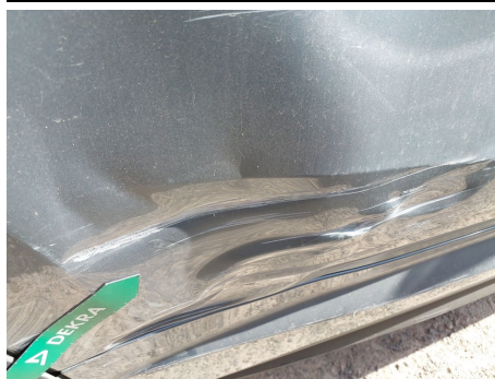
Panel de la puerta / Trasero Derecho / Abolladura
