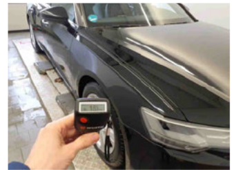
Lackstärke Kotflügel vorne rechts
