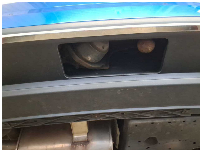
Damage 1: Trailer hitch: Trailer hitch (lässt sich nicht ausklappen) - Functional / admissibility - Perform diagnosis
