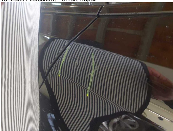
Beschädigung #5: Seitenwand links: Seitenwand - Delle(n) - sanft instandsetzen
