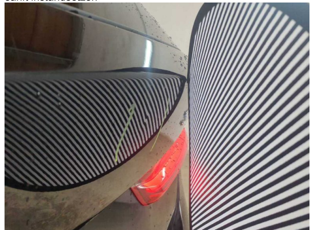
Beschädigung #2: Heckklappe/-tür: Heckklappe - Delle(n) - sanft instandsetzen
