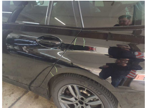
Beschädigung #5: Seitenwand links: Seitenwand - Delle(n) - sanft instandsetzen
