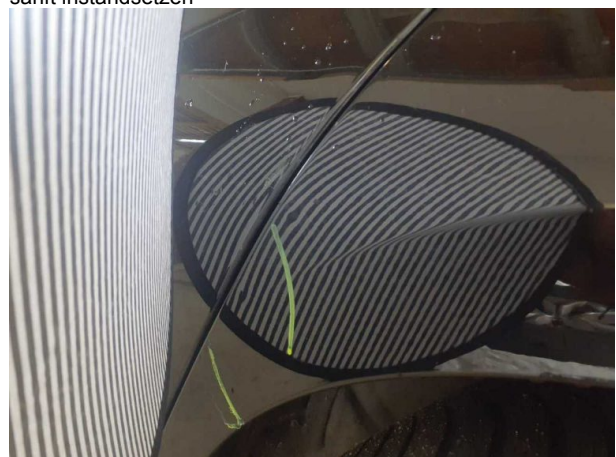
Beschädigung #5: Seitenwand links: Seitenwand - Delle(n) - sanft instandsetzen
