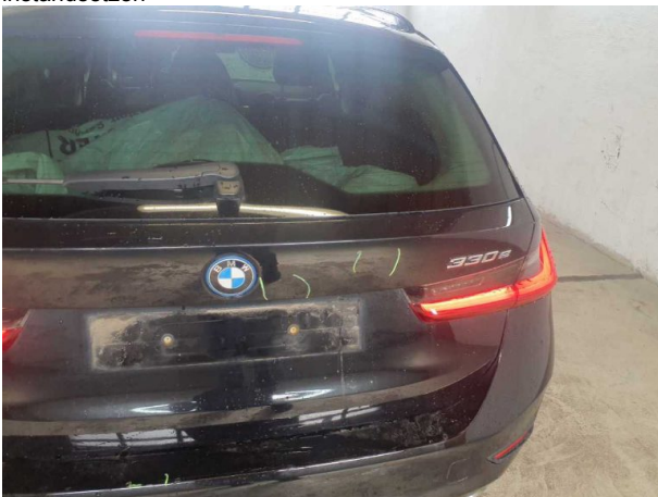
Beschädigung #2: Heckklappe/-tür: Heckklappe - Delle(n) - sanft instandsetzen
