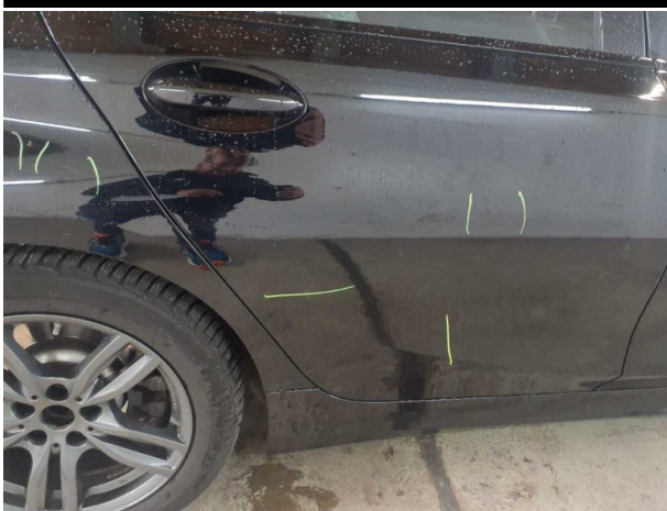
Beschädigung #6: Tür hinten rechts: Tür - Delle / Lackschaden - instandsetzen und lackieren
