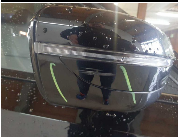
Beschädigung #3: Außenspiegel rechts: Abdeckkappe - verkratzt / verschürft - Smart Repair
