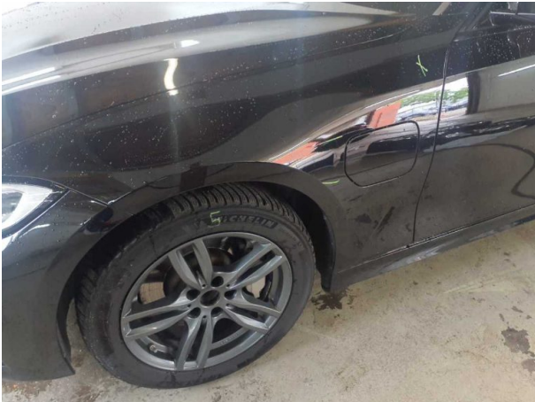
Beschädigung #1: Kotflügel links: Kotflügel links - Delle(n) - sanft instandsetzen
