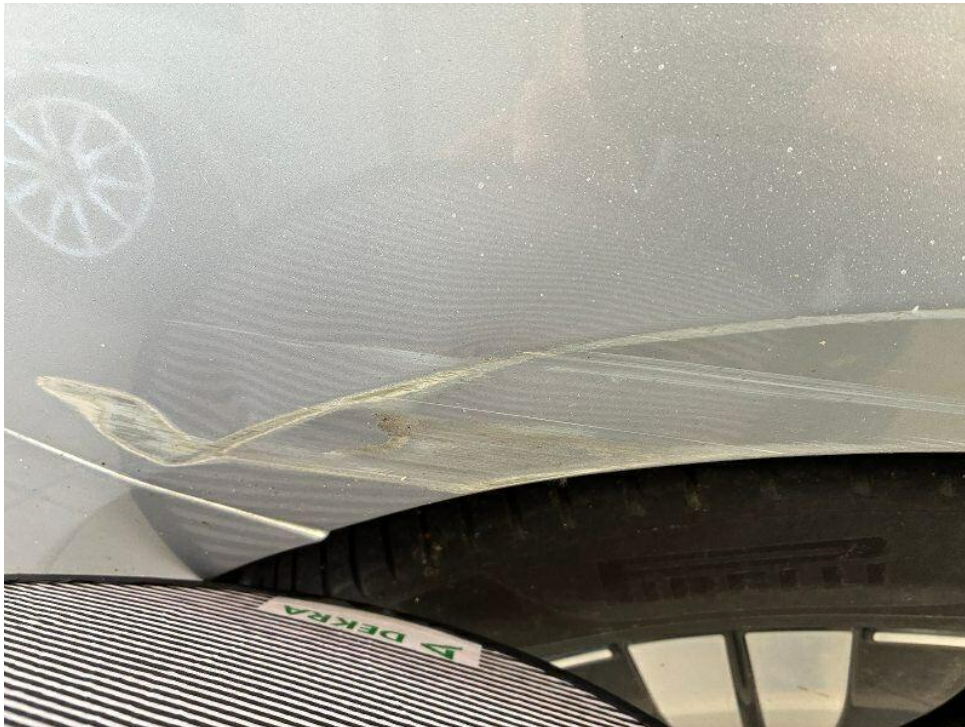
Bild 27 : Seitenschaden rechts, Stoßfänger vorne, Kotflügel, Tür hinten, Seitenwand, Alufelge, Alufelge Glanzgedreht.
