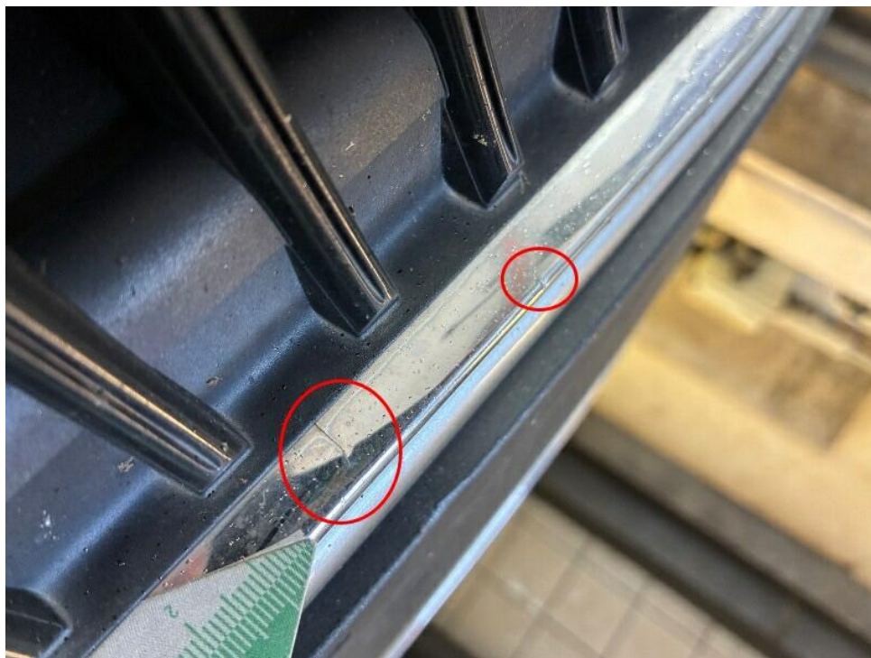
Bild 17 : Kühlergrill Chromleiste gebrochen
