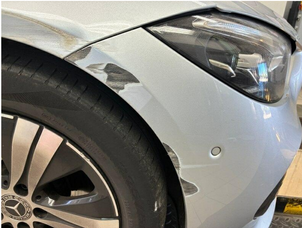
Bild 19 : Seitenschaden rechts, Stoßfänger vorne, Kotflügel, Tür hinten, Seitenwand, Alufelge, Alufelge Glanzgedreht.
