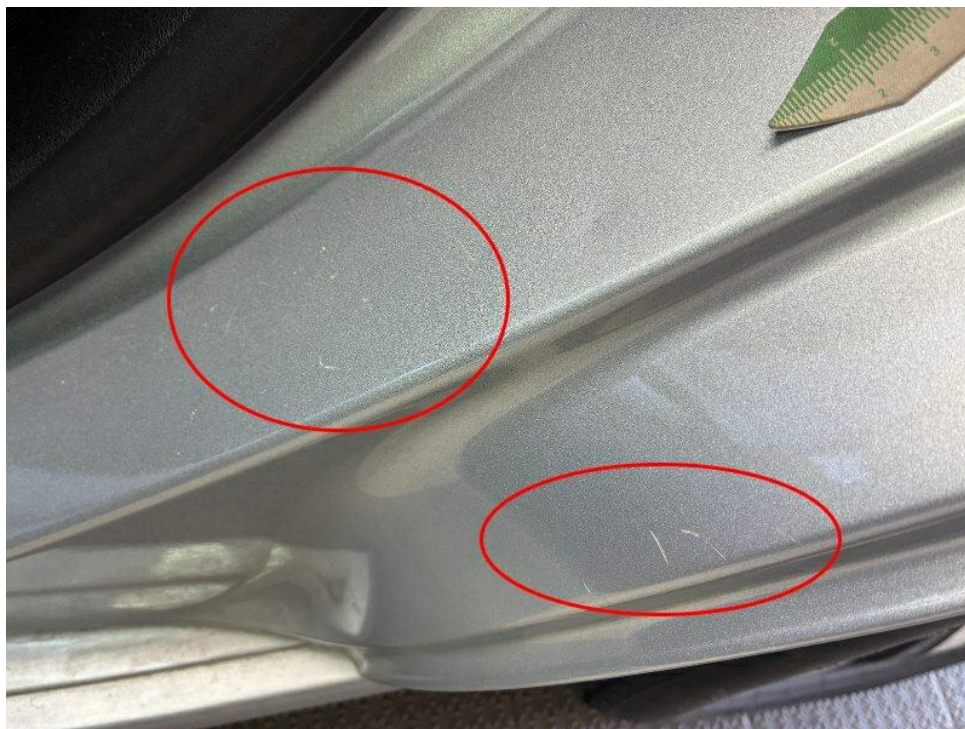
Bild 37 : Tür hinten links Einstieg, eingedellt, smart repair
