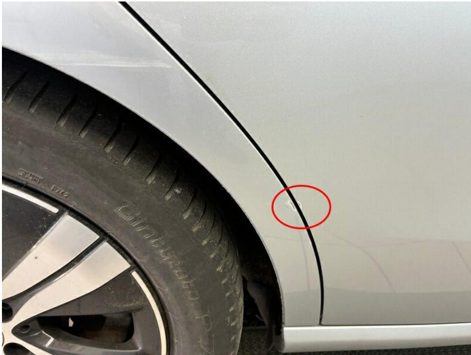
Bild 25 : Seitenschaden rechts, Stoßfänger vorne, Kotflügel, Tür hinten, Seitenwand, Alufelge, Alufelge Glanzgedreht.
