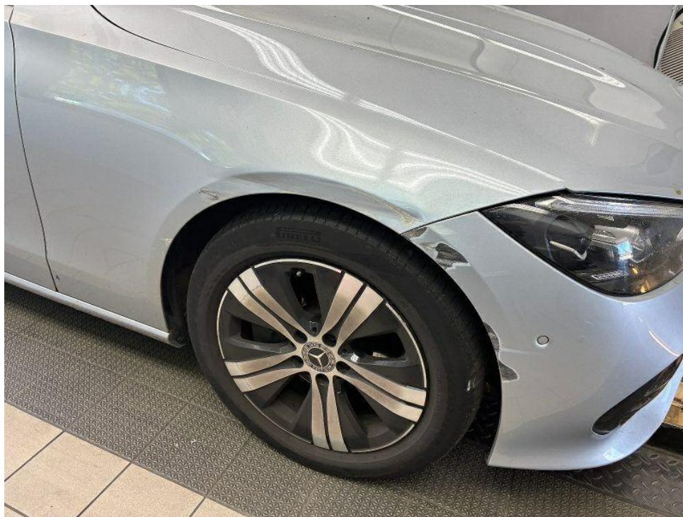
Bild 18 : Seitenschaden rechts, Stoßfänger vorne, Kotflügel, Tür hinten, Seitenwand, Alufelge, Alufelge Glanzgedreht.
