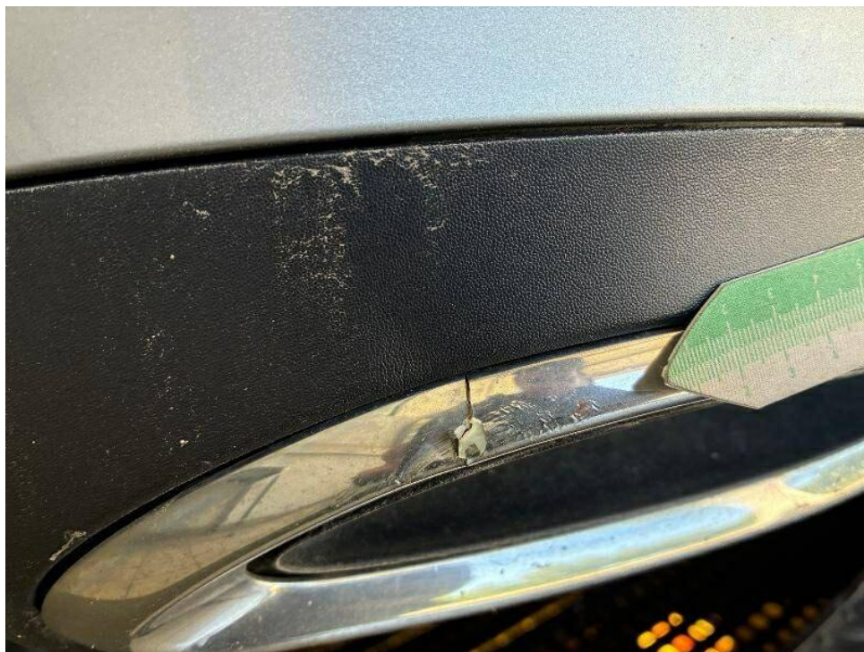
Bild 29 : Stoßfänger hinten eingedellt und verschrammt, Chromleiste gebrochen und ersetzen
