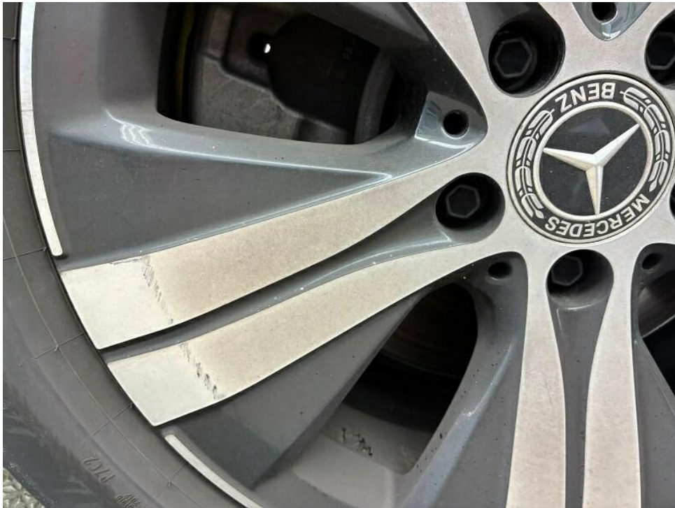
Bild 23 : Seitenschaden rechts, Stoßfänger vorne, Kotflügel, Tür hinten, Seitenwand, Alufelge, Alufelge Glanzgedreht.
