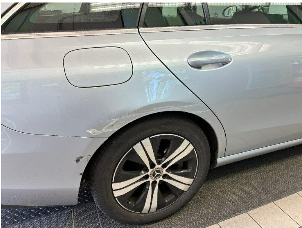
Bild 24 : Seitenschaden rechts, Stoßfänger vorne, Kotflügel, Tür hinten, Seitenwand, Alufelge, Alufelge Glanzgedreht.
