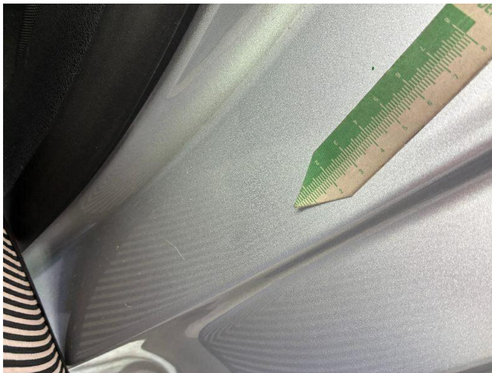
Bild 36 : Tür hinten links Einstieg, eingedellt, smart repair
