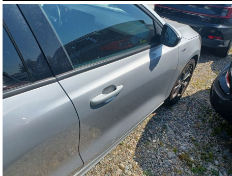
Porta / Anteriore Destro / Ammaccato vernice incisa
