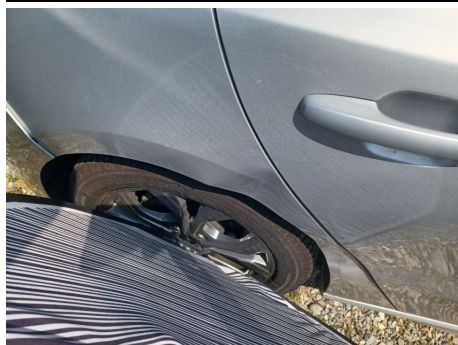
Parafango / Posteriore Destro / Ammaccato vernice incisa
