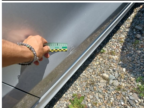
Porta / Anteriore Destro / Ammaccato vernice incisa
