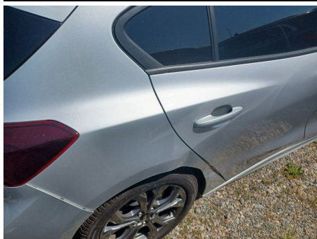
Parafango / Posteriore Destro / Ammaccato vernice incisa
