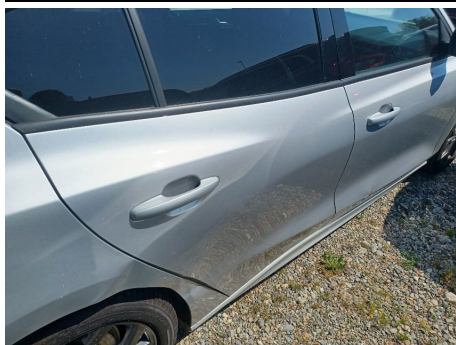
Porta / Posteriore Destro / Ammaccato vernice incisa
