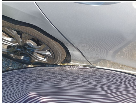
Parafango / Posteriore Destro / Ammaccato vernice incisa
