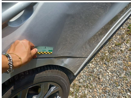
Porta / Posteriore Destro / Ammaccato vernice incisa
