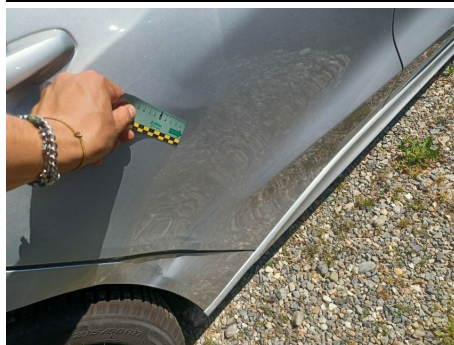
Porta / Posteriore Destro / Ammaccato vernice incisa
