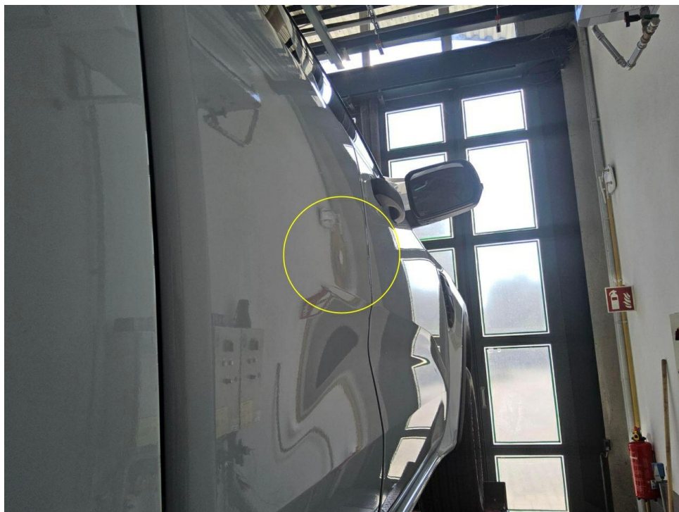
Bild 15 : Tür hinten rechts, eingedellt, drücken
